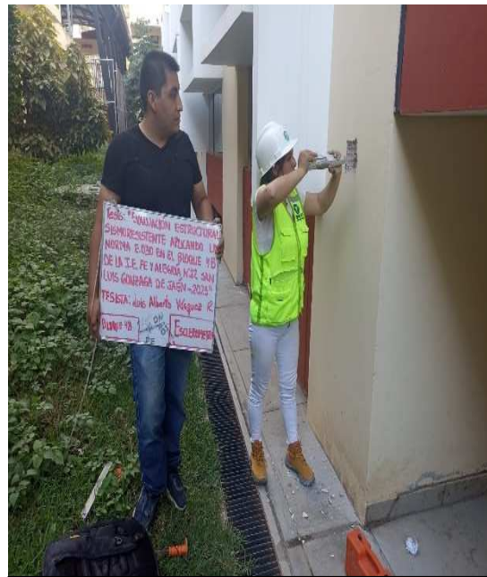
Foto 08: Ensayo de esclerometría en Columna L- N° de esclerometría E-8.
