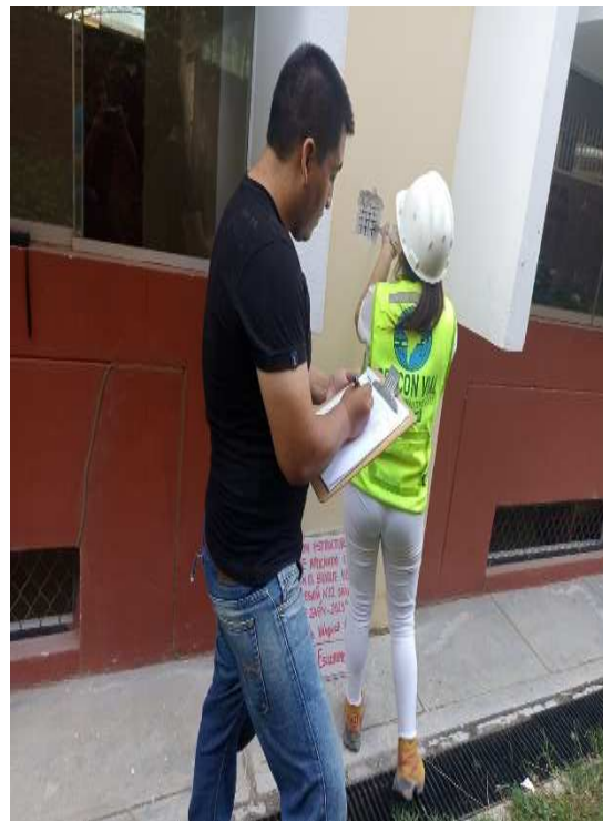
Foto 06: Ensayo de esclerometría en Columna T- N° de esclerometría E-10.
