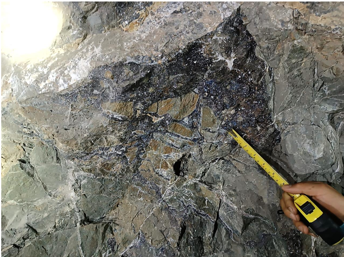
Figura 3.7. Brecha de falla ubicado en PI. + 100 m., presenta: composición mineralógica de covelina, pirita y calcopirita, una matriz cementante de sílice y también se puede observar vetillas de yeso.
