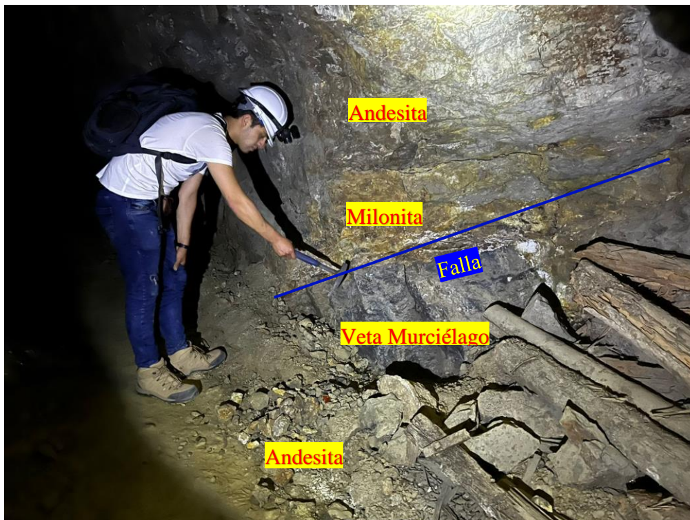
Figura 3.13. Falla sinistral con orientación: Az = 250^\circ , Bz = 31^\circ NW , desplazó a la Veta Murciélagos al hastial izquierdo de la galería, con un salto de falla de 1.20 m. La falla sinistral está delimitada por milonita de color: Amarillo a anaranjado, presenta espesor de 0.30 m a 0.35 m., ubicado en el PI. + 475.15 m.
