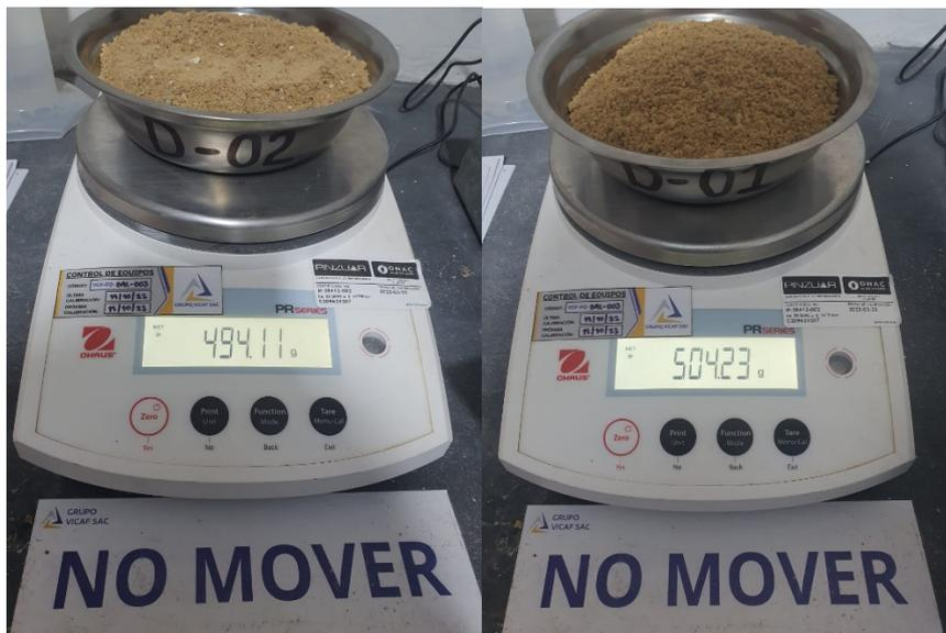
**Imagen 5.** Ensayo de contenido de humedad
