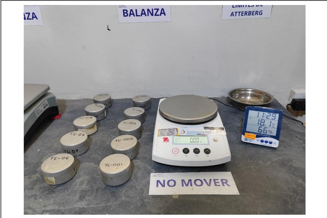
**Imagen 7.** Ensayo de limite líquido y limite plástico
