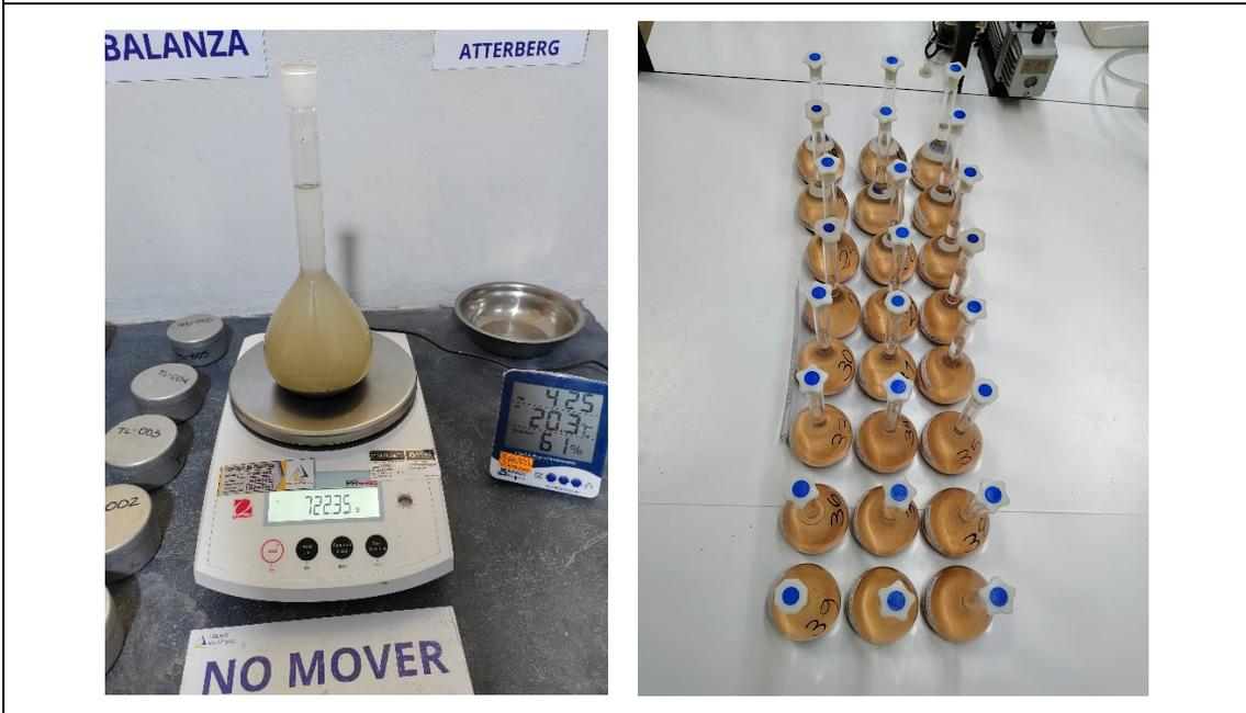
**Imagen 8.** Ensayo de gravedad específica de solidos
