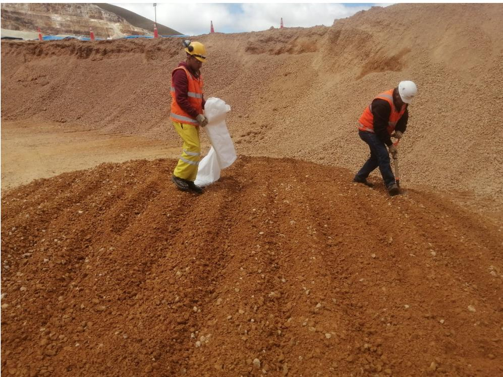
**Imagen 2.** Obtención de las muestras de suelo en la cantera
