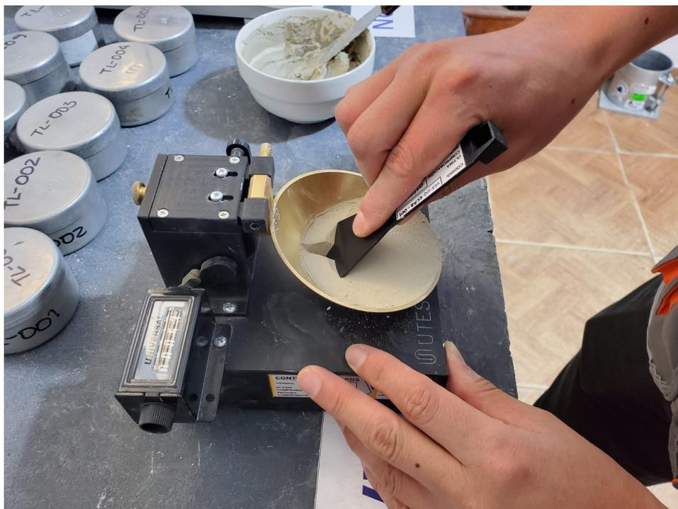
**Imagen 6.** Ensayo de limite liquido
