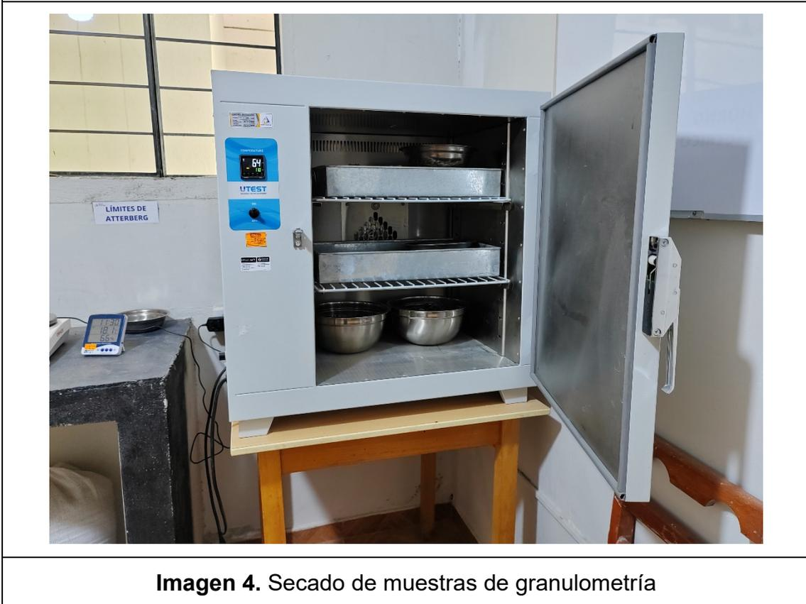
**Imagen 4. Secado de muestras de granulometría**
