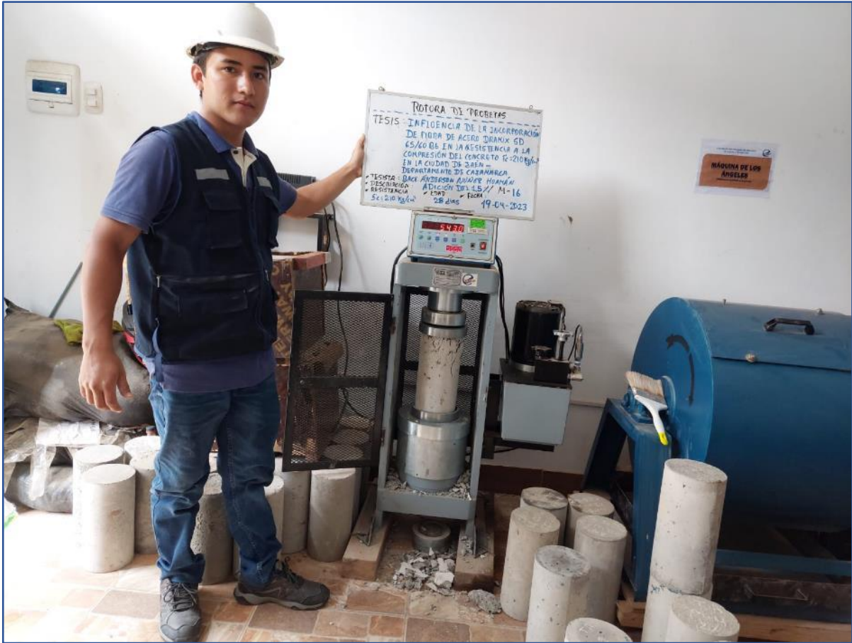
Figura N°34. Rotura de testigos a la edad de 28 días.
