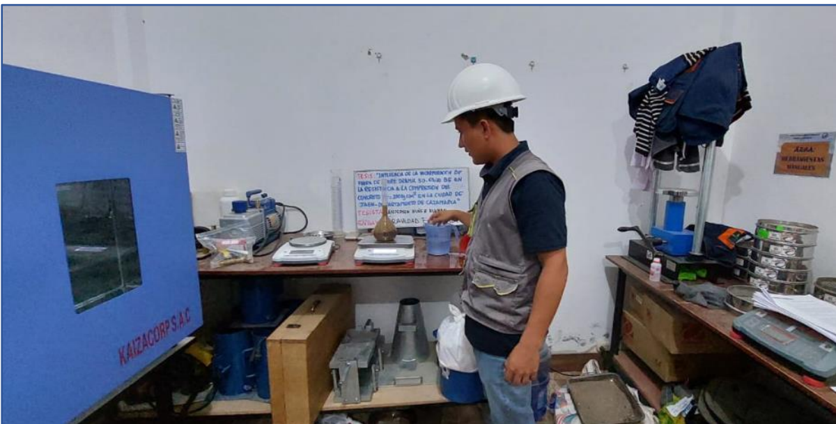
Figura N°27. Realización del peso específico y absorción del agregado fino
