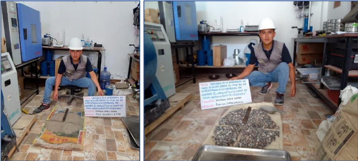
Figura N°22. Procedimiento de cuarteo para la selección de muestras de los agregados
