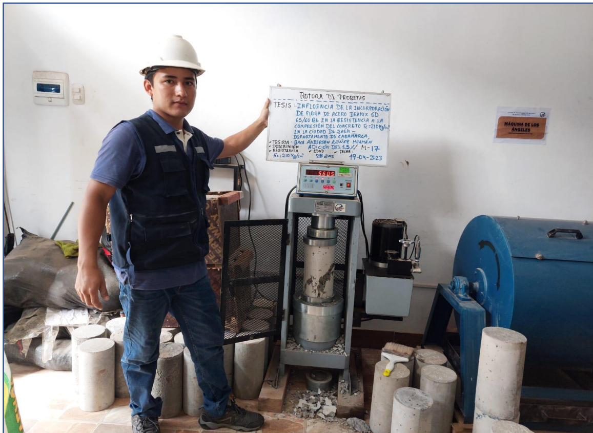
Figura N°33. Rotura de testigos de concreto con adición de fibra de acero
