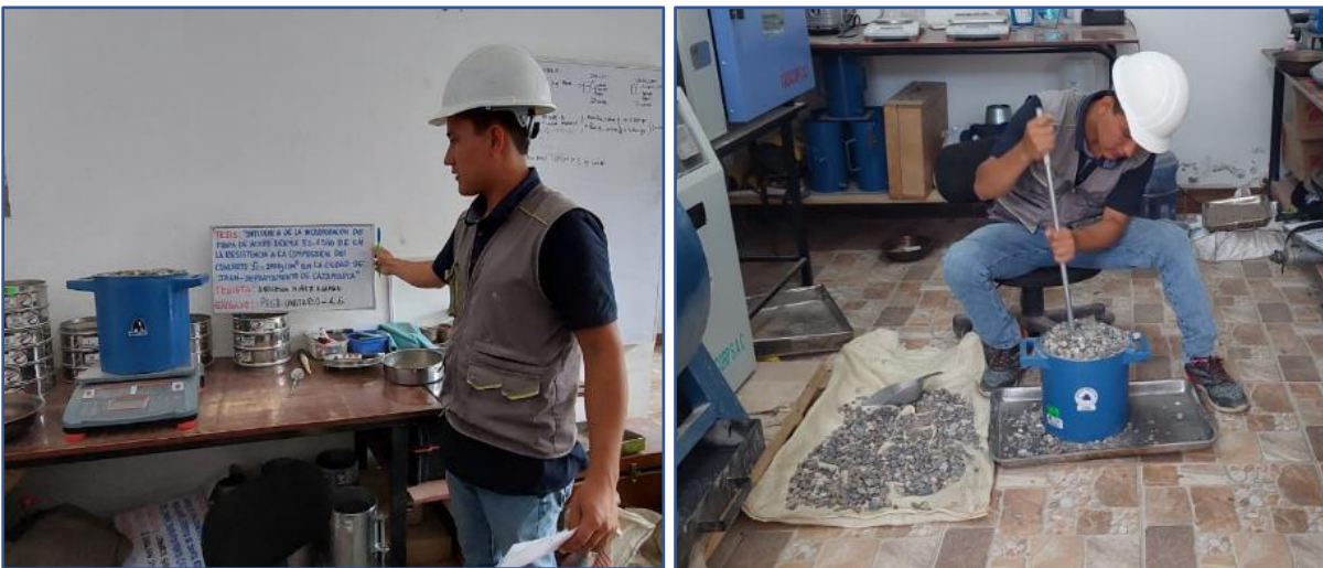
Figura N°26. Ejecución del peso unitario varillado
