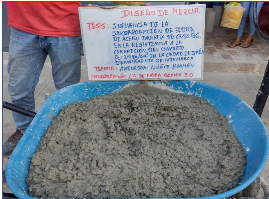
Figura N°30. Elaboracion de concreto con incorporacion de fibra de acero al 1%
