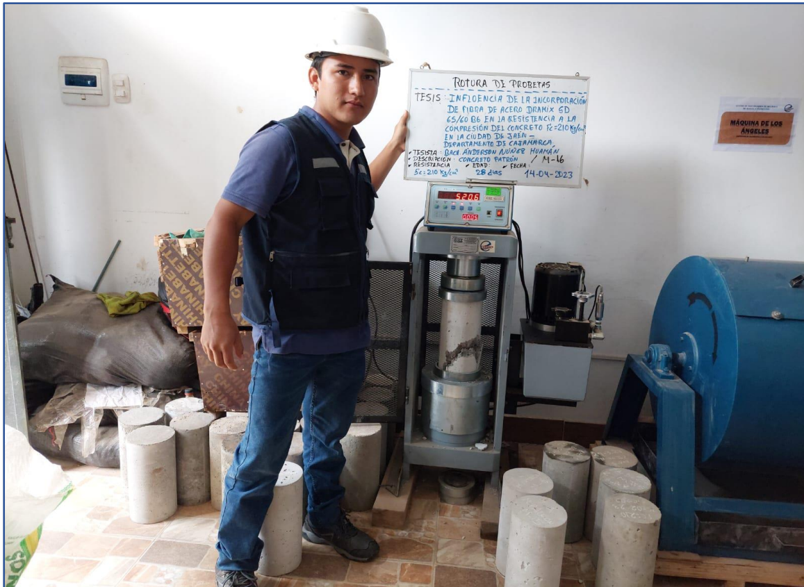
Figura N°32. Rotura de testigos de concreto patrón f'c=210 \text{ kg/cm}^2
