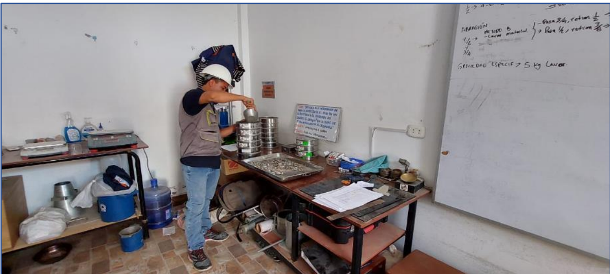
Figura N°23. Ejecución de los ensayos de granulometría de los agregados
