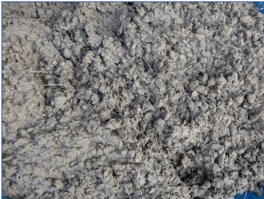
Figura N°31. Concreto con incorporación de fibra de acero Dramix
