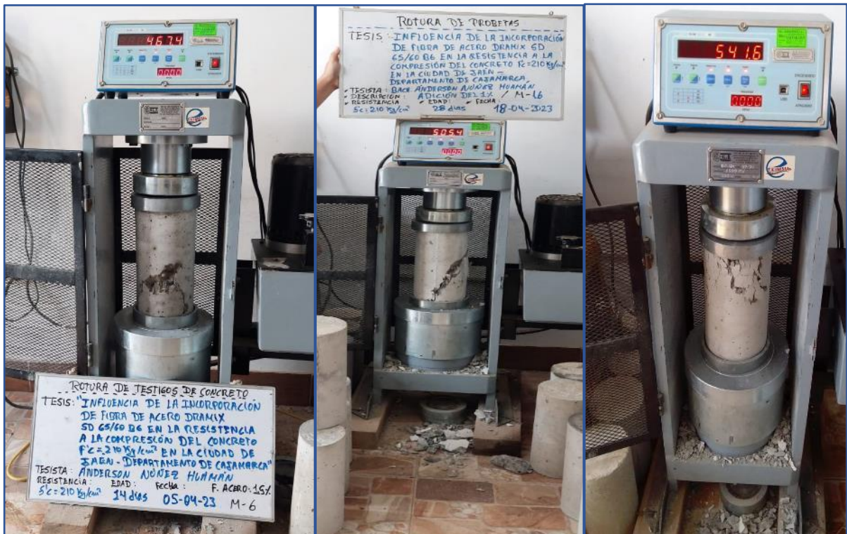
Figura N°35. Fallas típicas en los especímenes ensayados
