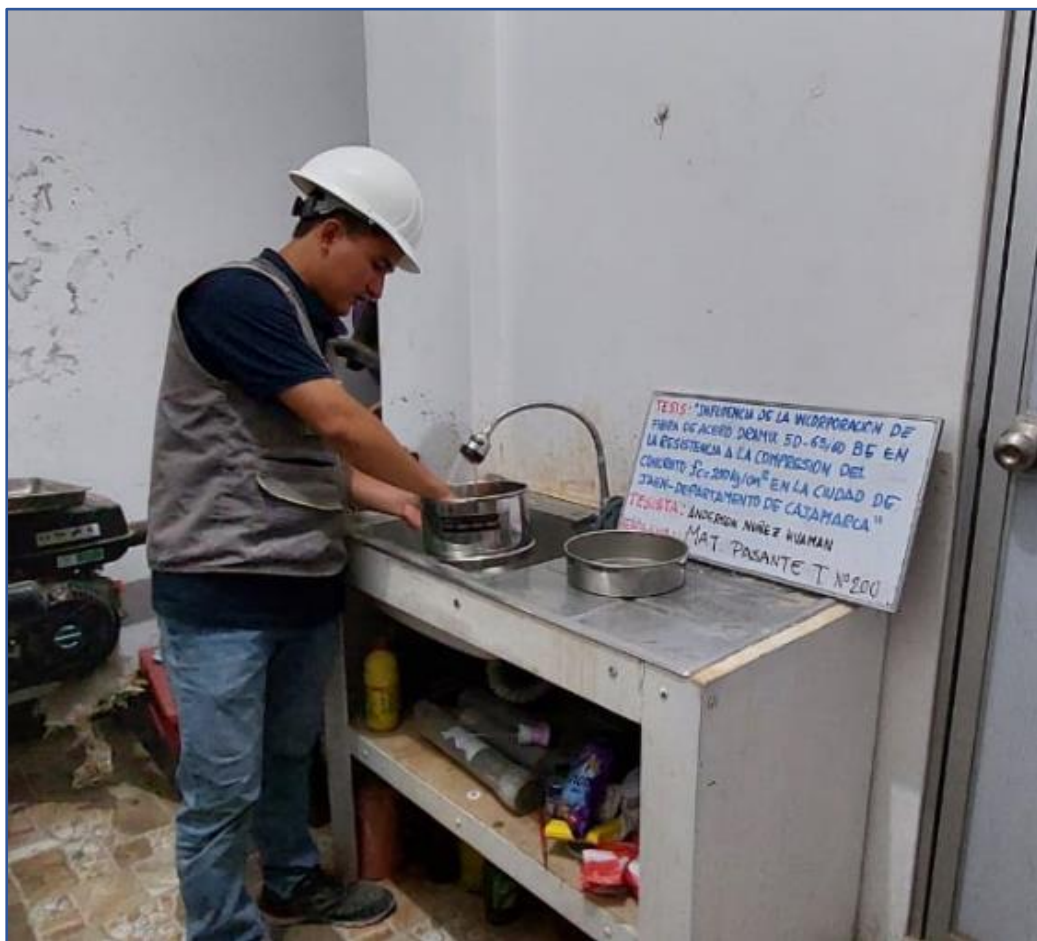
Figura N°29. Realización de lavado por tamiz normalizado N°200
