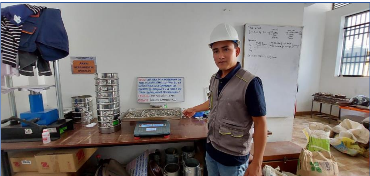
Figura N°24. Pesaje de la muestra de agregado grueso para ensayo de granulometría
