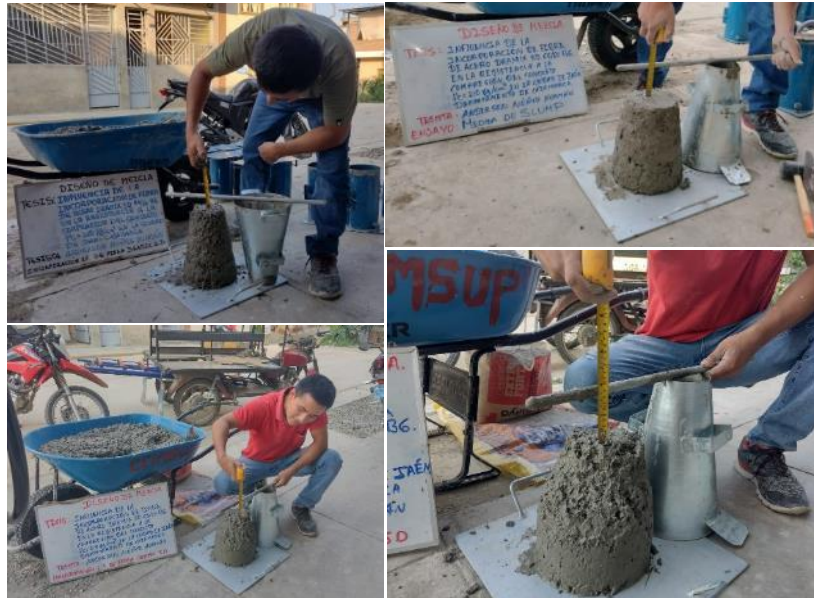
Figura N°7. Medida del revenimiento o Slump
