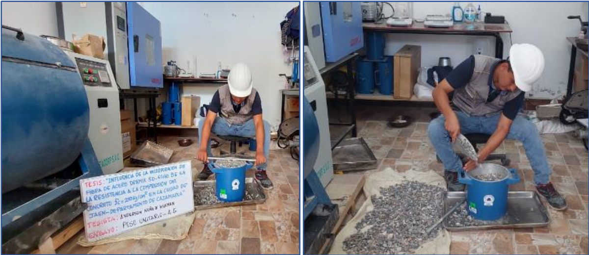
Figura N°25. Realización del peso unitario suelto
