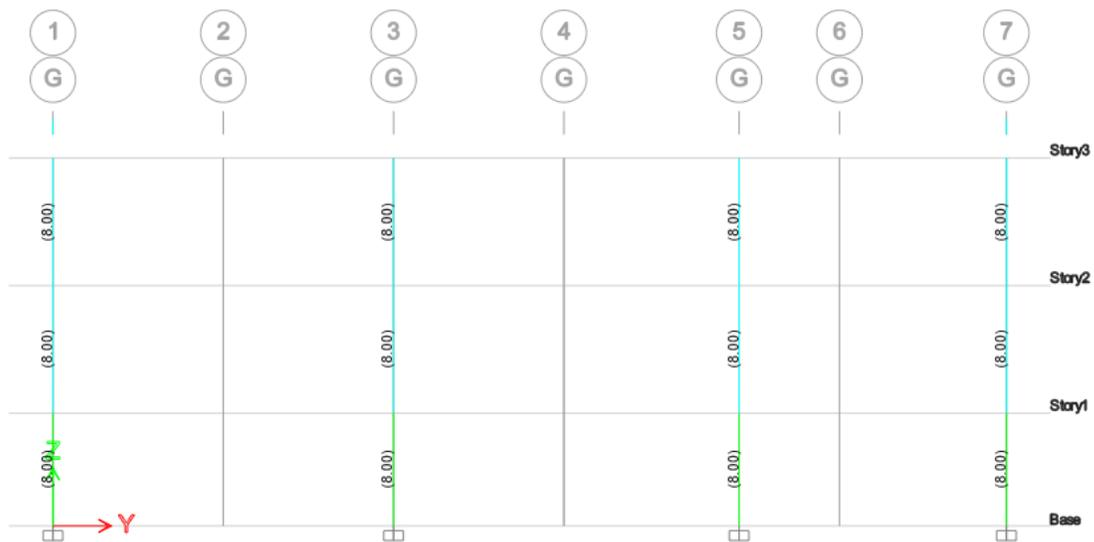
**Figura 49** Cuantía mínima de acero de columnas y vigas en el eje H-H del 1 al 7 en plano de perfil donde no cumple con el diseño estructural.
