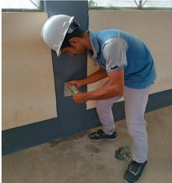
**Figura 19** Realización del ensayo de esclerometría en la viga peraltada de (30x40) punto 1
