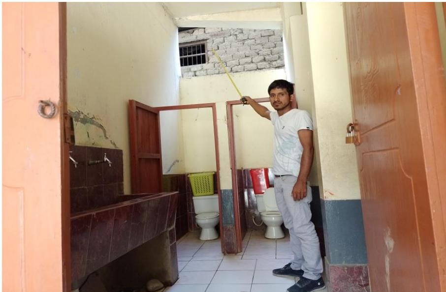
**Figura 18** Realización del ensayo de esclerómetro en la columna C-1 de (30x30) punto 1
