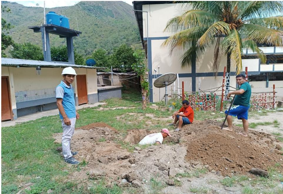
**Figura 24** Calicata de 3 m de profundidad lista para sacar las muestras de los tres estratos
