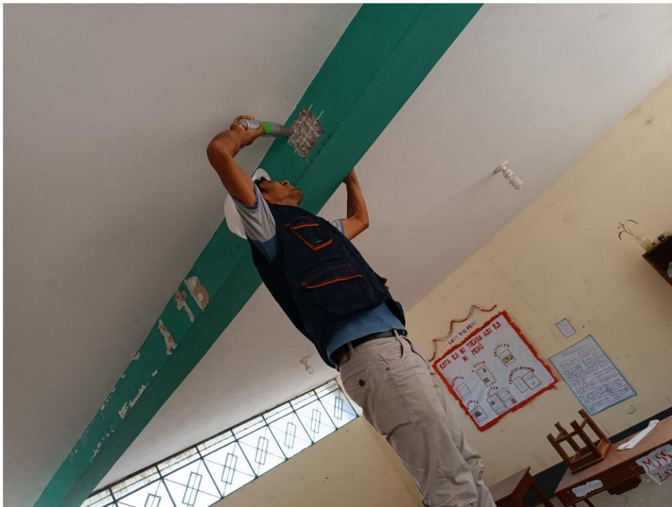
**Figura 20** Realización del ensayo de esclerómetro en la columna C-2 de (30x40) punto 3
