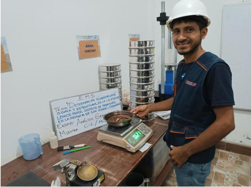
**Figura 29** *Realización del ensayo de plasticidad con el método de Casa grande*
