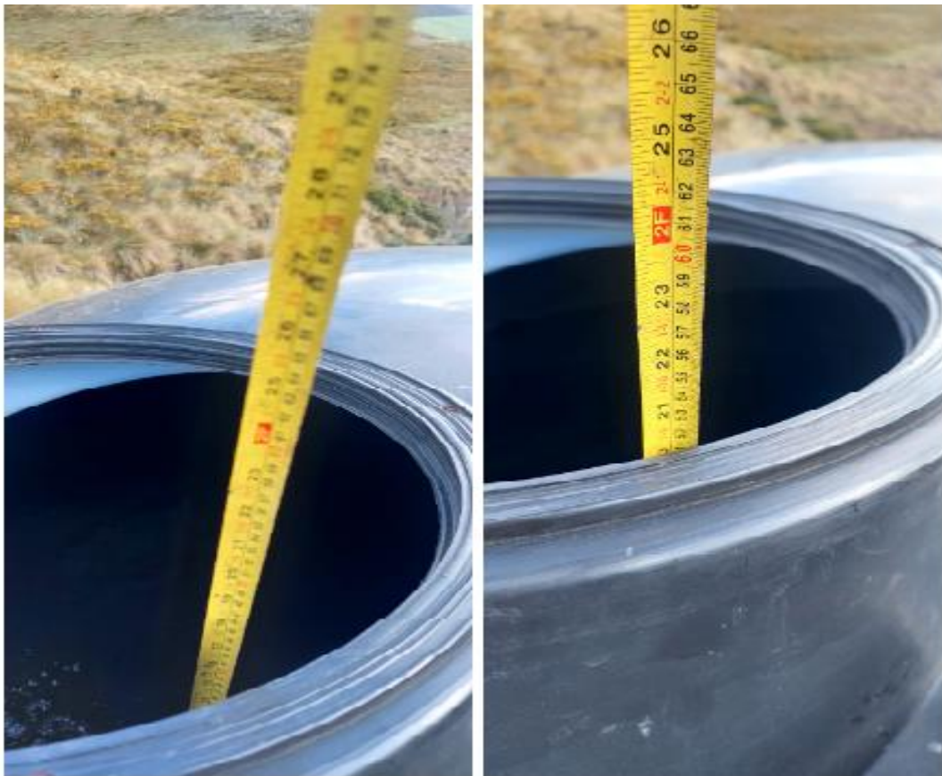
Foto 08: Medición de alturas cada hora en reservorio de 10 mil litros.
