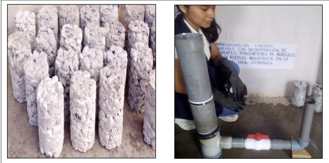
FOTOS 1: Ensayo de permeabilidad de las mezclas estudiadas.
