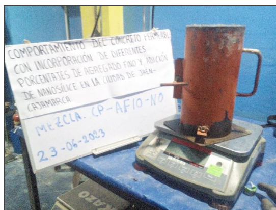
Figura 16: Medición y pesado de molde más muestra.
