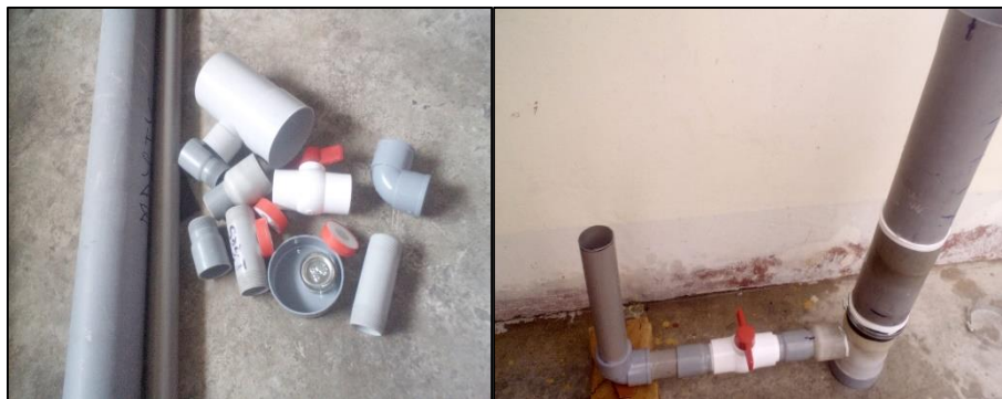
Figura 21: Elaboración del permeámetro para el ensayo.
