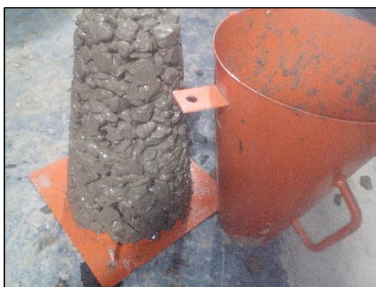
Figura 15: Ensayo de Asentamiento (slump).
