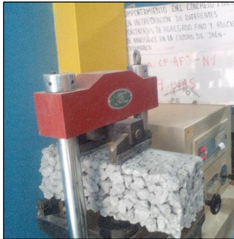
Figura 20 Ensayo de Resistencia a la flexión.
