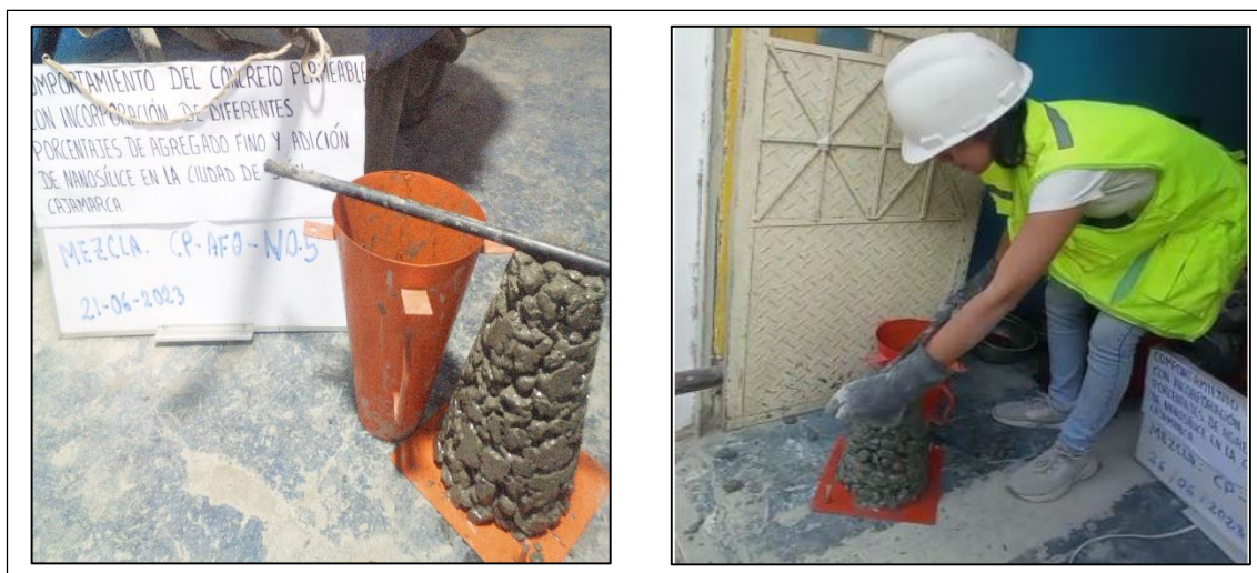
FOTO 3: Ensayo de asentamiento de las mezclas estudiadas.
