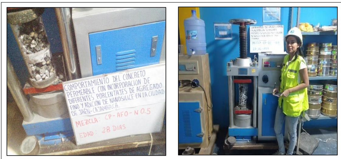
FOTO 5: Ensayo de resistencia a compresión, de las diferentes mezclas estudiadas.
