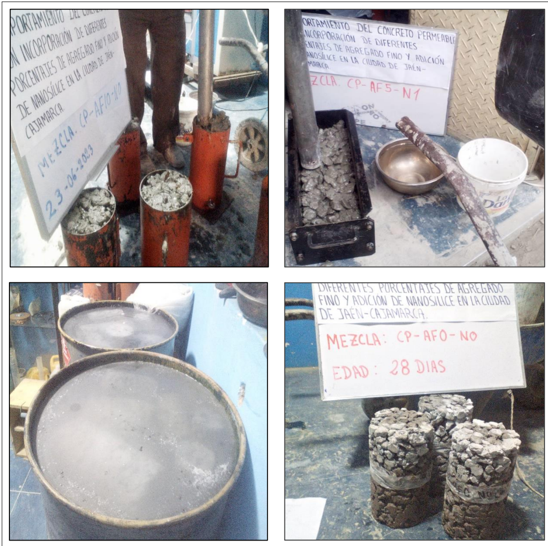
FOTOS 4: Elaboración de probetas y vigas.
