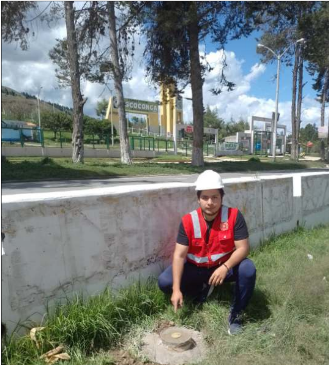
Fotografía N° 01: Monumentación de Puntos Geodésicos Punto "CIJ – A" de Orden C
