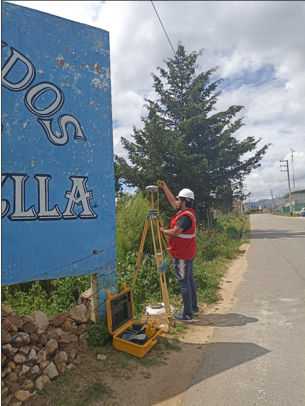
Figura 11: Ensamblaje del equipo GPS Diferencial Trimble R8S en placa geodésica punto B
