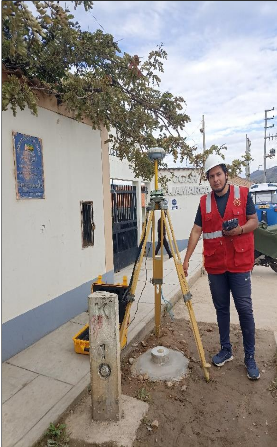
Figura 14: Registro de datos con GPS Diferencial punto C en la altura del tramo Km 10+020
