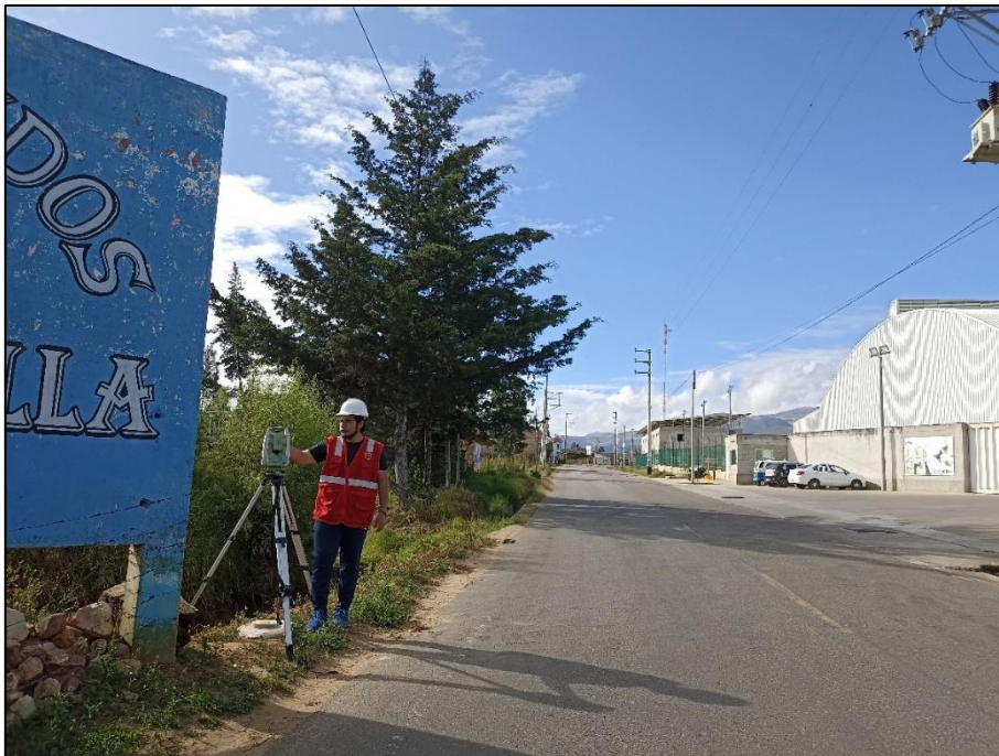
Figura 20: Ubicación del punto base en el punto geodésico B
