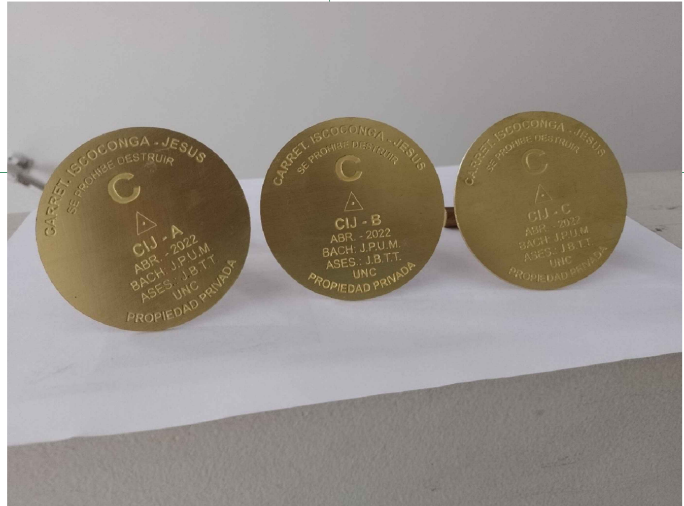
PLACAS GEODÉSICAS PARA PUNTOS DE ORDEN C
