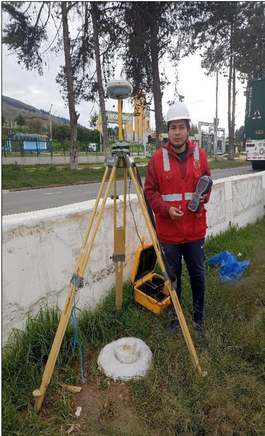
Figura 10: Registro de datos con GPS Diferencial punto A en la altura del Tramo Km 0+018
