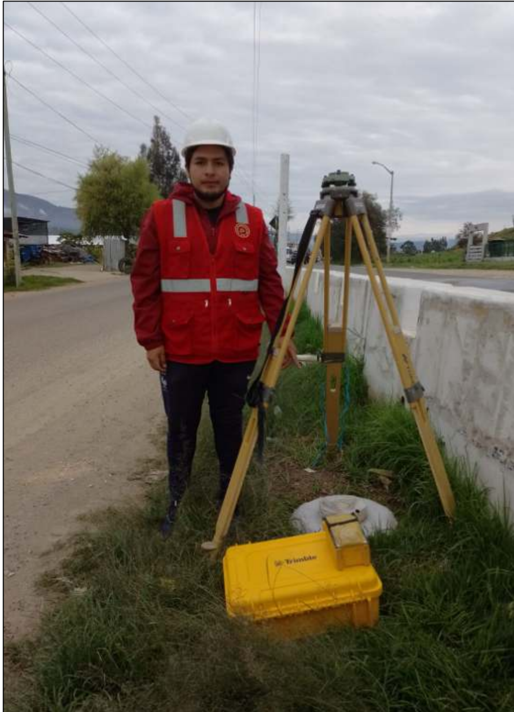
Fotografía N° 03: Lectura y posicionamiento de Punto Geodésico "CIJ - A"
