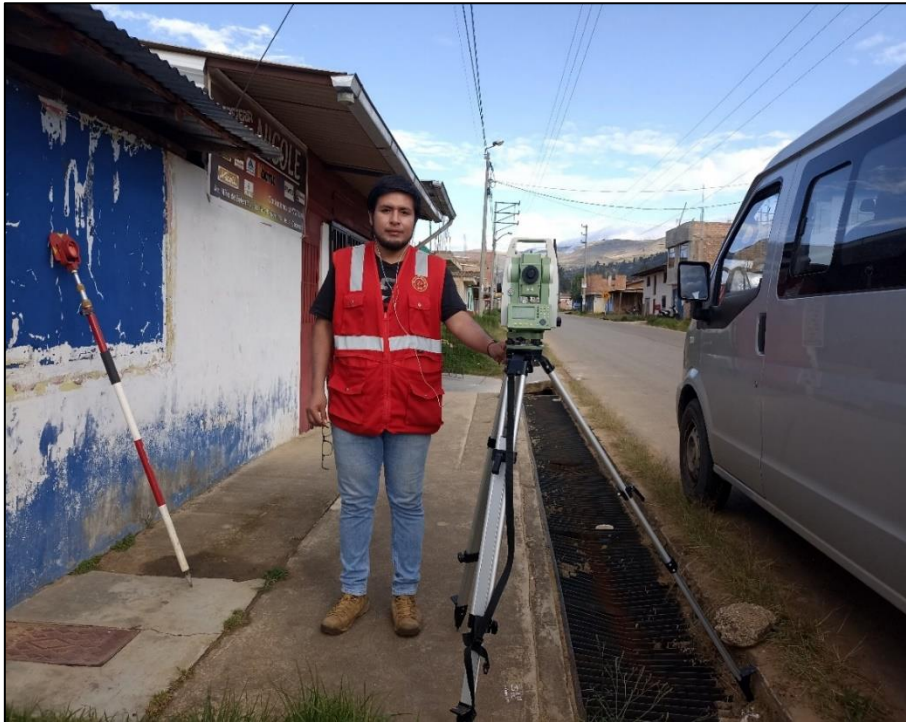
Figura 21: Levantamiento topográfico en carretera Iscocongá – Jesús km 5+420
