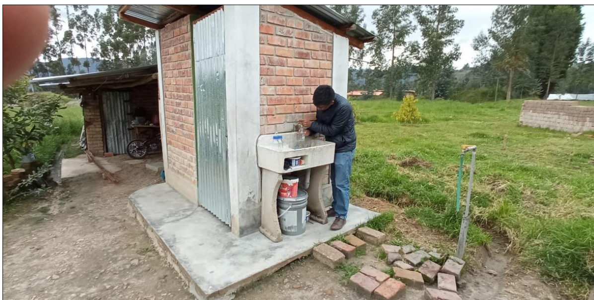
Figura 19: Realizando el muestro de agua del grifo más alejado del sistema para ser llevado a analizarlo en el laboratorio.
