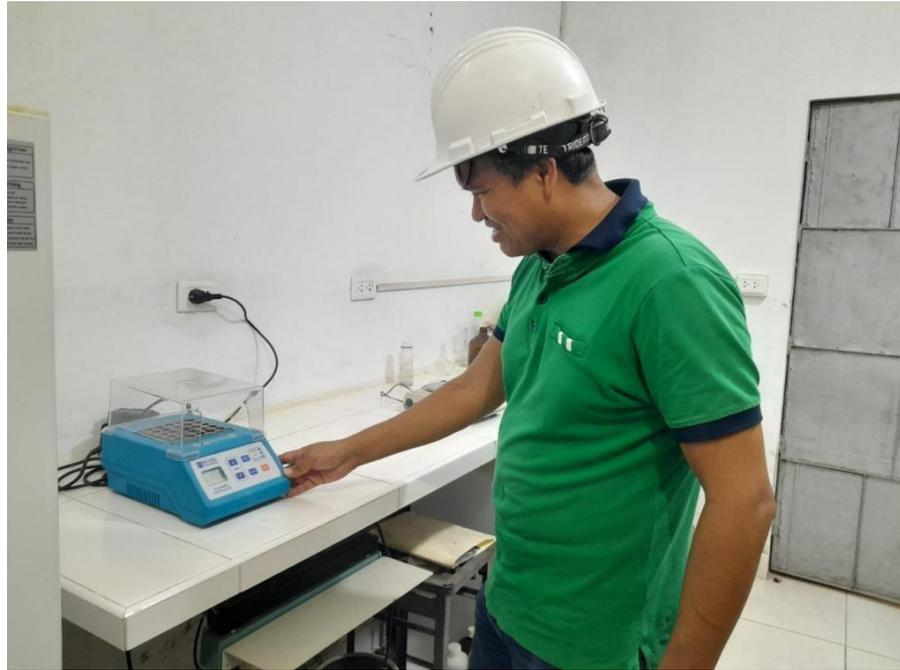
**FOTO N° 11: Medición de oxígeno disuelto para DBO5**
