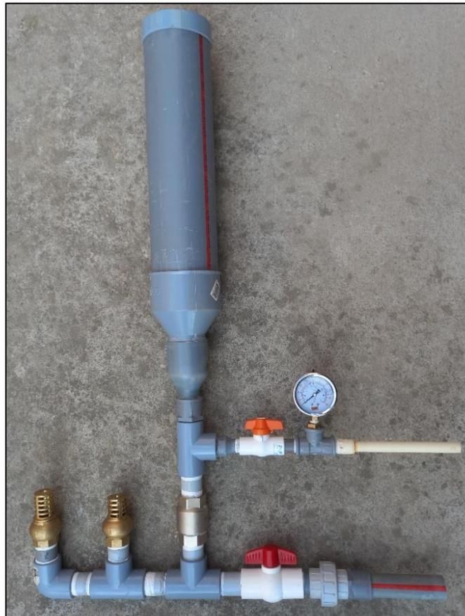
**Figura D. 4. BAH con tres válvulas de pie.**
