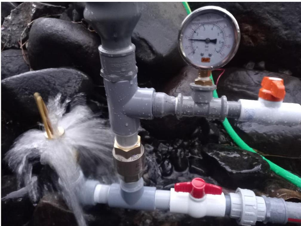
**Figura D. 7. BAH con dos válvulas de pie.**
