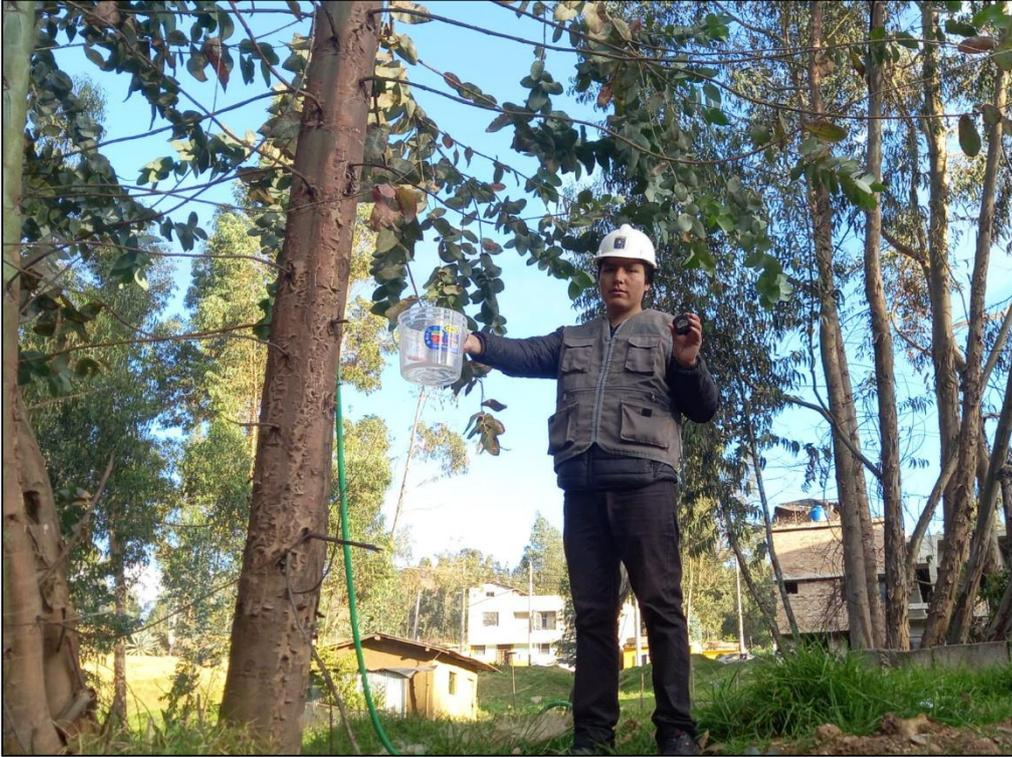
**Figura D. 12. Ensayos para el caudal de suministro ( $Q$ )**
