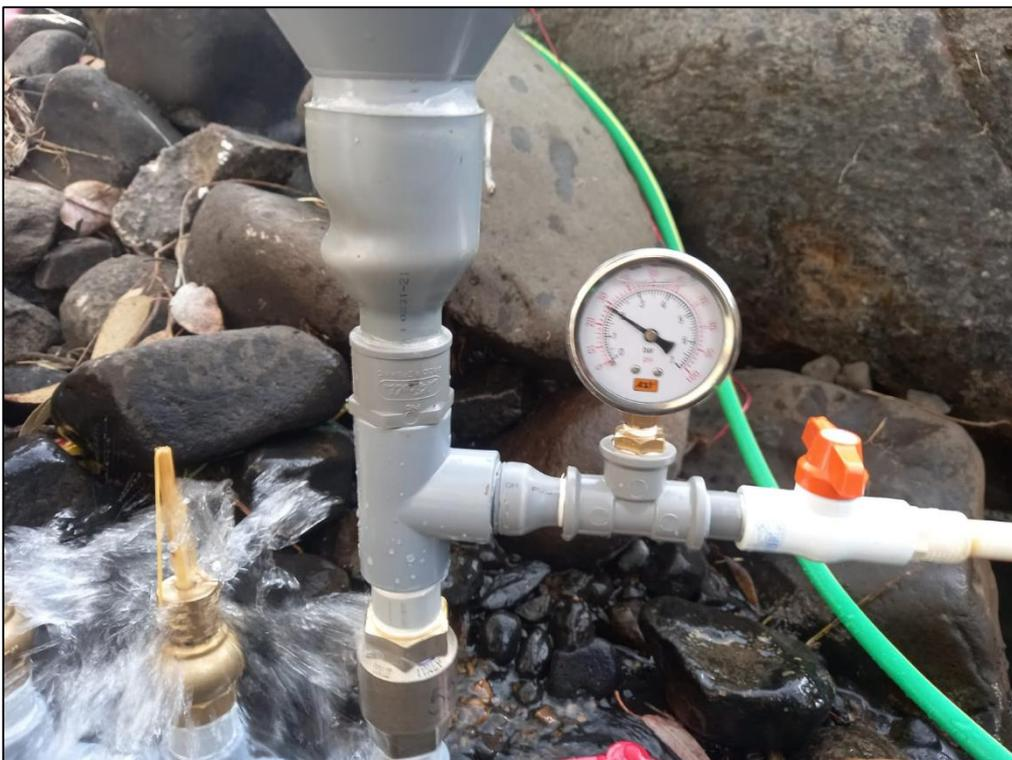
**Figura D. 11. Ensayos para el caudal de entrega ( $q$ )**
