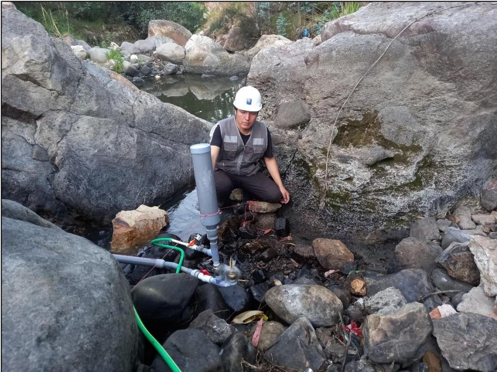
**Figura D. 6. Presión máxima de la BAH con una válvula de pie.**
