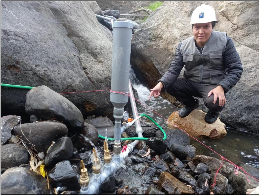
**Figura D. 10. Presión máxima de la BAH con tres válvulas de pie.**
