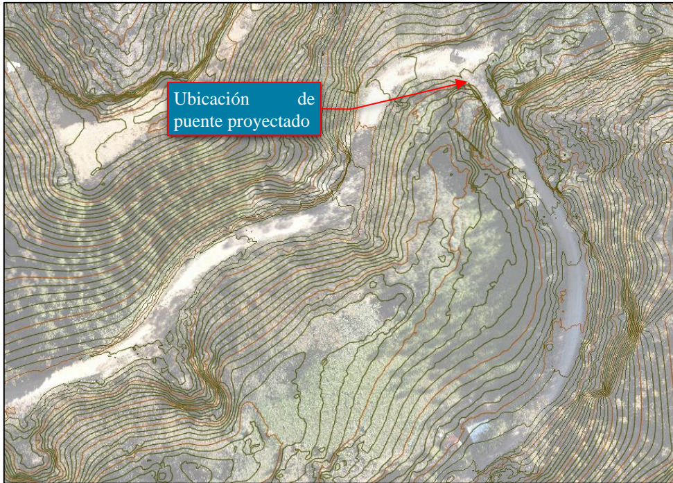
Figura 22: Superficie topográfica obtenida a partir de la nube de puntos (levantamiento de condiciones existentes).
