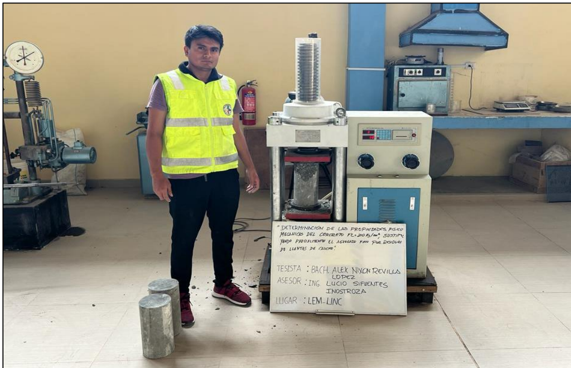
Figura 39: Ensayo a compresión de probetas de concreto f'c=210 \text{ kg/cm}^2
