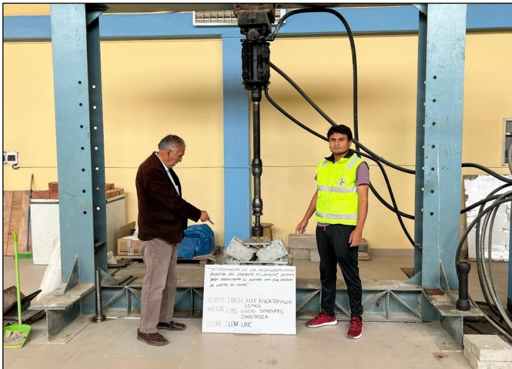
Figura 42: Rotura de probeta tipo viga, ensayo a flexión de concreto f'c=210 \text{ kg/cm}^2
