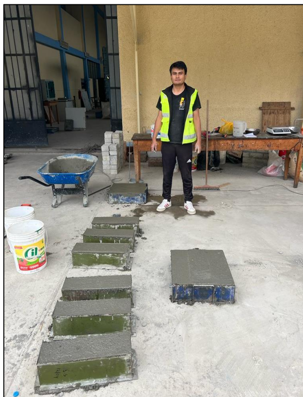
Figura 36: Fabricación de probetas de concreto f'c=210 \text{ kg/cm}^2
