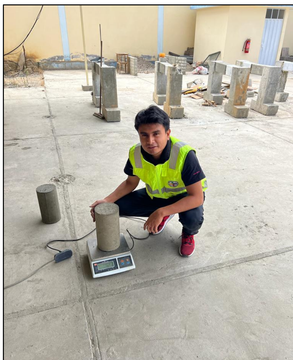
Figura 38: Peso de probetas para cálculo de peso unitario del concreto
