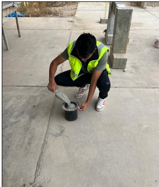
Figura 36: Fabricación de probetas de concreto f'c=210 \text{ kg/cm}^2
