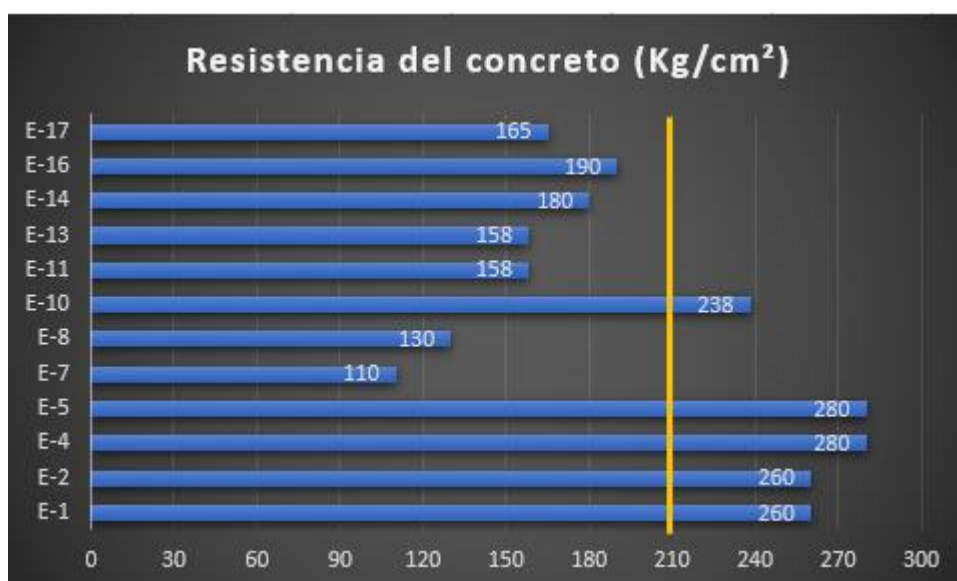
Figura 10 Resistencia del concreto en columnas respecto a 210 kg/cm 2
