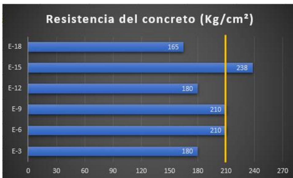
Figura 11 Resistencia del concreto en vigas respecto a 210 kg/cm 2
