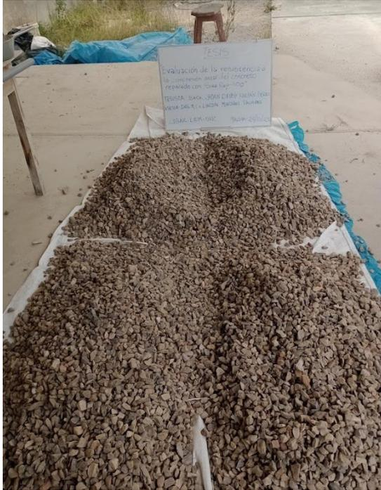
**Figura 26.** Cuarteo de agregado fino.
