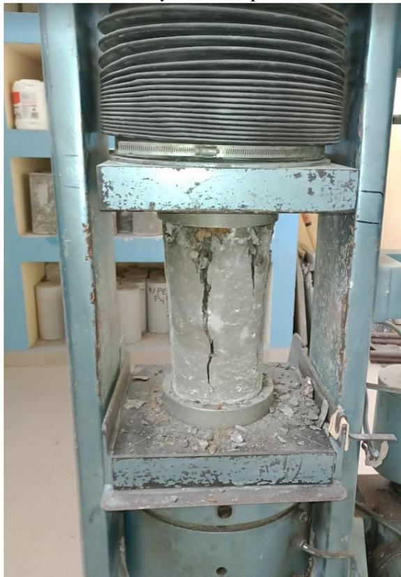
**Figura 46.** *Probeta con cangrejas sin reparar.*
