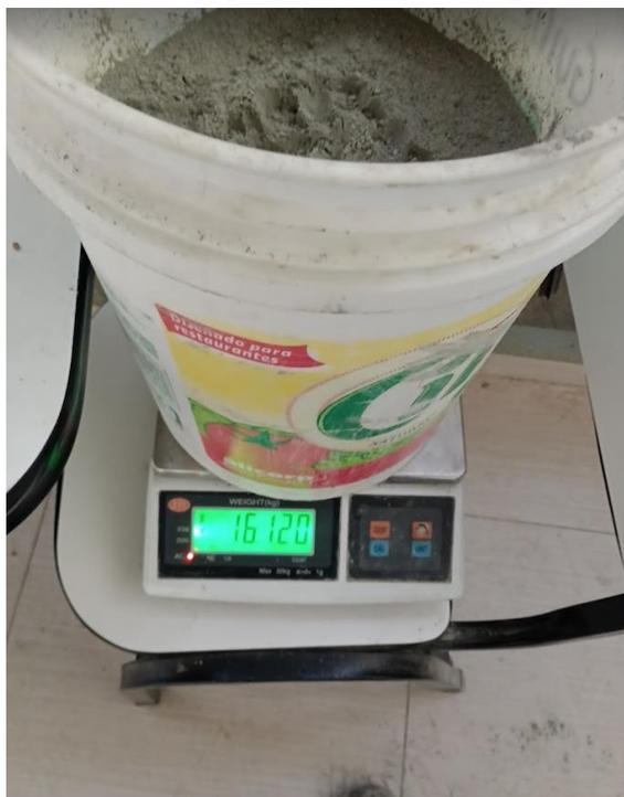
**Figura 38.** *Pesado de agregado fino para elaboración de probetas*
