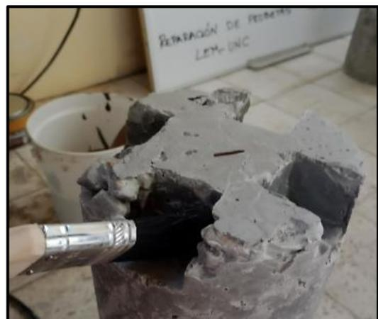
Después de 7 días de la reparación, las probetas fueron ensayadas en la maquina universal de ensayos para evaluar la resistencia a compresión axial.
