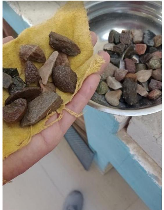
**Figura 28.** *Encontrando condición de SSS.*
