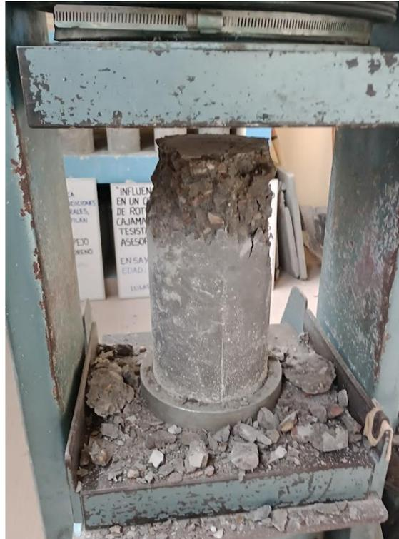
**Figura 44.** *Probeta justo después de fallar a compresión.*
