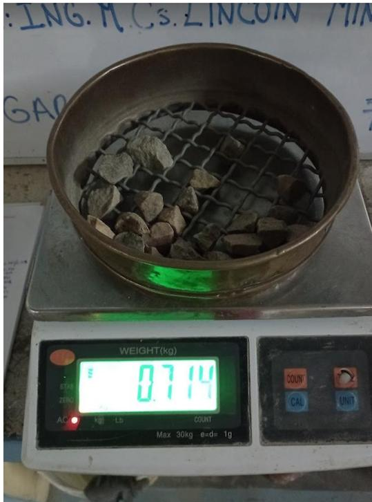
**Figura 35.** Pesado de agregado retenido en malla N1/2.
