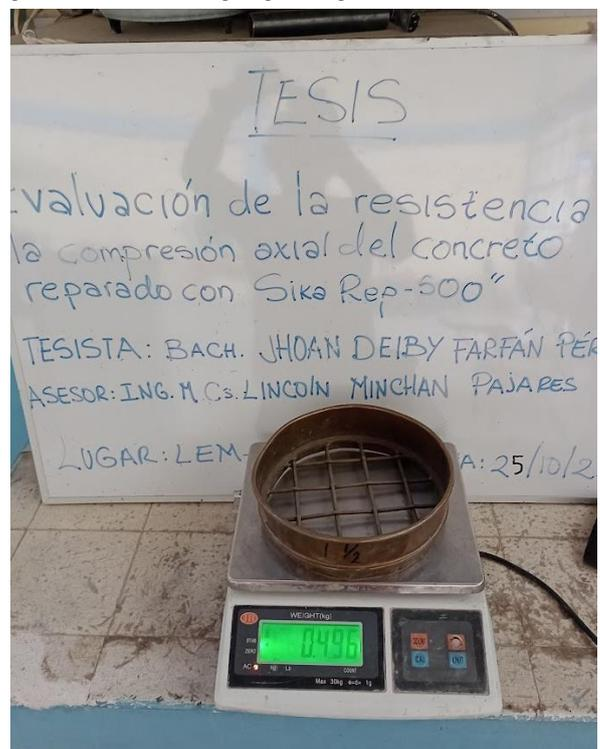
**Figura 34.** Para granulometría agregado grueso.
