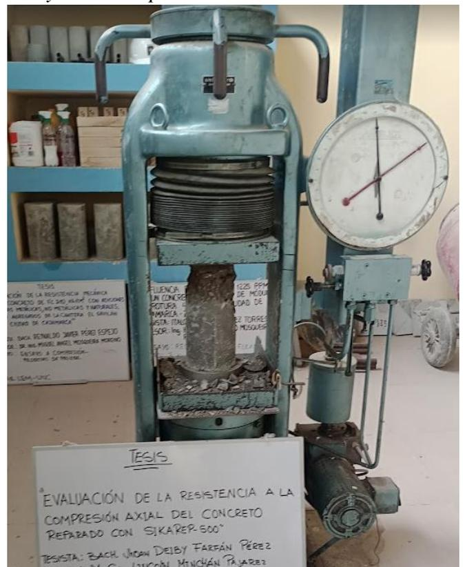
**Figura 43.** *Probeta con cangrejera luego de ser ensayada a compresión.*
