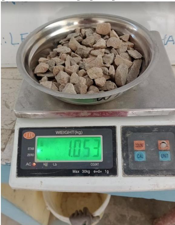
**Figura 33. Pesado de tamices para ensayo de granulometría agregado grueso.**
