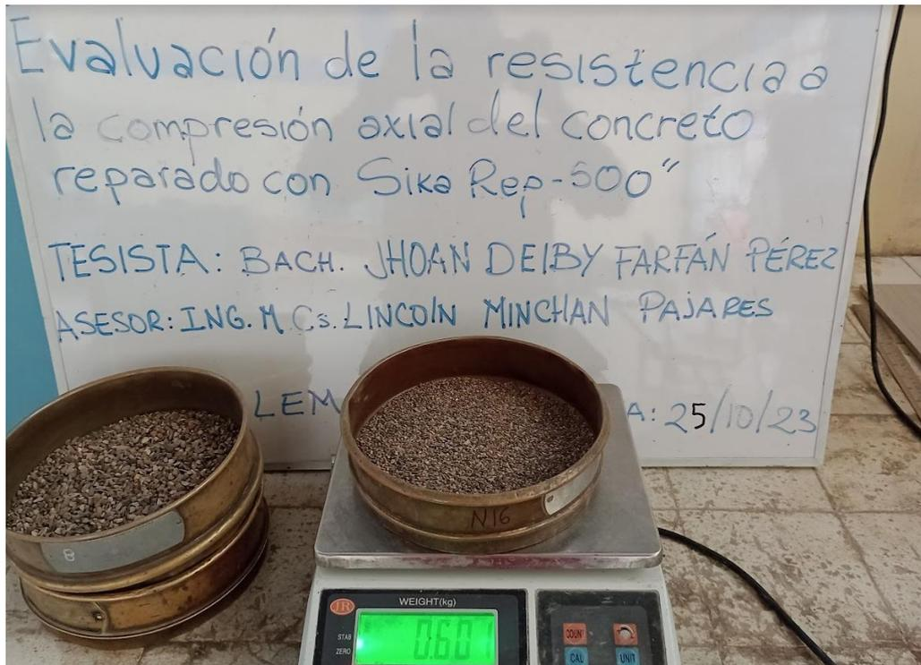
**Figura 32. Pesado de muestra para granulometría de agregado grueso.**
