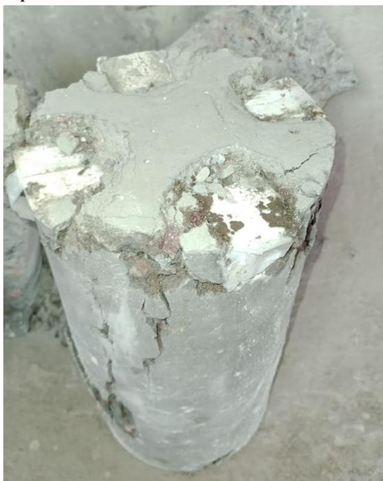
**Figura 47.** *Probetas apiladas luego del ensayo a compresi3n, para ser desechadas.*
