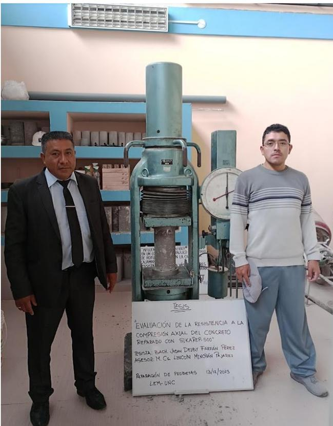
**Figura 42.** Probeta después de haber sido ensayada a compresión.
