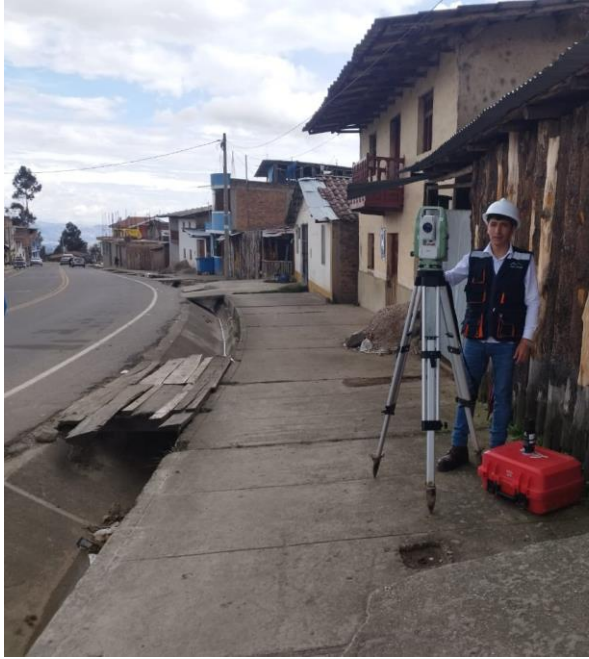
Fotografía 5: Estacionamiento de la estación Total Leica la que sirvió para el levantamiento topográfico del tramo de estudio
