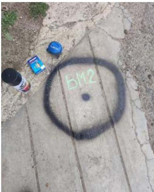
Fotografía 3: Se muestra el punto BM2, punto de orientacion que permitió estacionar el equipo para el levantamiento Topográfico de la zona de estudio.
