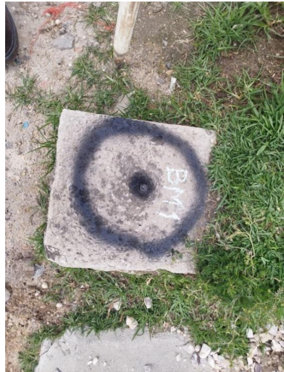
Fotografía 2: Punto BM1, sirvió de referencia para el levantamiento Topográfico de la zona de estudio, es aquí donde estacionamos el equipo topográfico.
