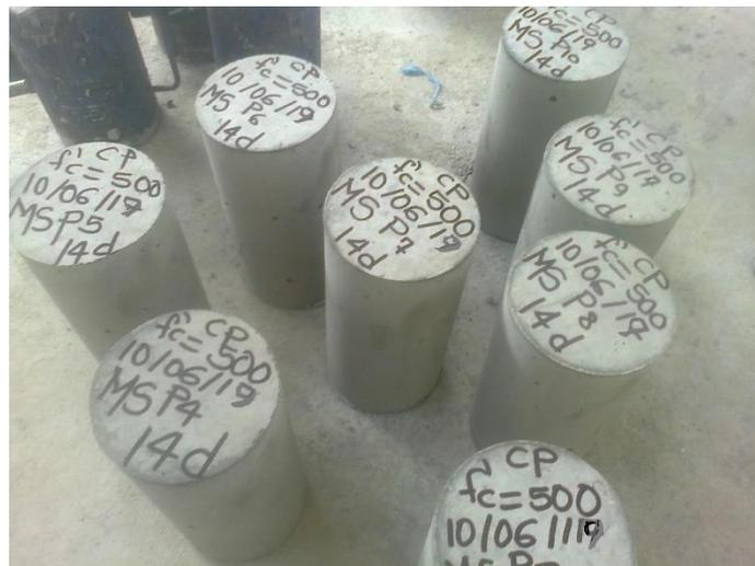
**Figura 14.** Desencofrado y codificación de los especímenes de concreto
