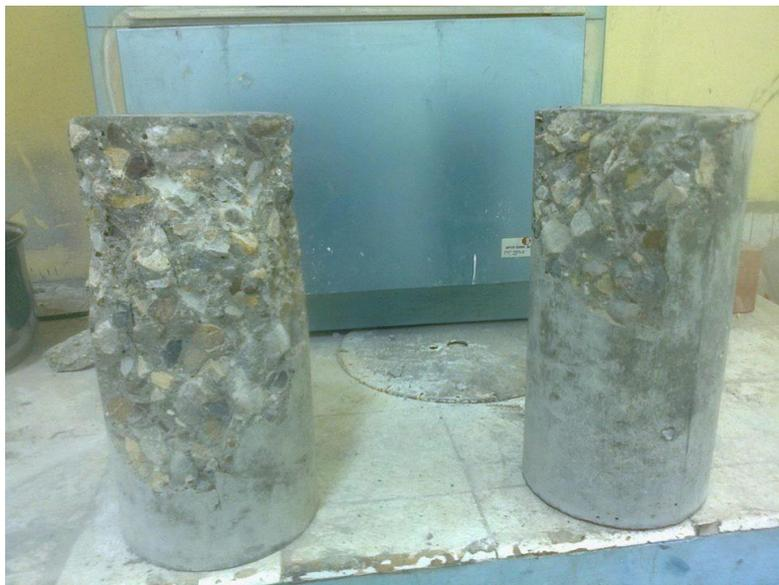
**Figura 18.** Modo de falla de los especímenes de concreto
