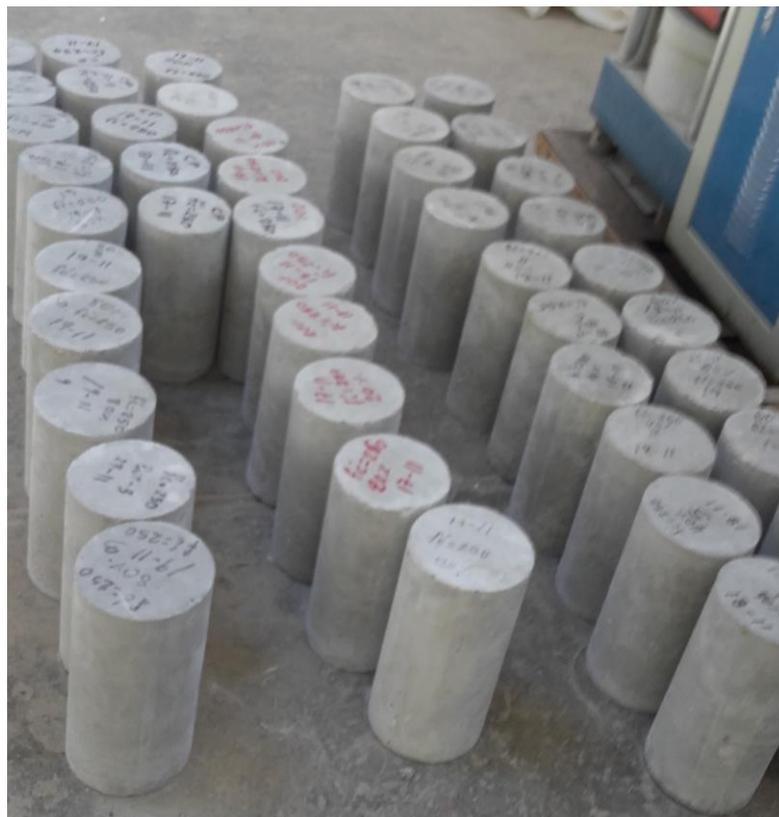
**Figura 16.** Especímenes de concreto para ser ensayados a compresión axial
