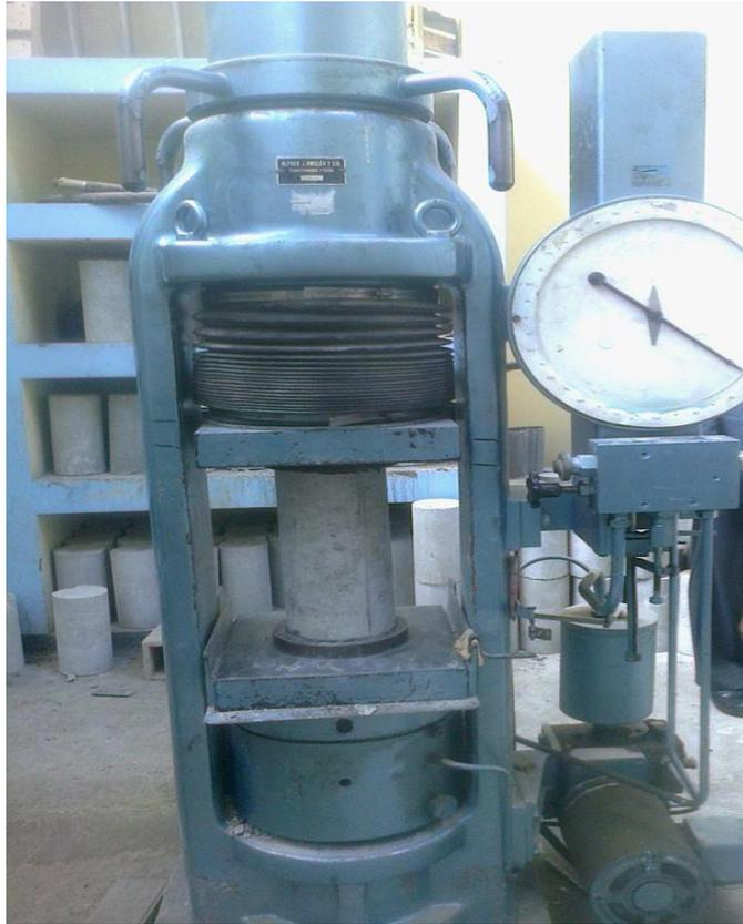
**Figura 17.** Ensayo a compresión axial de los especímenes de concreto
