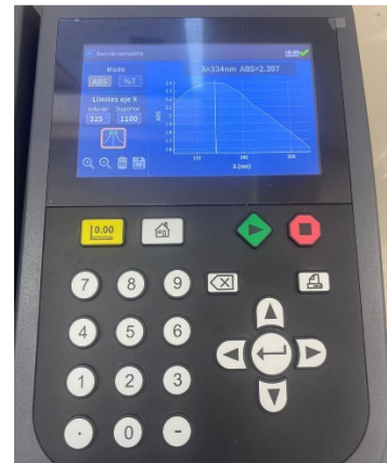
Espectrofotómetro para la lectura de polifenoles
