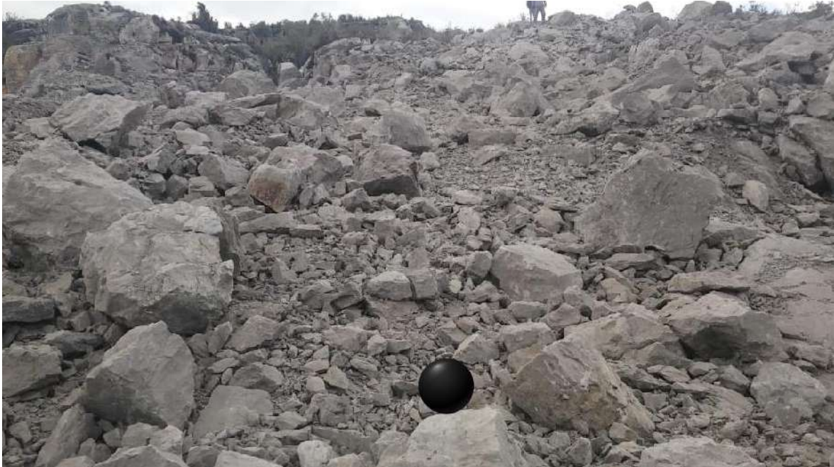
Foto 2. Fragmentación de la roca después de la voladura, malla 2.5 x 2.5 m. El diámetro de la esfera color negro es de 9.8 pulgadas.
