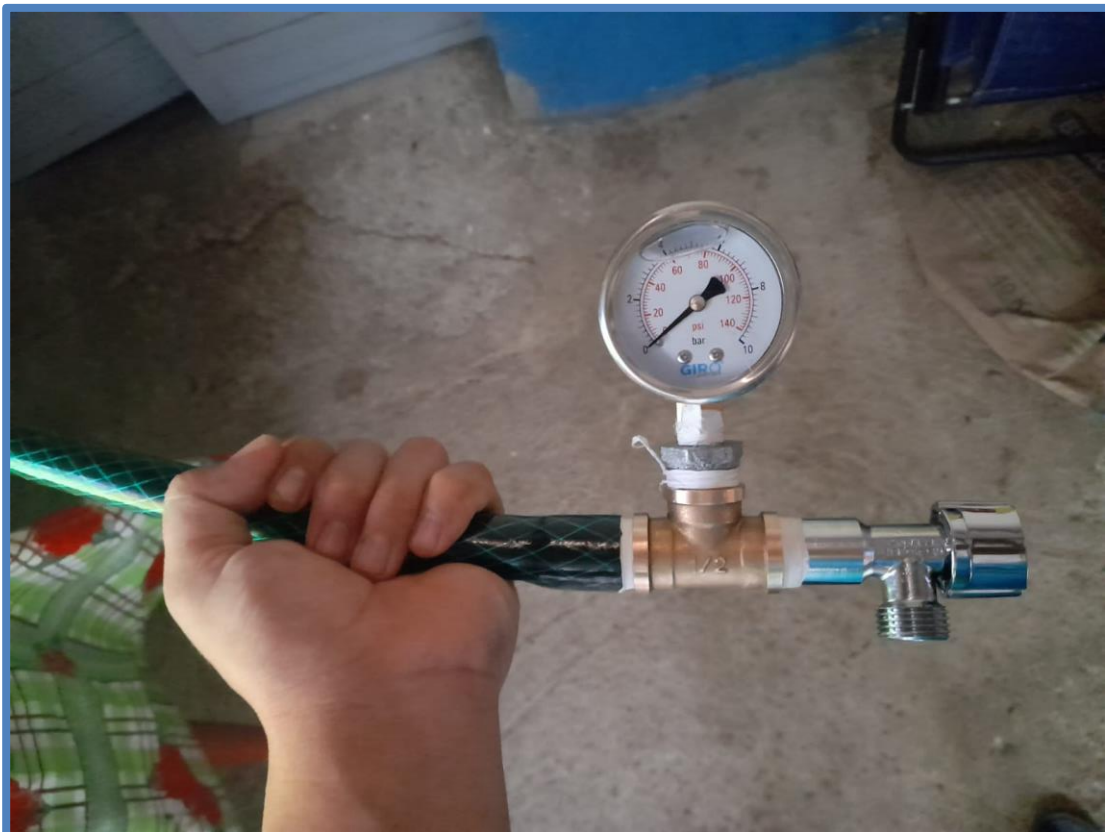
Foto 8: Instrumento para la medición de presión en las conexiones domiciliarias.
