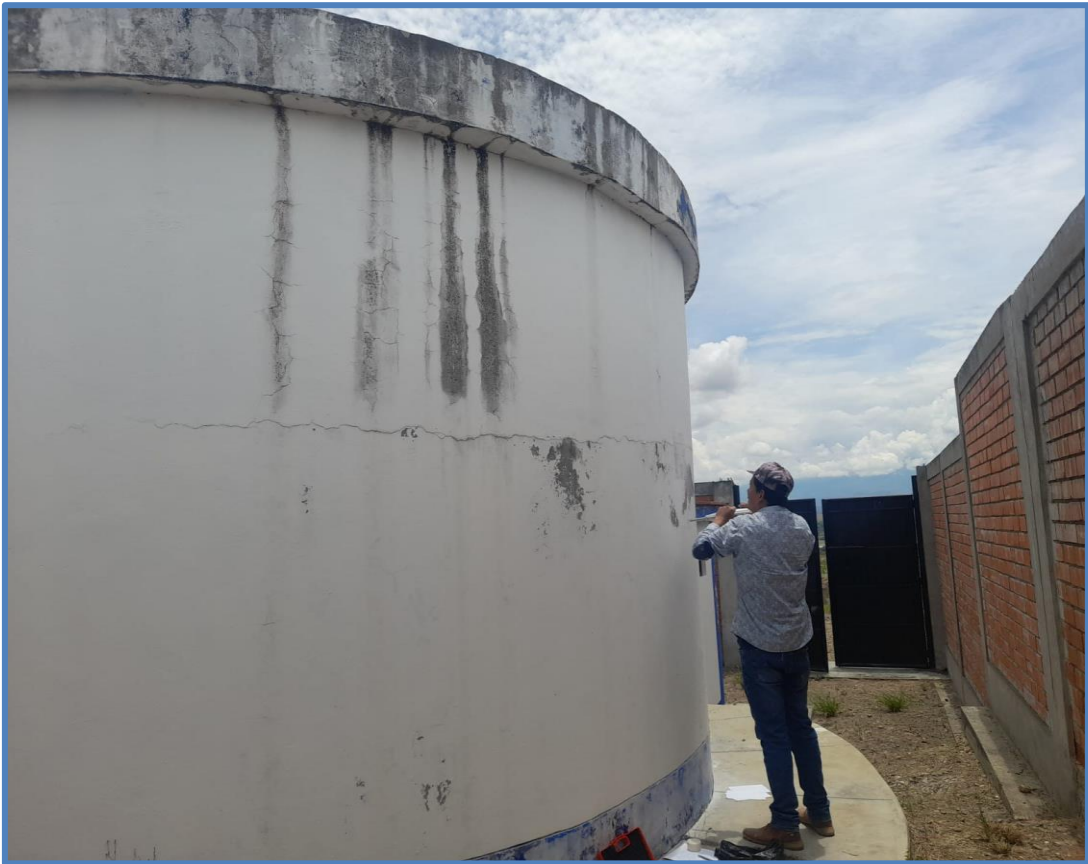
Foto 18: Ensayo de esclerometría en el techo del reservorio de Sambimera.
