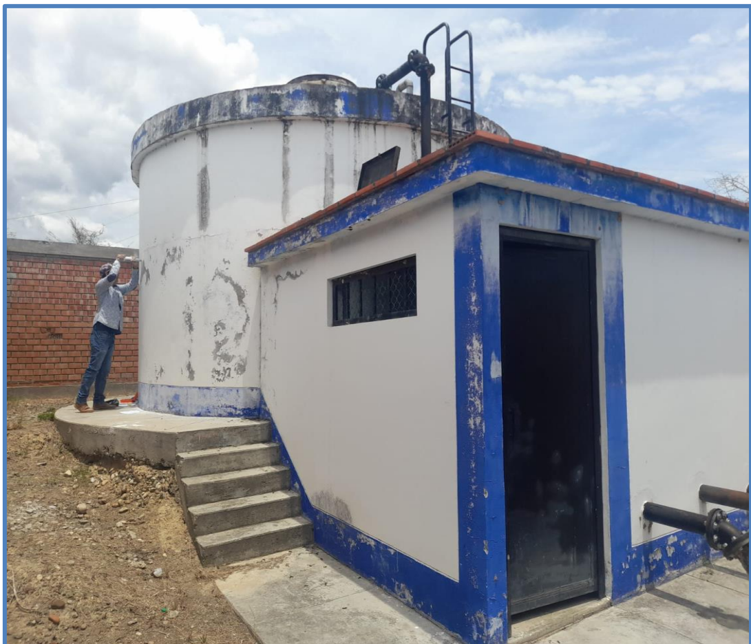
Foto 16: Ensayo de esclerometría en un lado del muro de reservorio de Sambimera.
