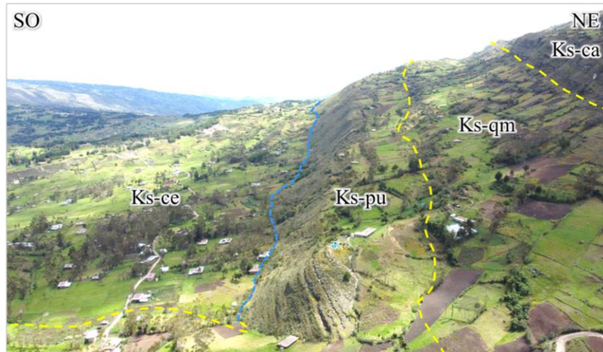
Foto 21: Falla inversa formando un relieve escarpado entre el contacto de la Formación Celendín y Grupo Pulluicana. Coordenadas (UTM): N: 9268265; E: 771778; C: 3336.
