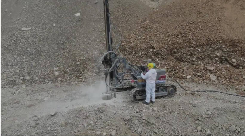
Foto 3. Perforación de roca caliza.
