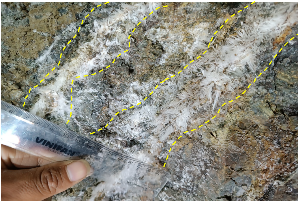
Foto 4. Recristalización de minerales de Epsomita de habito fibroso, ubicados en los hastiales de la excavación subterránea desde: Pip. + 140 m. a Pip. + 155 m., formándose en las juntas del afloramiento rocoso.
