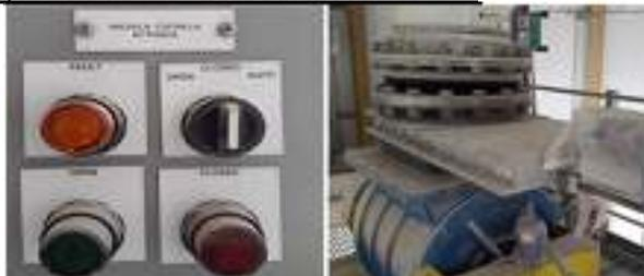
**Activando el vibrador rotatorio el cual debe estar en automático "AUTO", iniciando el llenado automáticamente de la bombona.**
