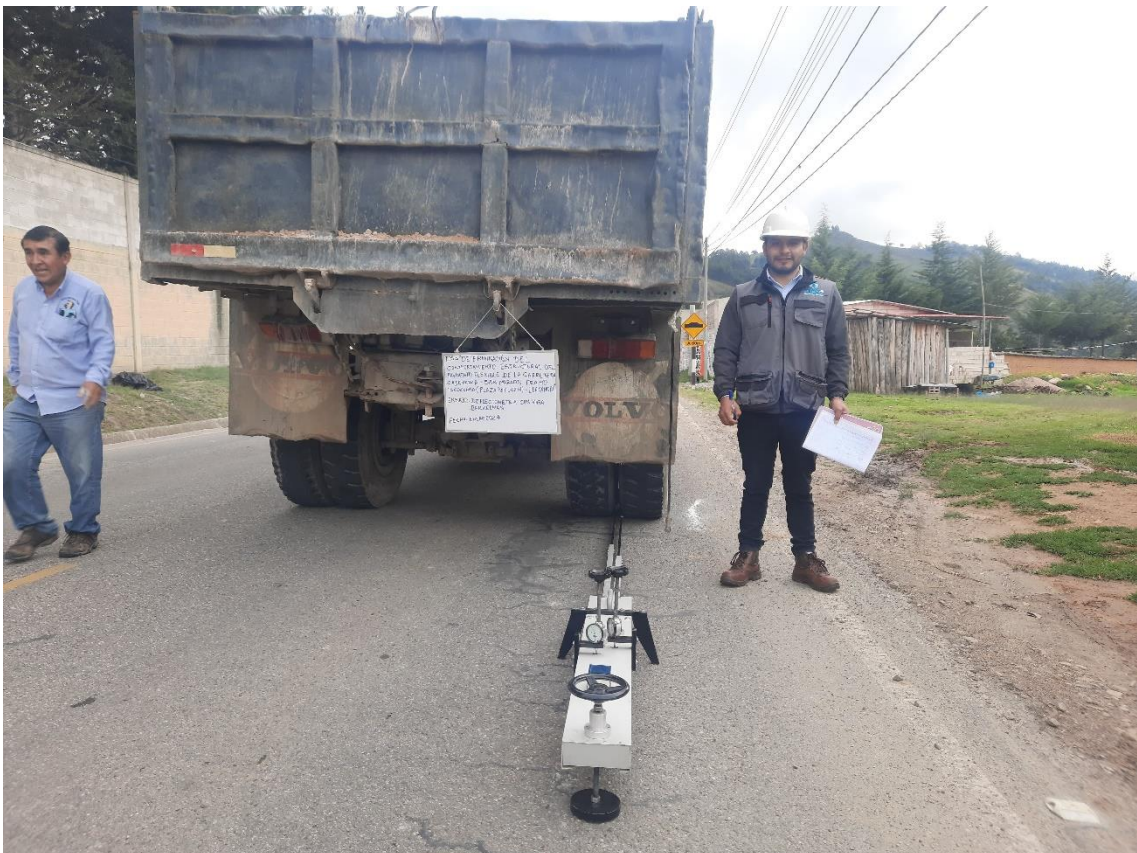
Fotografía 7. Realización del ensayo con la Viga Benkelman en la carretera Cajamarca-San Marcos; Tramo Iscocongá - Llacanora, unidad de muestreo 7
