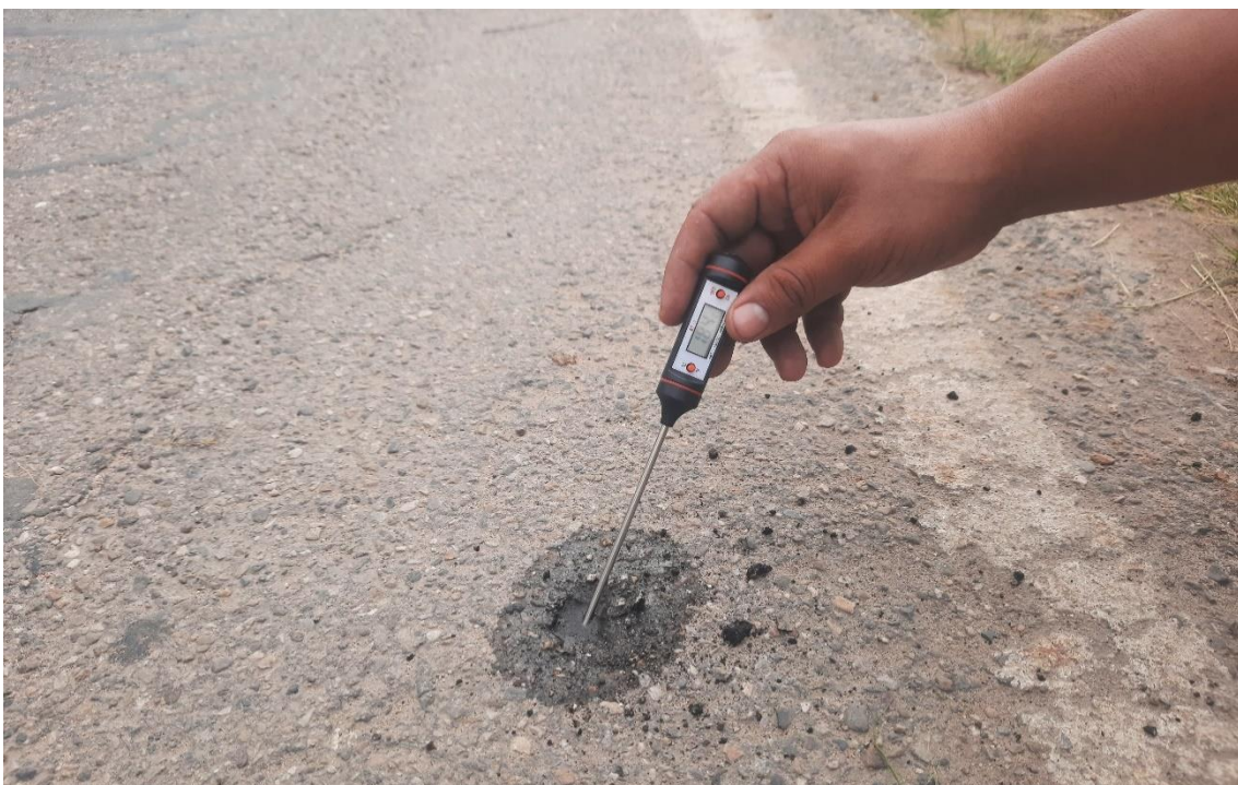
Fotografía 9. Toma de temperatura en el asfalto para el ensayo con Viga Benkelman en la carretera Cajamarca-San Marcos; Tramo Iscocongá (Plaza Pecuaria)- Llacanora
