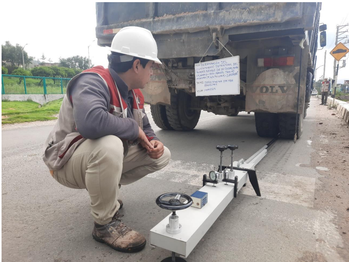
Fotografía 11. Realización del ensayo con la Viga Benkelman en la carretera Cajamarca-San Marcos; Tramo Iscoconga - Llacanora, unidad de muestreo 42
