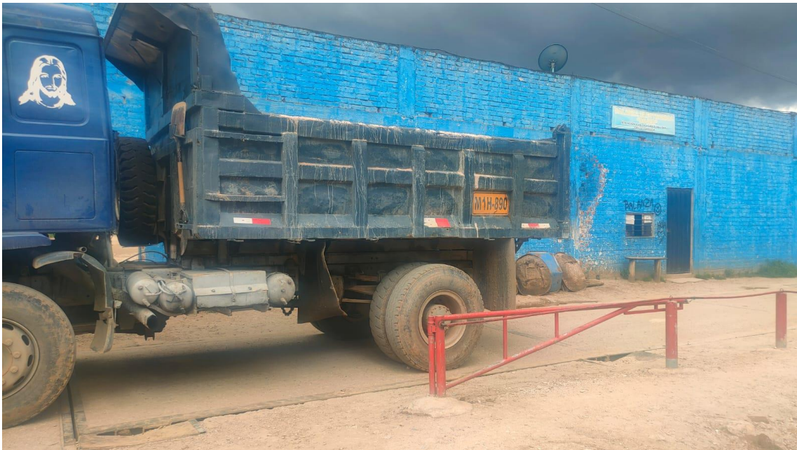
Fotografía 6. Pesado del camión para el ensayo con la Viga Benkelman en la carretera Cajamarca-San Marcos; Tramo Iscocongá (Plaza Pecuaria)- Llacanora
