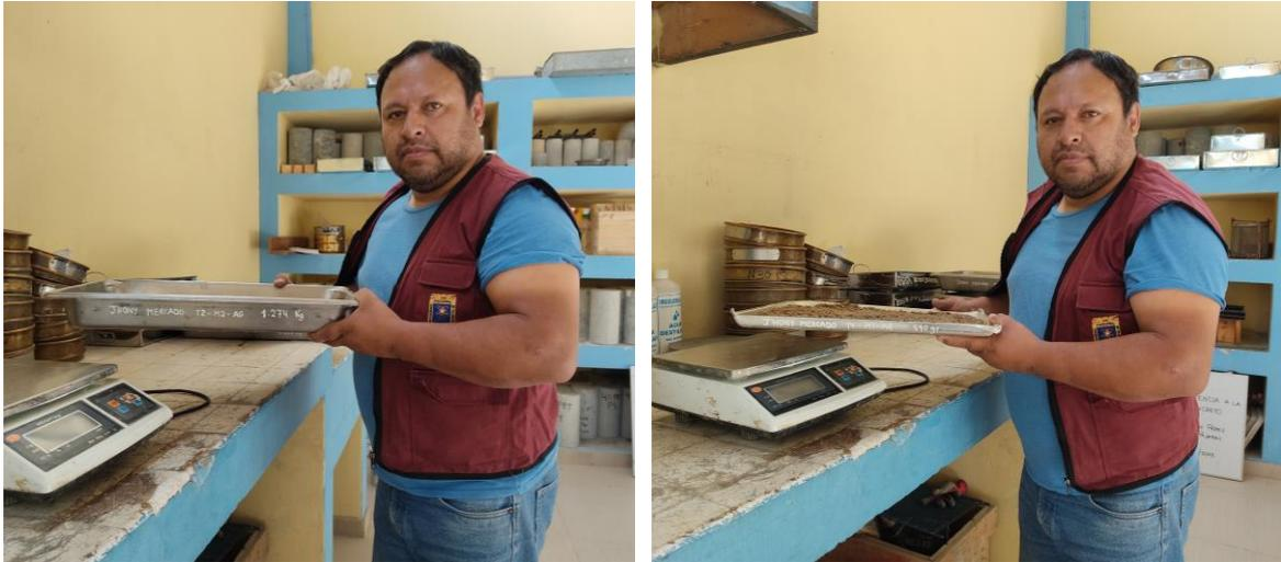
Figura 34. Ensayo para calcular el peso específico del agregado fino
