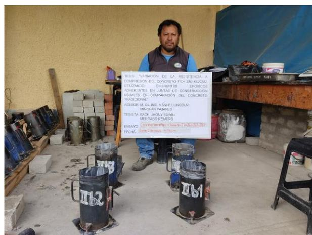
**Figura 38. Llenado de probetas de concreto a 14 días**
