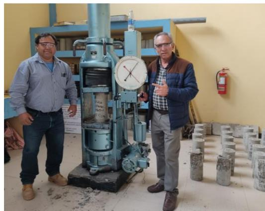
**Figura 41. Ensayo a compresión de probetas de concreto a 14 días, con la presencia del ingeniero asesor**
