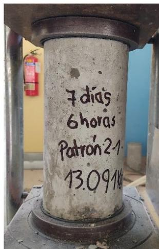
**Figura 44. Probeta de Concreto con Sikadur®-32 Gel en la junta de construcción elaborado con Cemento Portland Pacasmayo Tipo I correspondiente al grupo "2"**
