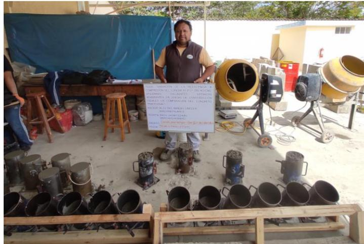
**Figura 39. Llenado de probetas de concreto a 28 días, con la presencia del ingeniero asesor**
