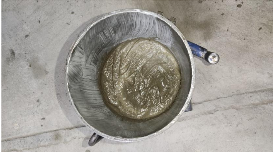
Figura 47: Lechad de cemento y agua en junta de 0°
