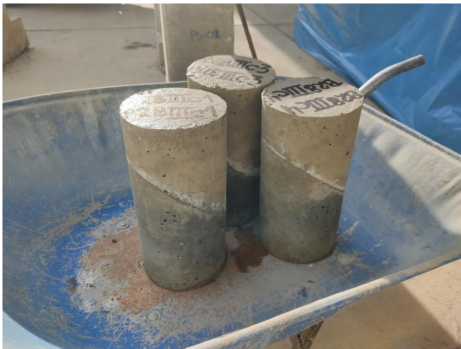
Figura 78: Probetas con edades de 28 días.
