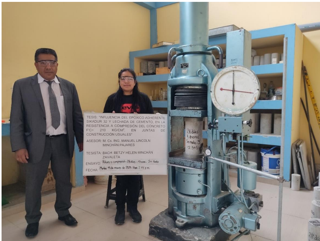
Figura 104: Ensayo a rotura a compresión de probetas de edades de 28 días con juntas de 45° junto con el Ing. Asesor.
