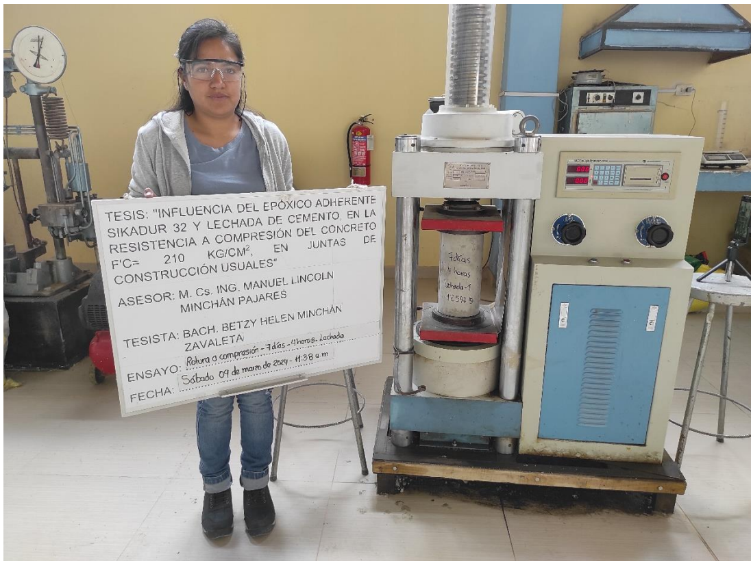
Figura 98: Ensayo a rotura a compresión de probetas de edades de 7 días con juntas de 45°
