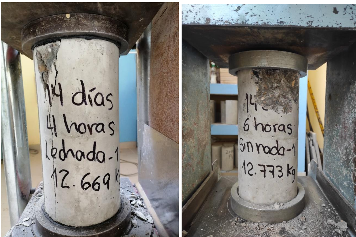
Figura 92: Probetas con lechada y sin epóxico en edad de 14 días con un ángulo de 0°
