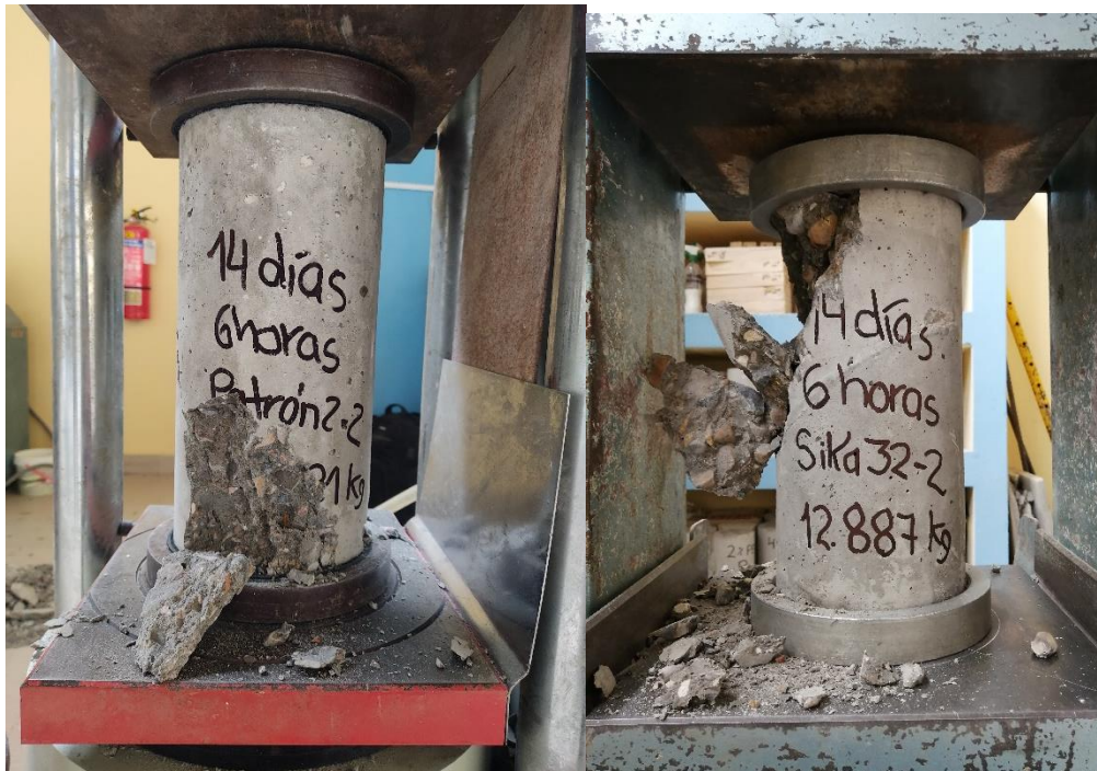
Figura 102: Probetas patrón y con epóxico Sika 32 en edad de 14 días con un ángulo de 45°
