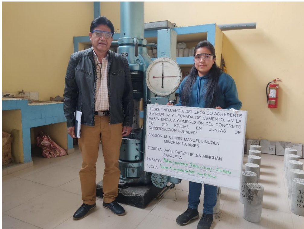
Figura 87: Ensayo a rotura de probetas de edades de 7 días con juntas de 0°, con supervisión de Ing. Mauro Centurión jurado de la investigación.
