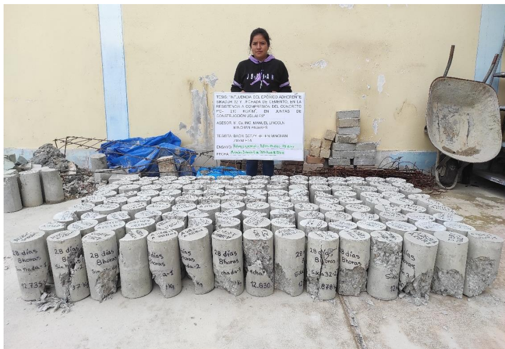
Figura 96: 135 probetas en total ensayadas a compresión con un ángulo de 0°
