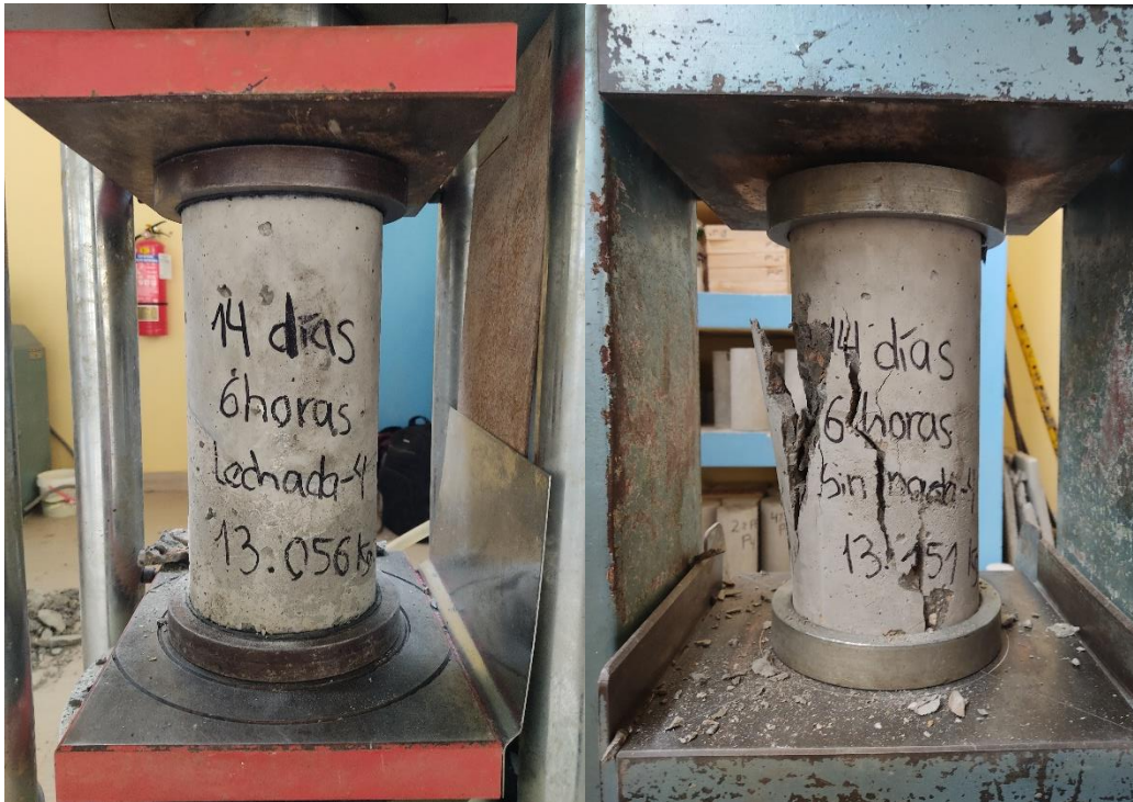
Figura 103: Probetas con lechada y sin epóxico en edad de 14 días con un ángulo de 45°
