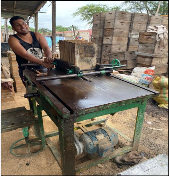
Cierra circular para realizar dentado de colmenas
