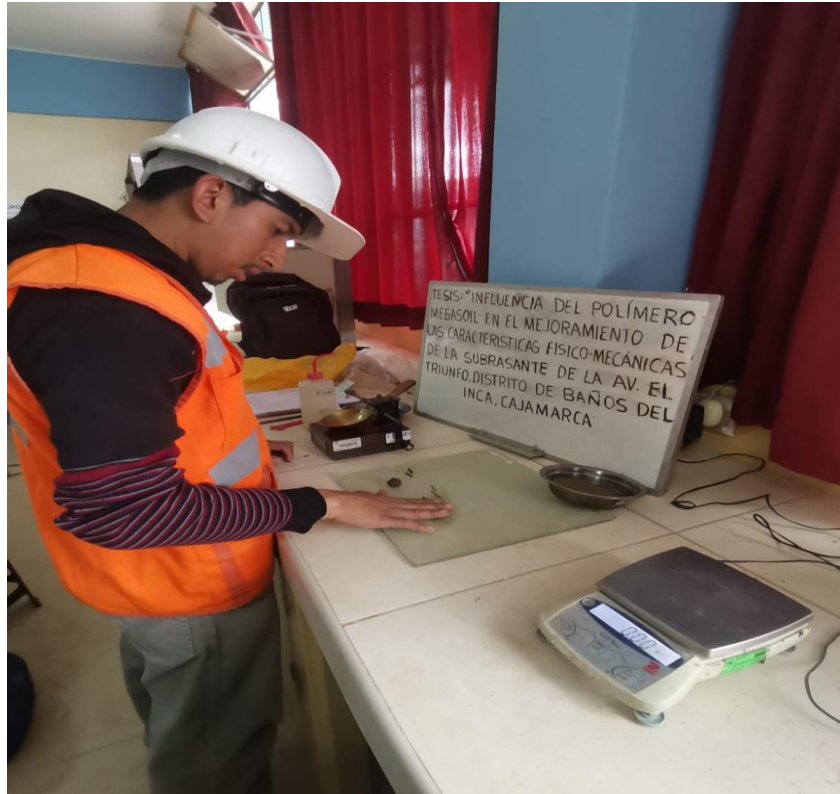
Figura N° 17: Ensayo de límite plástico de las muestras sin polímero megasoil
