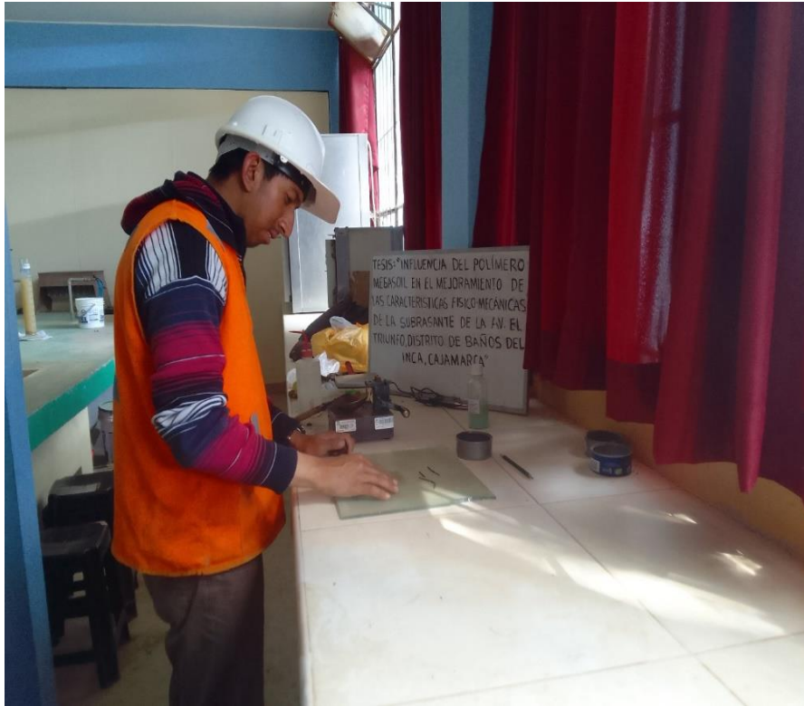
Figura N° 19: Ensayo de límite plástico de las muestras con polímero megasoil
