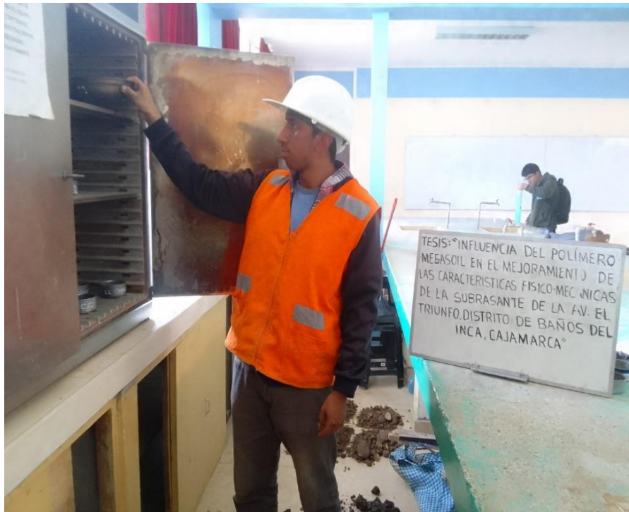
Figura N° 13: Ensayo de contenido de humedad
