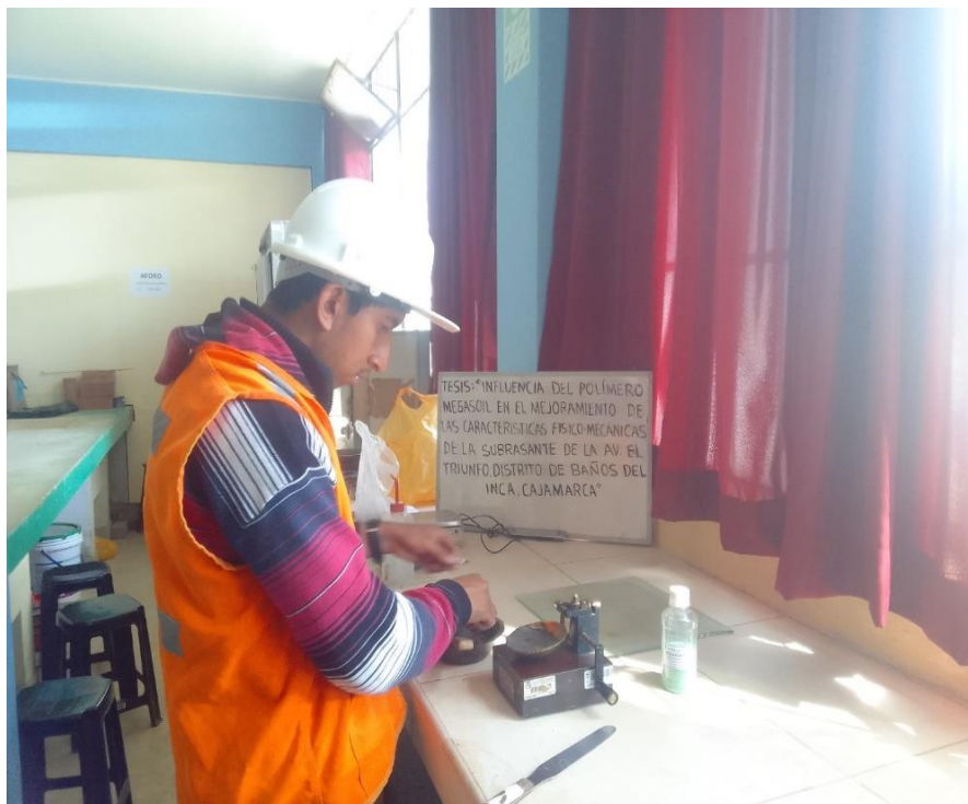
Figura N° 18: Ensayo de límite líquido de las muestras con polímero megasoil
