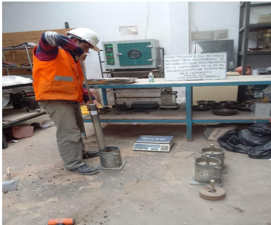
Figura N° 24: Compactación de especímenes con polímero megasoil del ensayo CBR.
