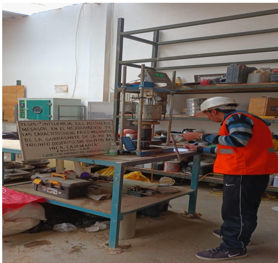
Figura N° 26: Ensayo de penetración de las muestras con polímero megasoil
