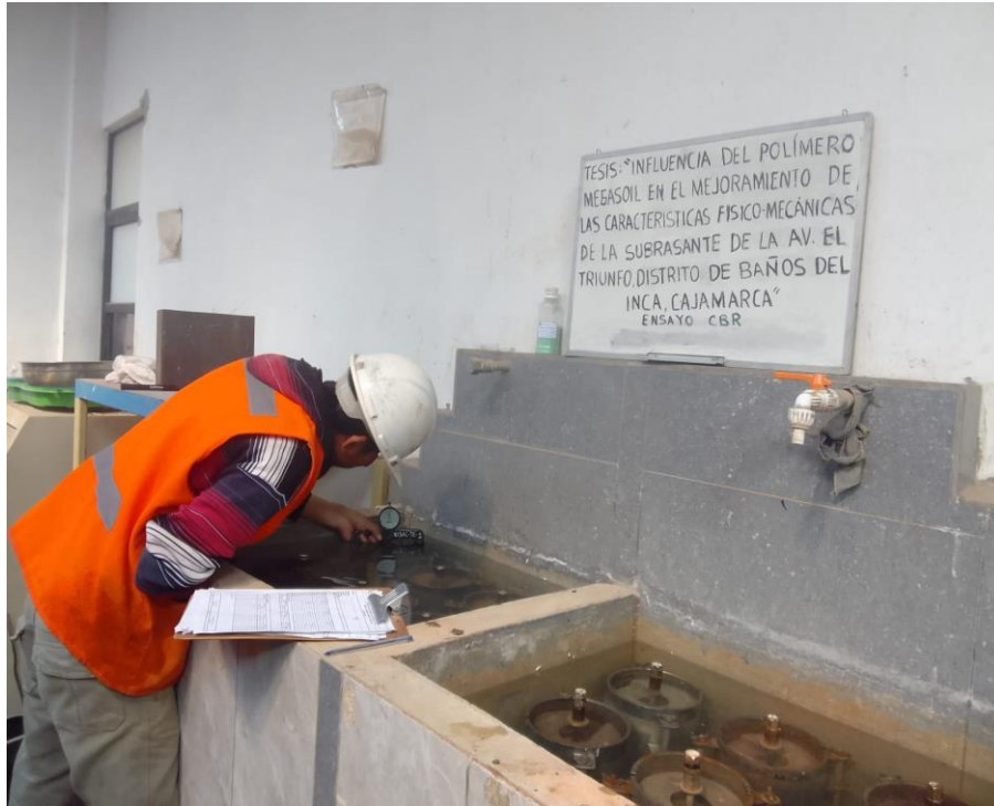
Figura N° 25: Medición del hinchamiento de los especímenes con polímero megasoil.
