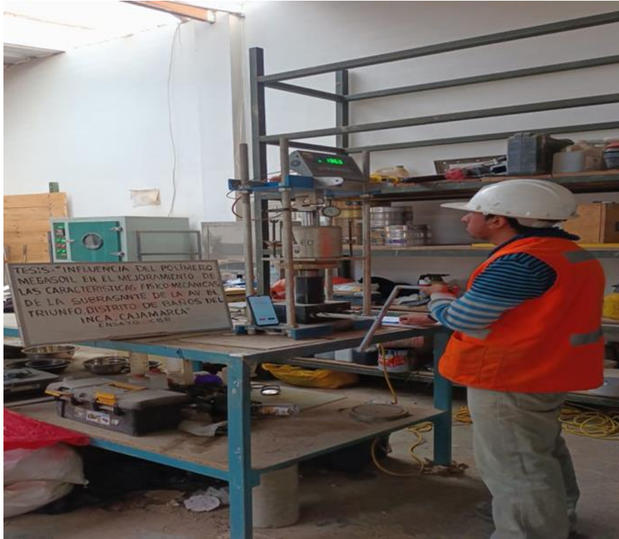
Figura N° 23: Ensayo de penetración de las muestras sin polímero megasoil.
