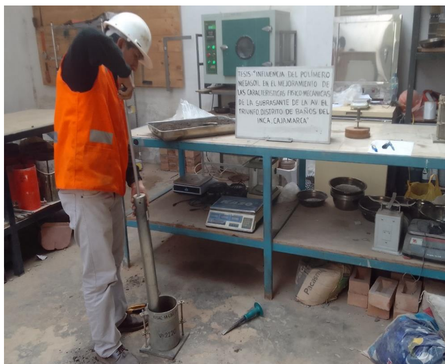
Figura N° 22: Compactación de especímenes sin polímero megasoil del ensayo CBR
