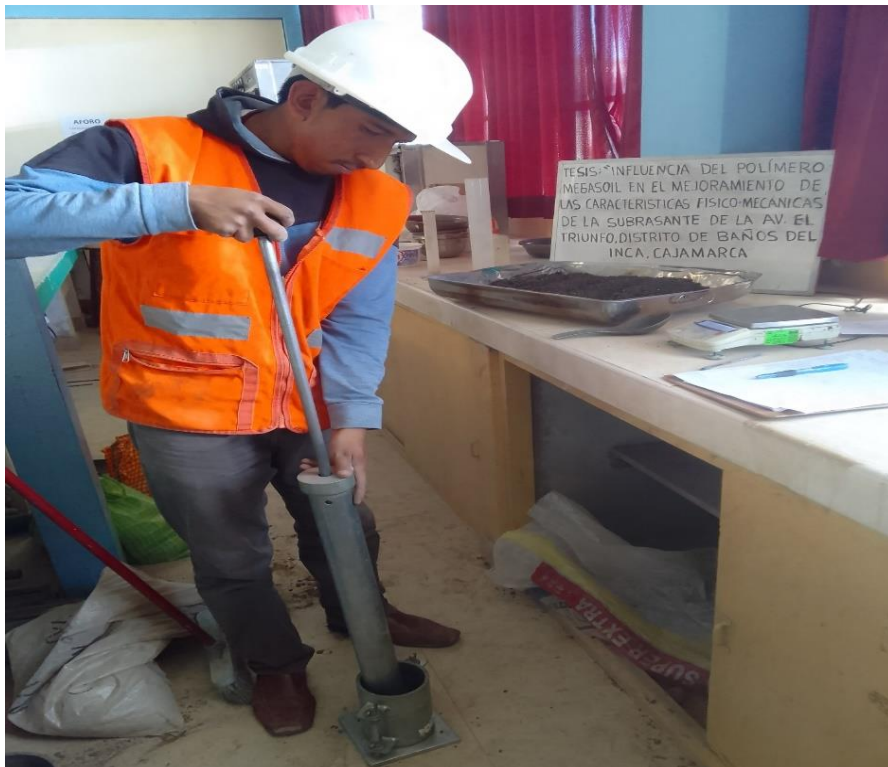
Figura N° 20: Ensayo de proctor modificado de muestras sin polímero megasoil
