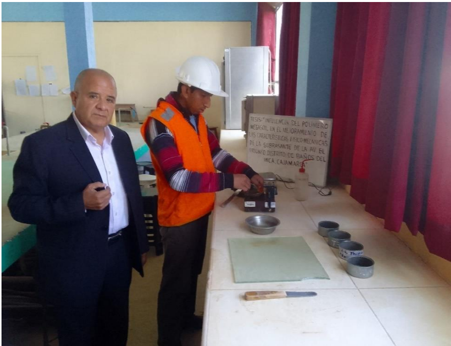
Figura N° 16: Ensayo de límite líquido de las muestras sin polímero megasoil
