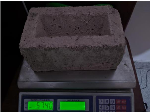
**Figura 32:** Peso de ladrillo de concreto: 5740 g
