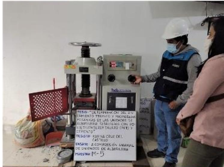
**FOTOGRAFIA N°9.** Ensayo de compresión uniaxial de la UNIDAD DE ALBAÑILERÍA M-5 [N° DE TESTIGO: 5]
