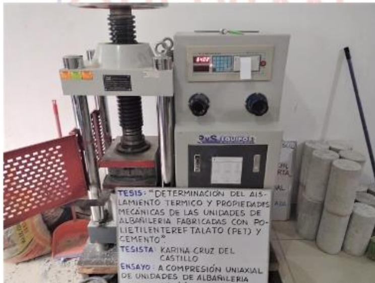
FOTOGRAFIA N°8. Ensayo de compresión uniaxial de la UNIDAD DE ALBAÑILERÍA M-4 [N° DE TESTIGO: 4]
