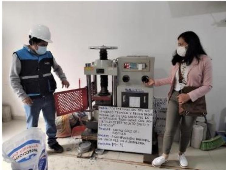
FOTOGRAFIA N°7. Ensayo de compresión uniaxial de la UNIDAD DE ALBAÑILERÍA M-4 [N° DE TESTIGO: 4]
