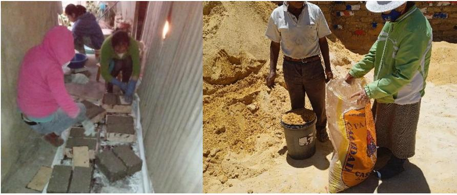
**Figura 21:** Elaboración de ladrillos PET y cemento.
