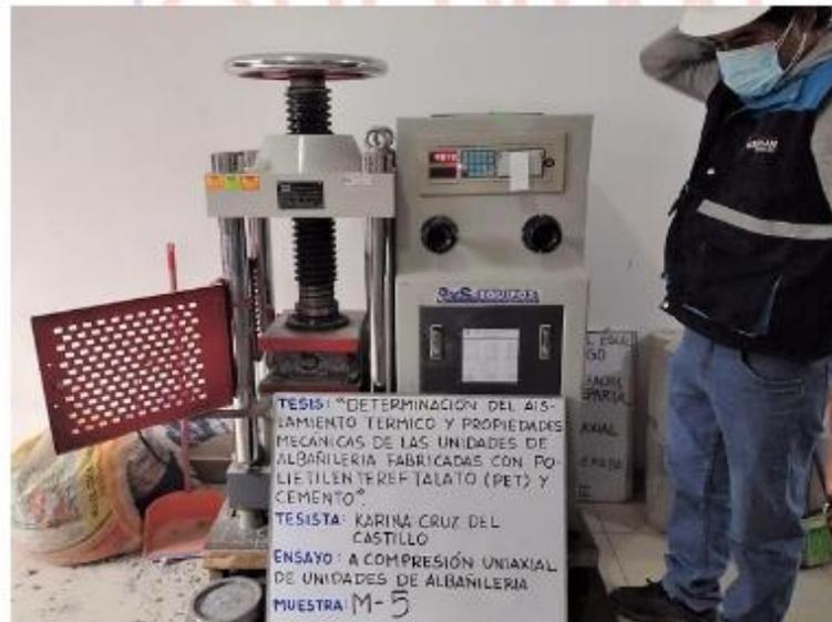
**FOTOGRAFIA N°10.** Ensayo de compresión uniaxial de la UNIDAD DE ALBAÑILERÍA M-5 [N° DE TESTIGO: 5]
