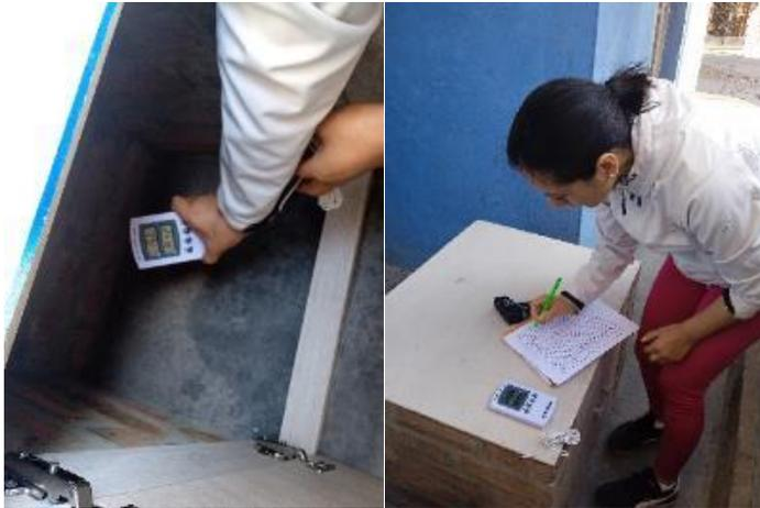
**Figura 29:** Realización de mediciones con termómetro digital y pistola láser.
