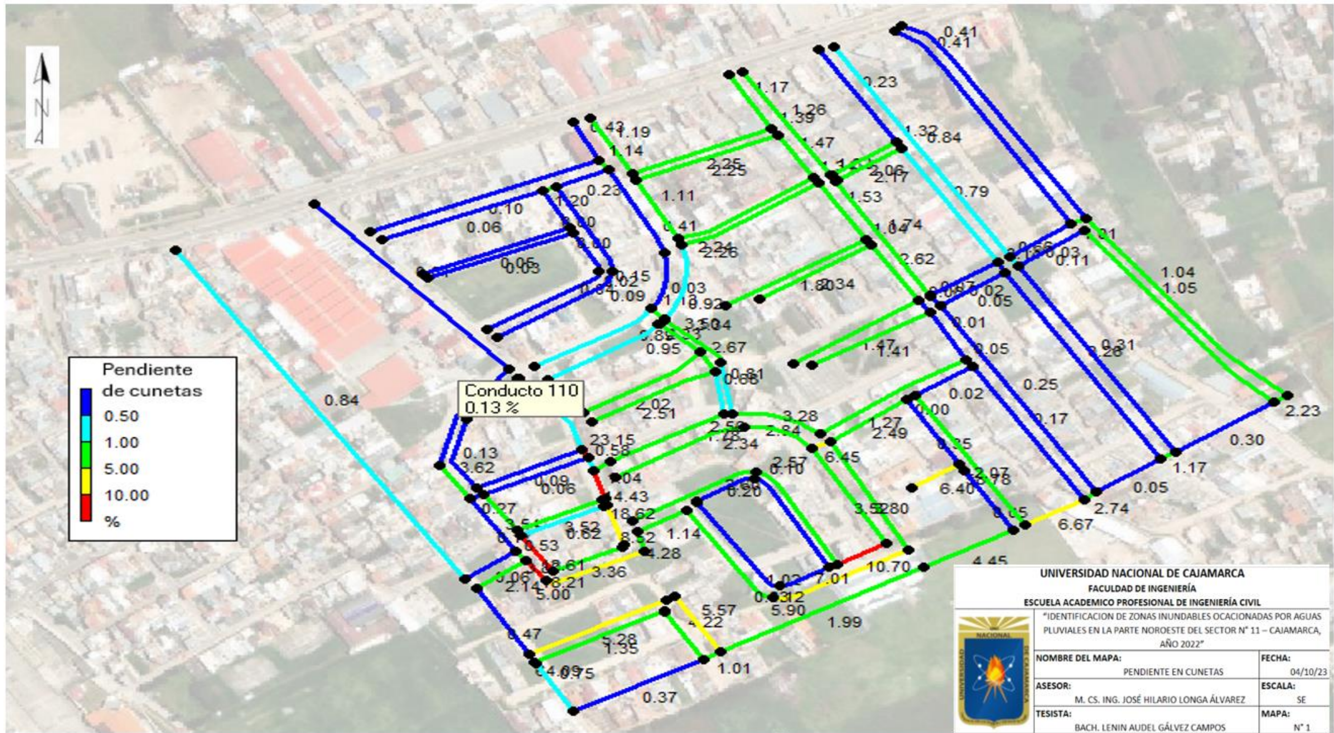
Figura 31: Pendientes en cunetas
