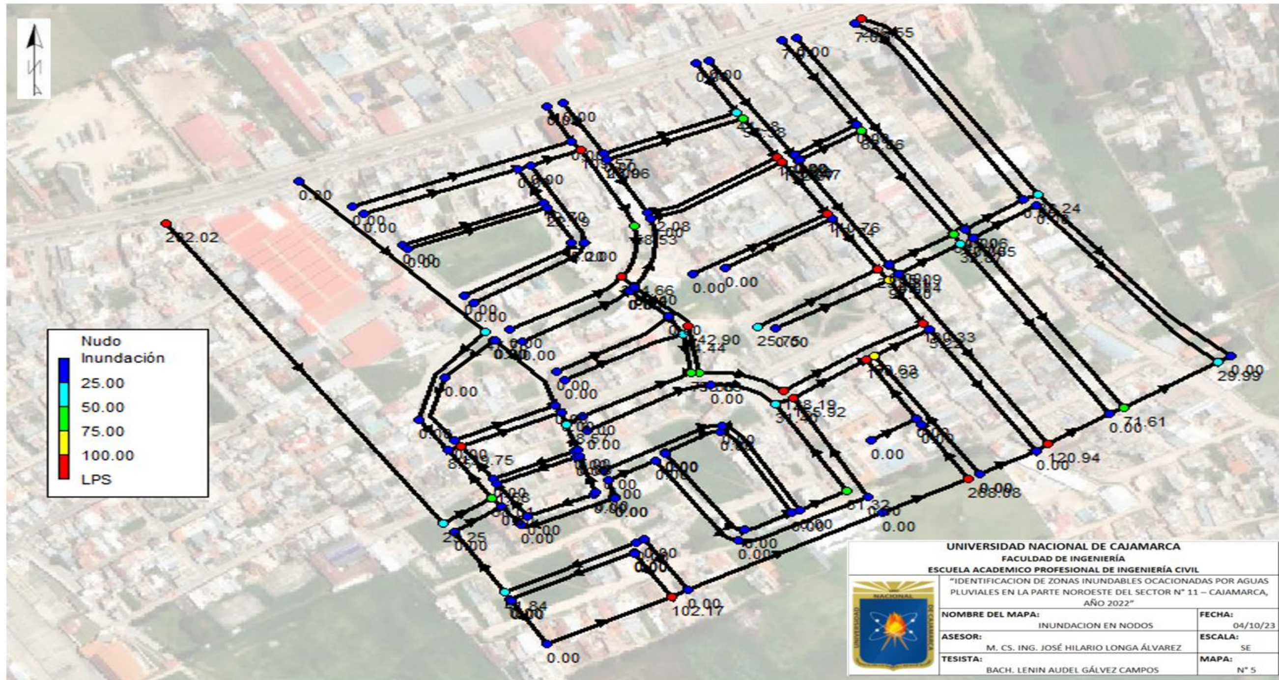
Figura 35: Inundación en los nodos
