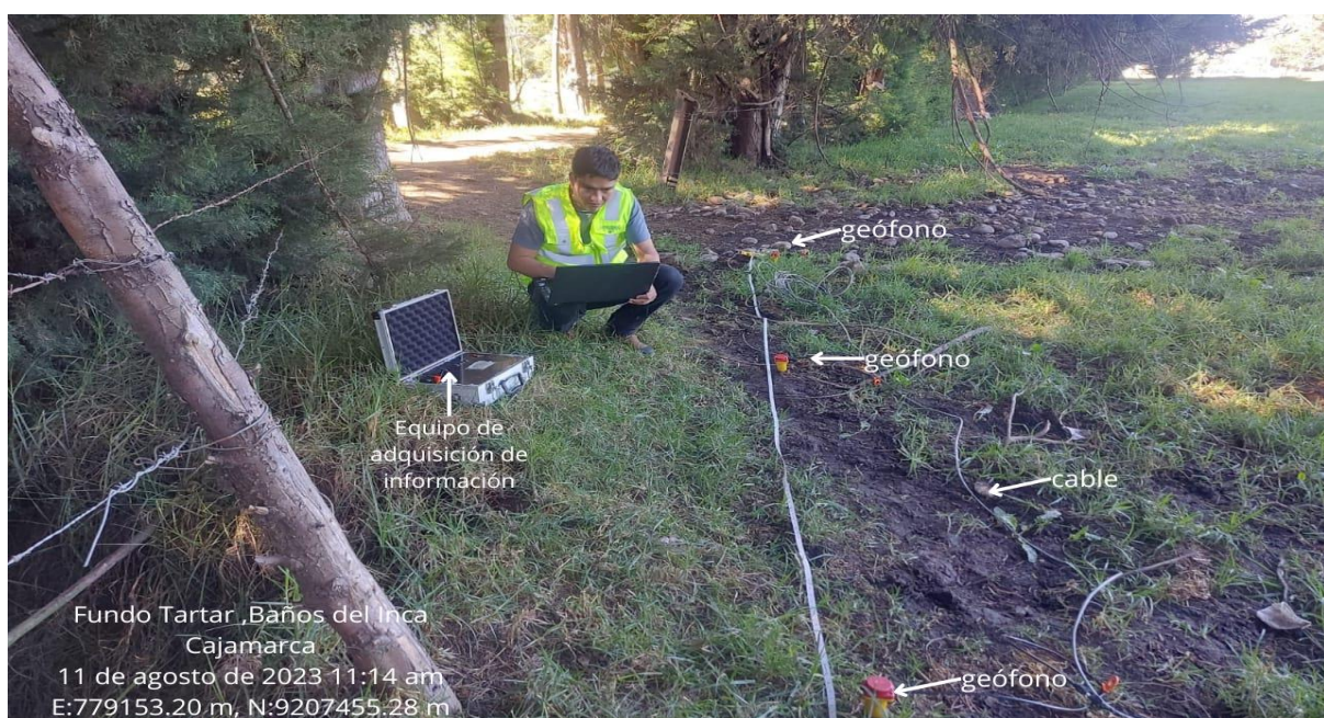
Figura 50: Sondeo de Calibración en el pozo 1 (11/08/2023)
