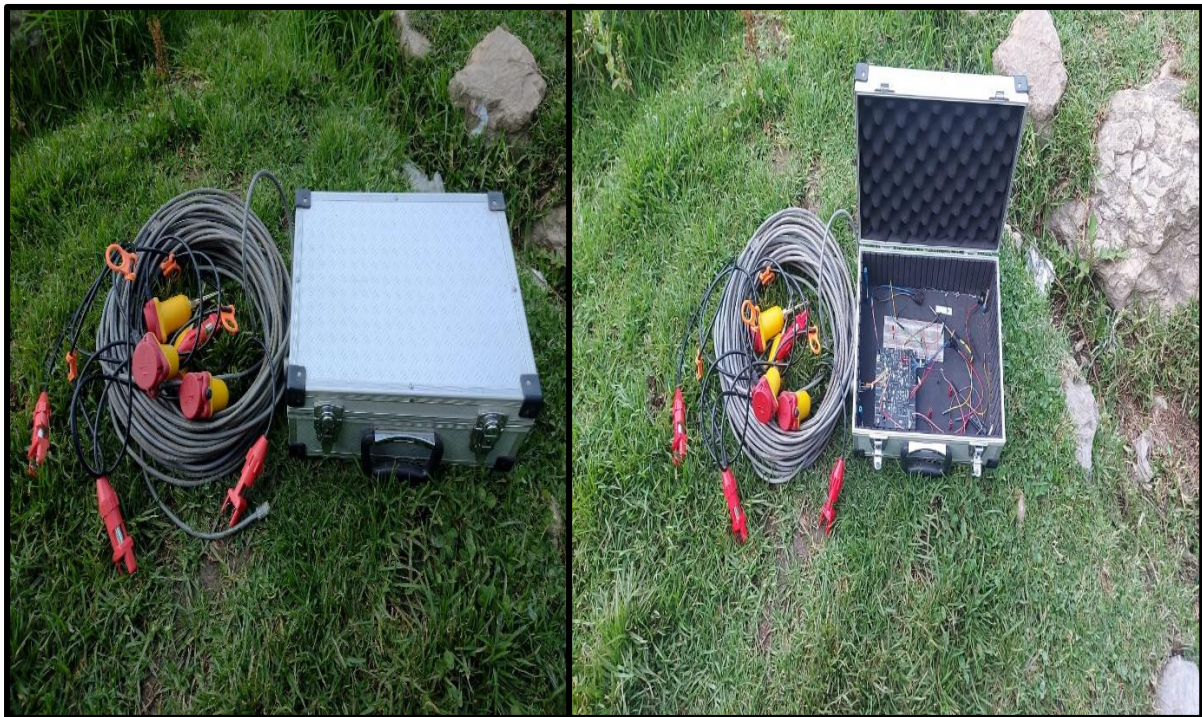
Figura 30: Unidad acondicionadora de señal, encargada de amplificar las señales provenientes de los geófonos.
