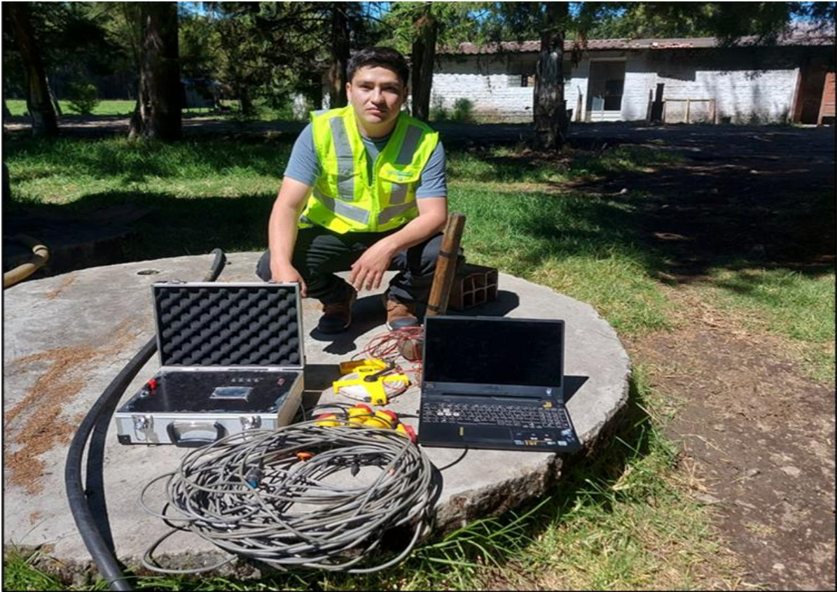
Figura 47: Equipo utilizado para la adquisición de información sísmica (10/07/2023)
