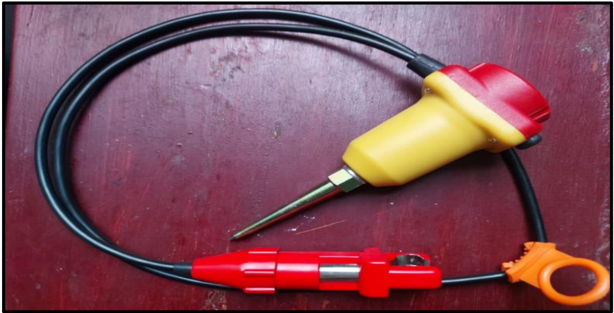
Figura 31: Geófono vertical de 4.5 Hz.
