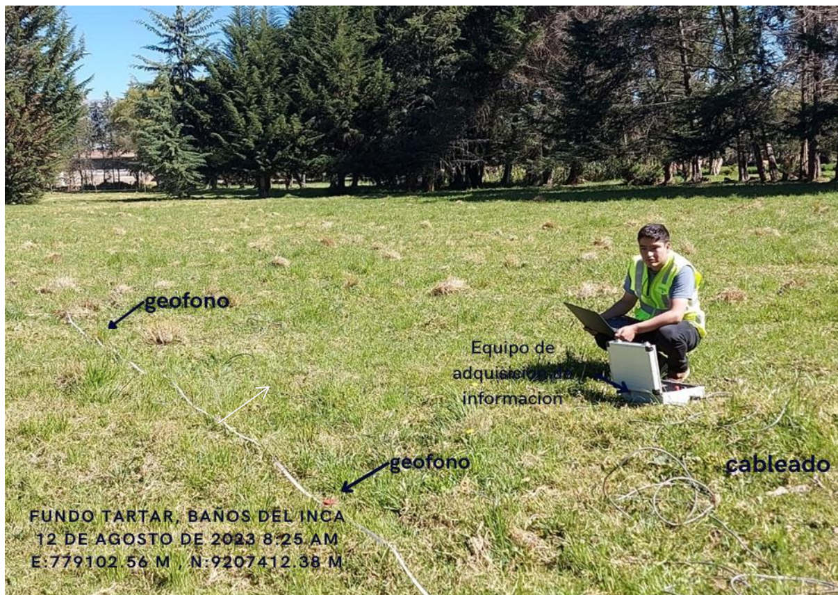
Figura 53: Sondeos sísmicos en los perfiles del fondo Tartar (12/08/2023)
