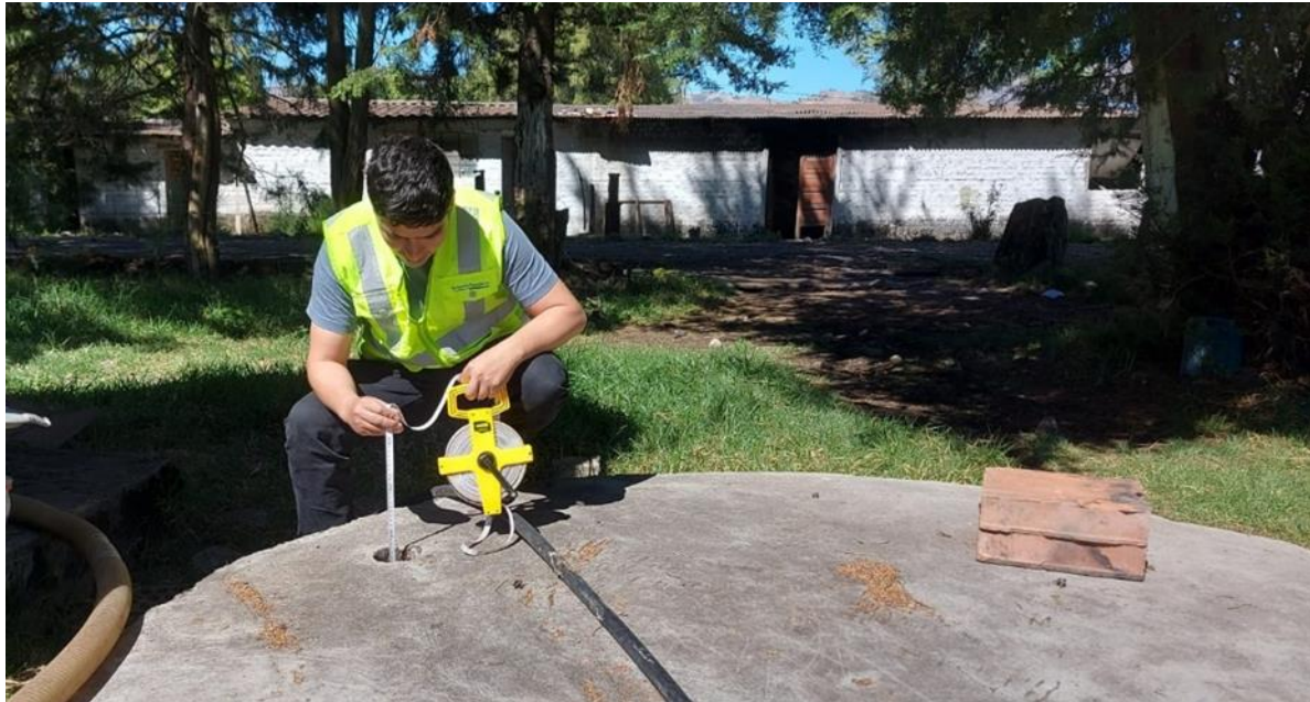
Figura 49: Toma de medidas del nivel freático en el fundo Tartar (16/08/2023)
