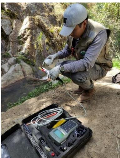
Figura 75. Preparación del equipo, donde se puede apreciar la limpieza de la sonda con agua ultrapura (UPW) o también llamada agua desionizada.
