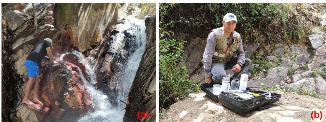
Figura 76. (a) Se observa el muestreo del agua termal M1, siguiendo el protocolo anteriormente descrito. (b) Etiquetado y sellado de la muestra para el análisis de sus aniones, cationes y bicarbonatos.
