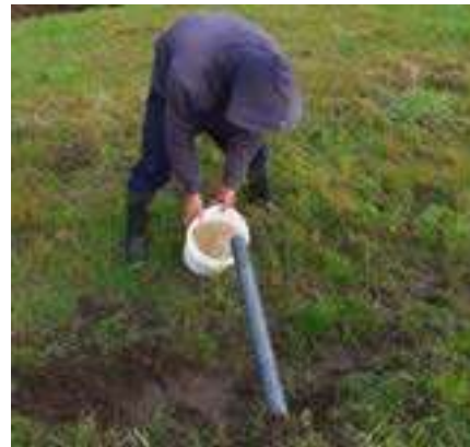
Foto Nro. 6: Método volumétrico del balde/cronómetro para el caudal de manantiales.
