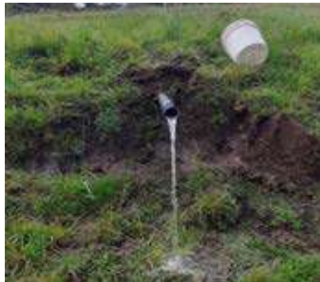
Foto Nro. 6: Método volumétrico del balde/cronómetro para el caudal de manantiales.
