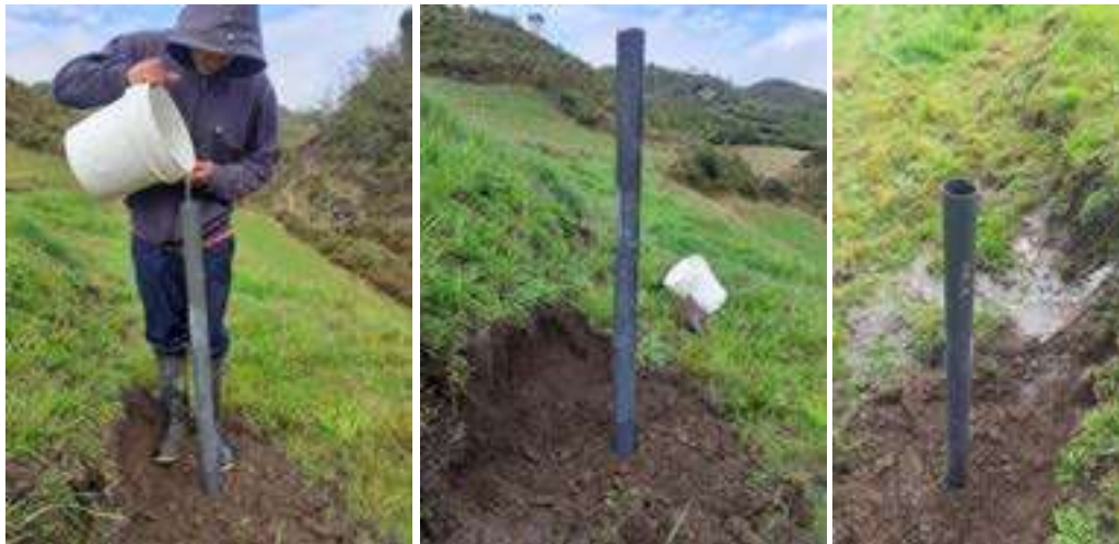
Foto Nro. 7: Ensayo de infiltración puntual en diferentes afloramientos rocosos. A la izquierda, detalle de la carga hidráulica. Al centro, detalle del permeámetro cargado de agua. A la derecha, detalle de la medida del descenso de agua en el permeámetro después de 5 minutos.
