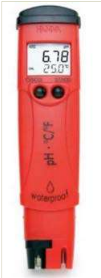
Figura Nro. 8: Equipo utilizado para la medición de parámetros fisicoquímicos en campo, es medidor digital HI98128 con este equipo se realizó las mediciones de pH, temperatura (°C).
