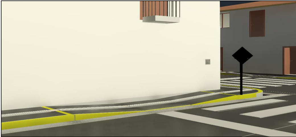
Figura N° 3.39. Vado peatonal en los cruces peatonales en el Jr. Del Comercio Cdra. 6.
