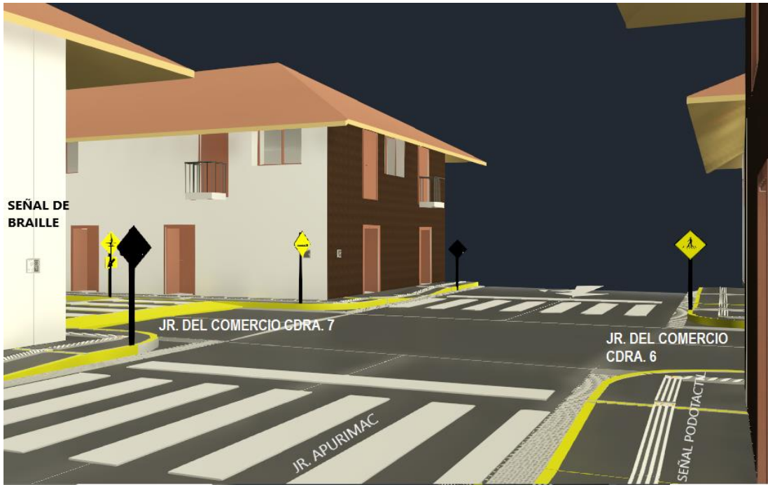
Descripción: Modelamiento de la Intersección del Jr. Del Comercio Cdra.7 y Jr. Apurímac, donde se aprecia la señalización horizontal.
