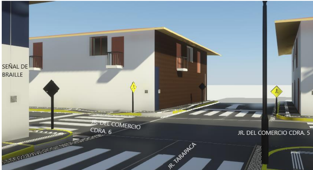
Descripción: Modelamiento de la Intersección del Jr. Del Comercio Cdra.6 y Jr. Tarapacá, donde se aprecia la señalización horizontal.
