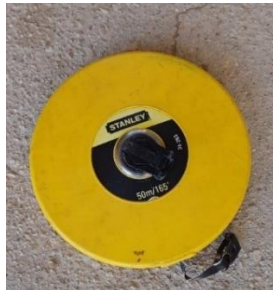
Figura N° 3.6. Wincha usada para el levantamiento.
