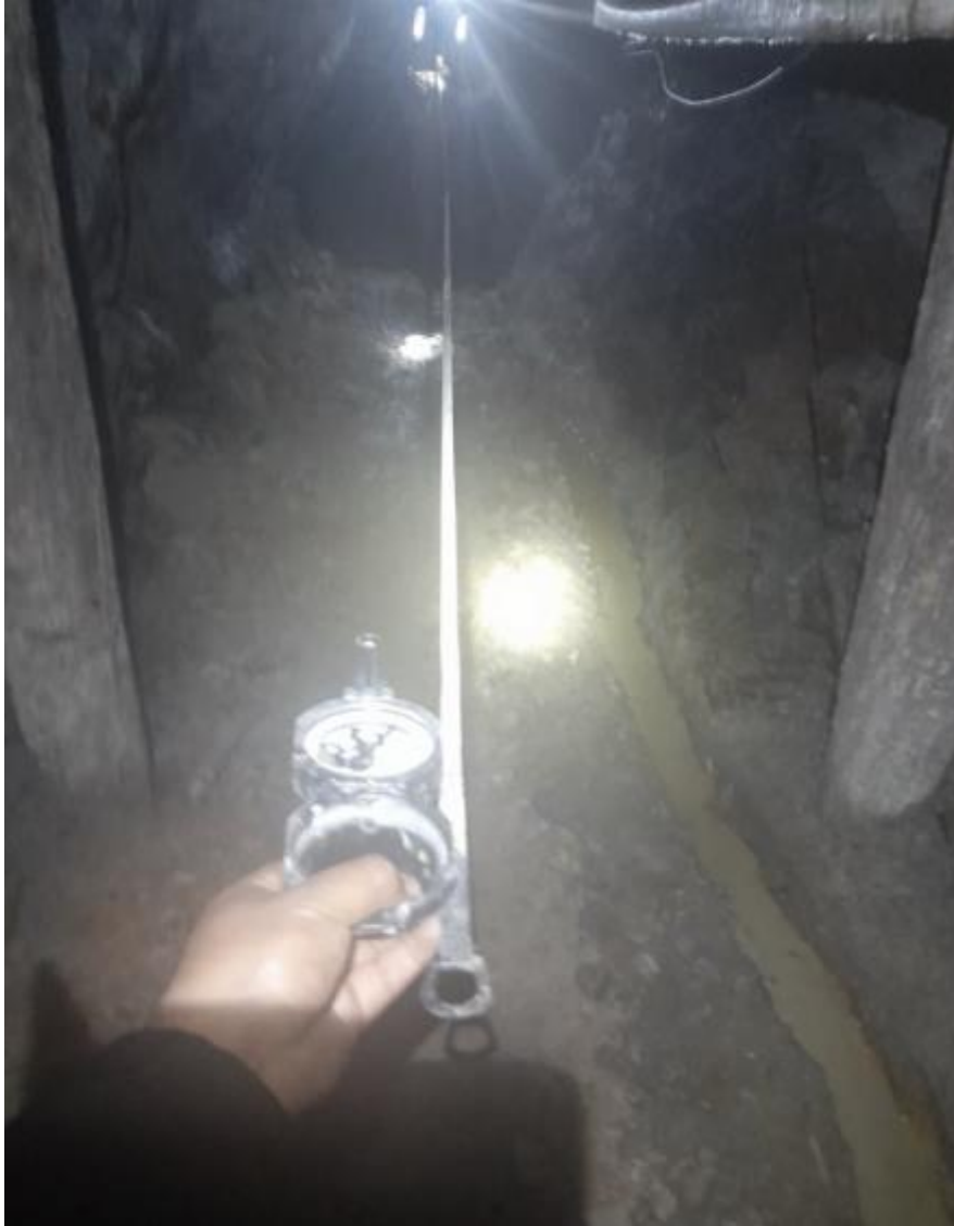
Figura 3 Medición de la orientación del eje de la galería: Azimut 160^{\circ} N.
