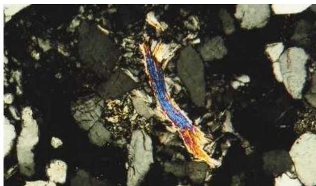
Figura 15. Arenisca cuarzosa, en la que se puede observar una lámina de mica en el centro de la fotografía rodeada de cristales pequeños de relieve débil. Adams et al. (1997)
