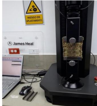
Tensión máxima ( $\text{KN}/\text{mm}^2$ ) en los extremos de la probeta, llegando al valor de: 0.0047, lo que indica que ese valor máximo en un material flexible cuando éste contiene agua en su bioestructura.
