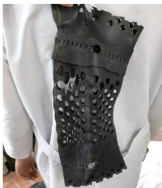
La imagen muestra la deforme de la Geocelda HDPE convencional sin llegar a la rotura, este resultado de ensayo a la tensión y tracción. Este sintético por su naturaleza es de alta densidad, evitando así su degradación física.
