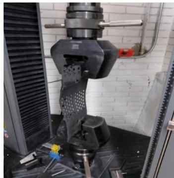
En la imagen se evidencia la tensiometría aplicando una carga constante en KN y midiendo la extensión en milímetros (mm), provocando una deformación constante en los extremos de la Geoceldas HDPE.
