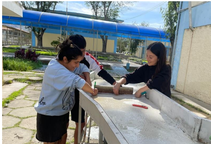
Figura 33. Calibración de modelo de Captación Tres Molinos a Escala reducida 1/25
