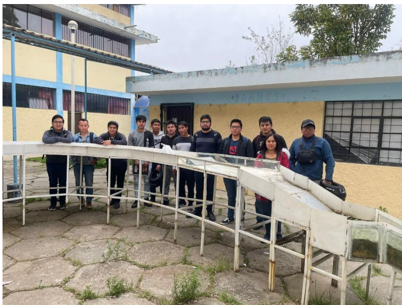
Figura 31. Modelo de Captación Tres Molinos a Escala reducida 1/25
