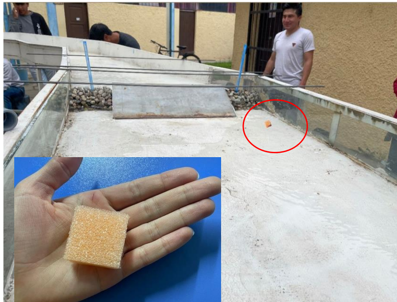
Figura 40.. Aforo por método de flotador con ayuda de pequeña esponja
