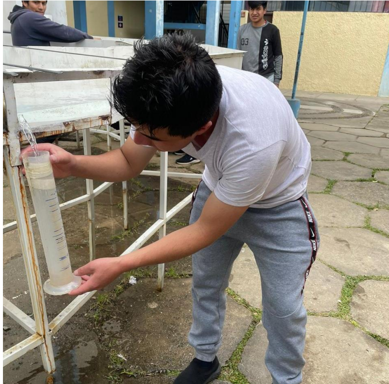
Figura 49. Aforo de bocal de modelo de captación con apertura de barrage al 20%
