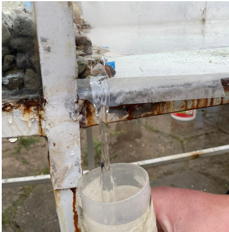
Figura 43. Aforo de bocal de modelo de captación con apertura de barrage al 10%
