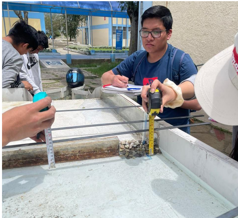
Figura 45. Toma de medidas de tirantes de agua en cada cinta con apertura de barrage al 20%
