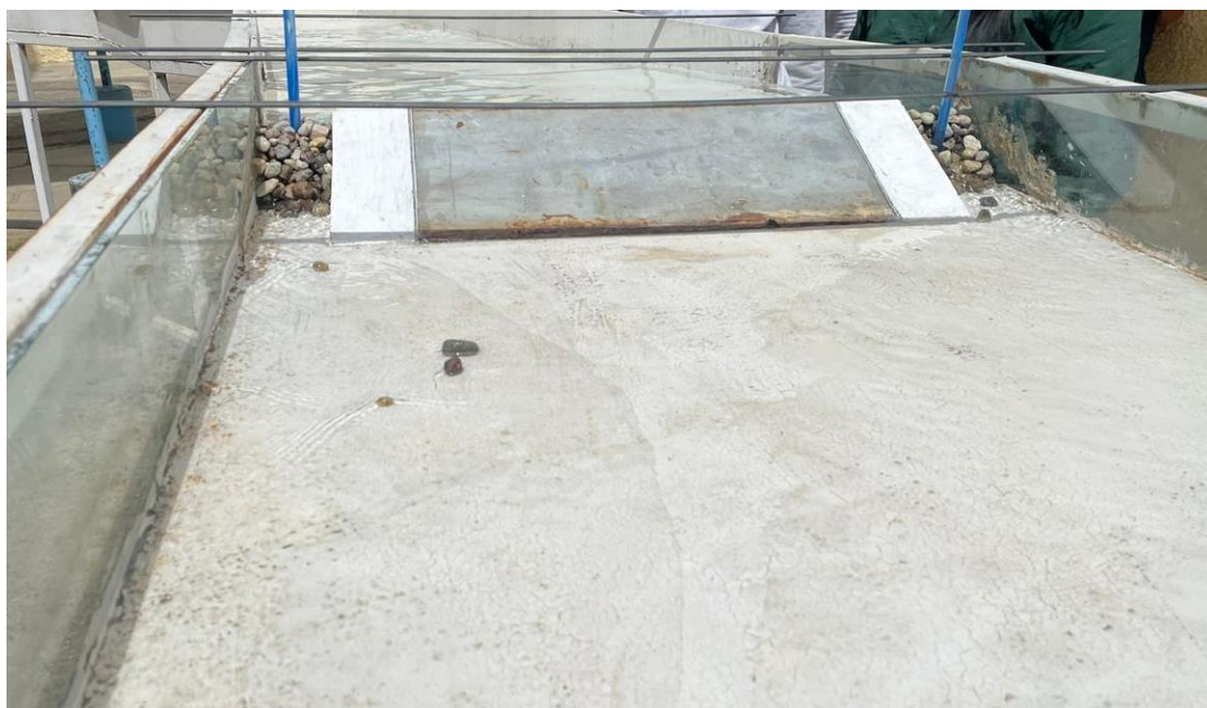
Figura 36. Barrage Fijo con apertura del 10% a cada lado más barrage fusible de enrocado
