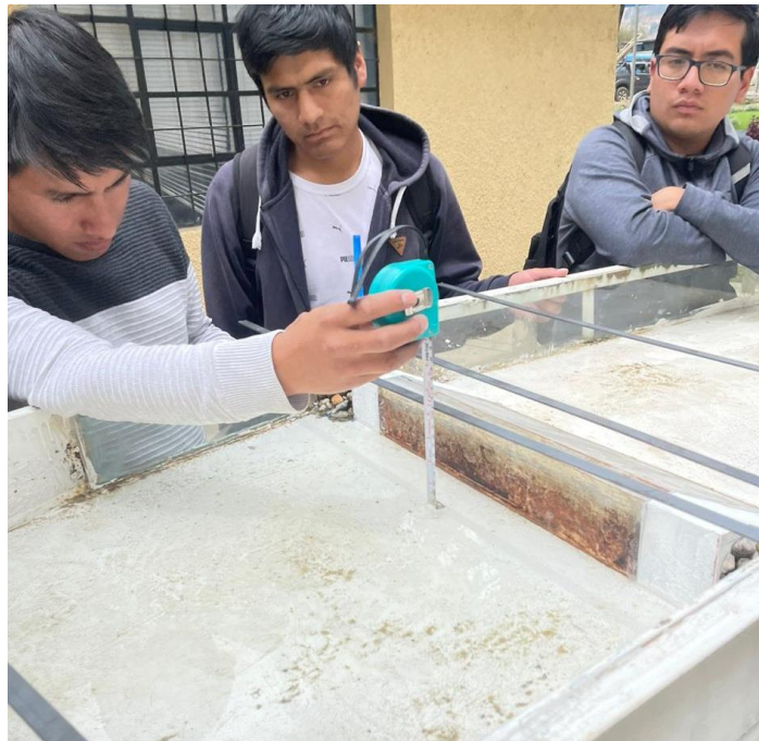
Figura 38. Toma de medidas de tirantes en cada cinta
