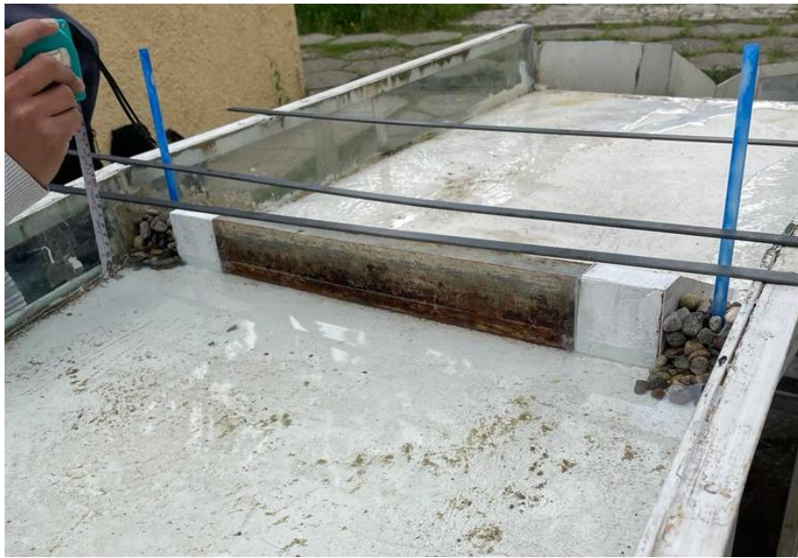
Figura 42 Medición de tirantes de agua en cintas metálicas en modelo de captación
