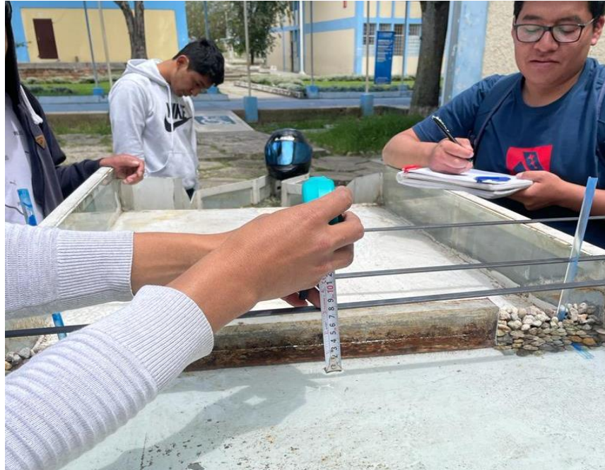
Figura 48. Toma de medidas de tirantes en modelo de captación con apertura de barrage al
