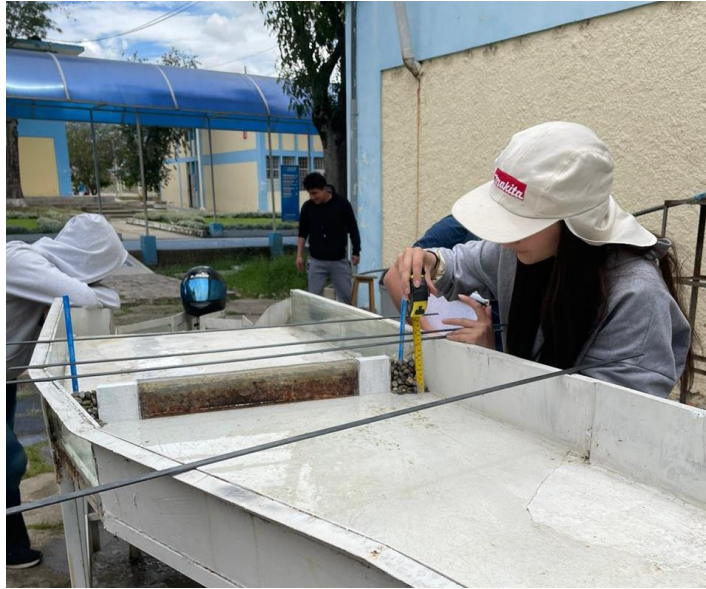
Figura 37. Toma de medidas de tirantes en cada cinta
