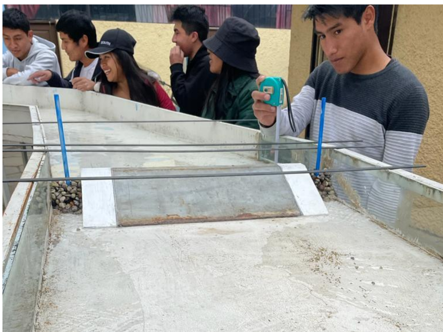
Figura 41. Medición de tirantes de agua en cintas metálicas en modelo de captación.
