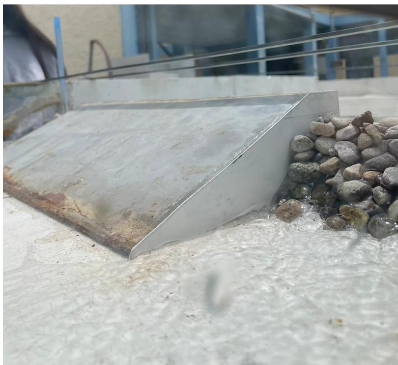
Figura 39. Agua a través de enrocado
