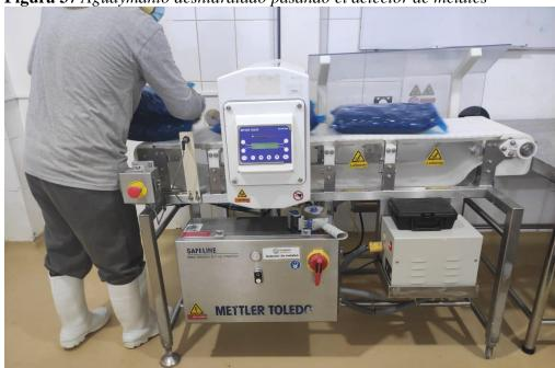
Figura 37 Aguaymanto deshidratado pasando el detector de metales
