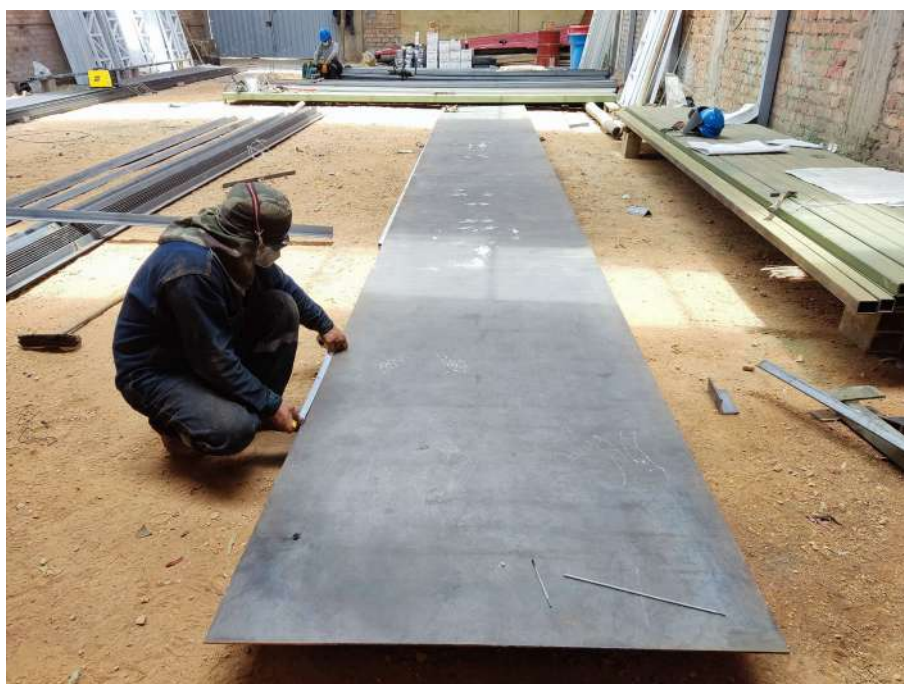
Figura 53. Trazado y armado de la plantilla de tijeral metálico
