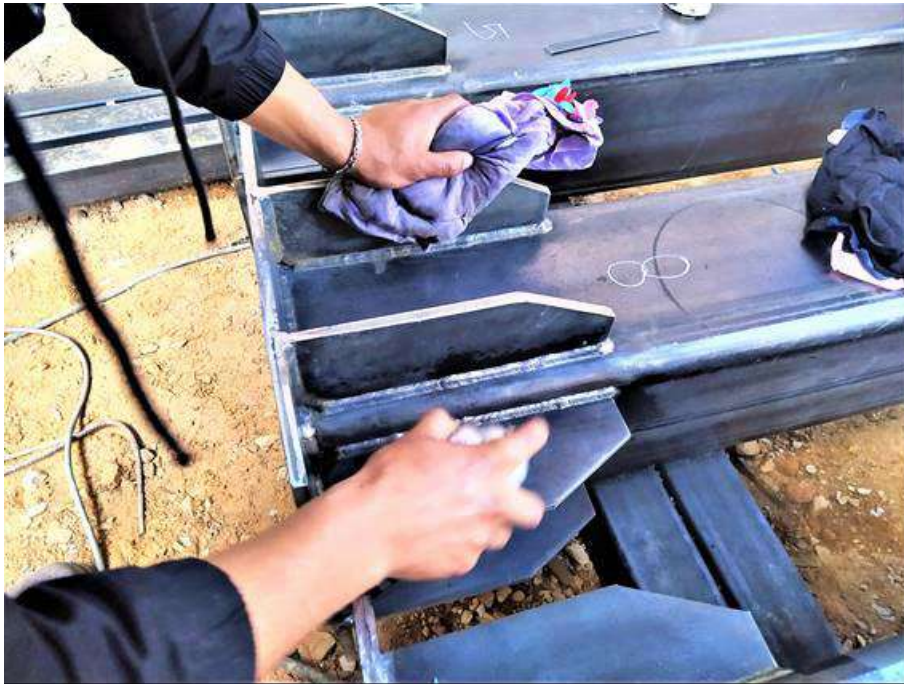
Figura 86. Aplicación de TINTE PENETRANTE - apoyo superior de tijeral
