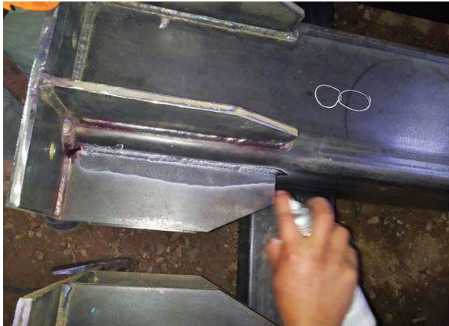
Figura 87. Aplicación de aerosol REVELADOR y resultado
