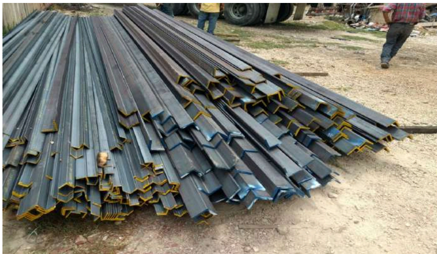
Figura 13. Ángulos estructurales según sus dimensiones.
