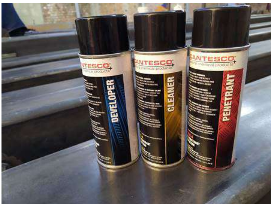
Figura 84. Kit de tintes penetrantes para control de calidad de soldadura.
