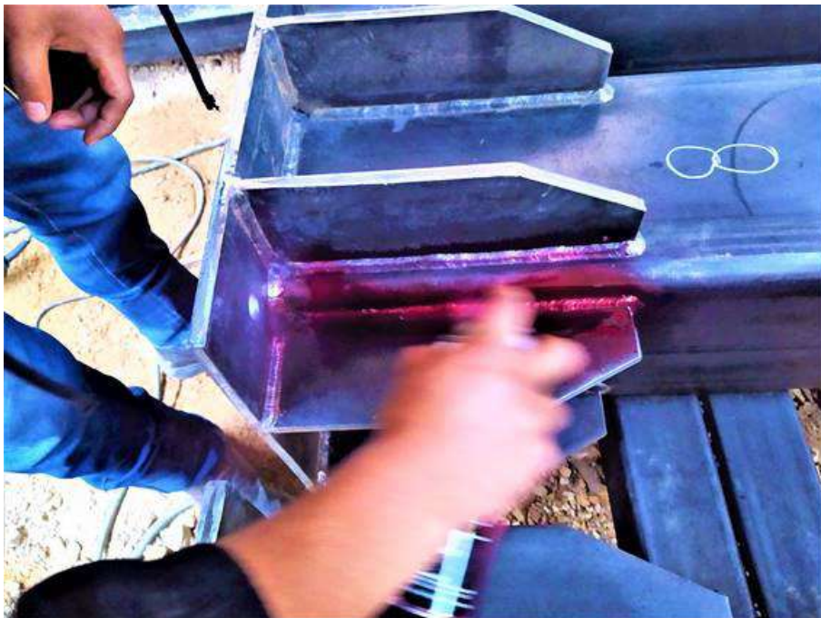
Figura 86. Aplicación de TINTE PENETRANTE - apoyo superior de tijeral
