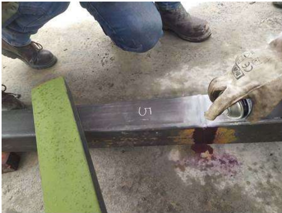
Figura 83. Aplicación del aerosol REVELADOR y resultado.
