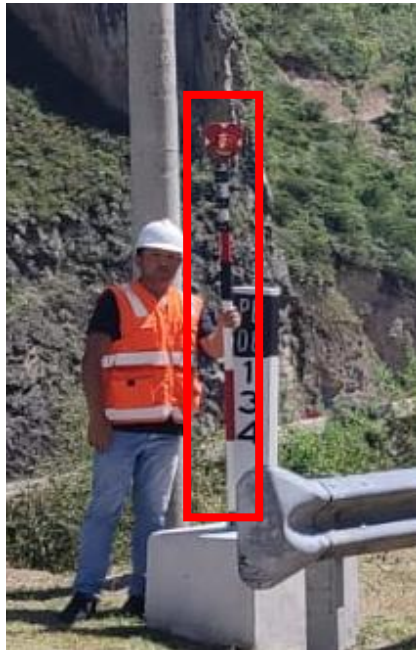
Fotografía 3: Prismas utilizados en el levantamiento topográfico
