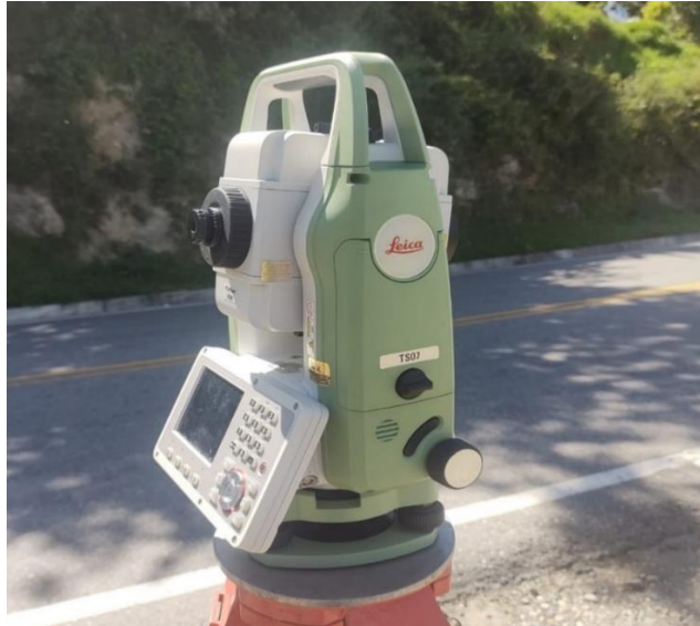
Fotografía 1: Estación Total Leica TS-07
