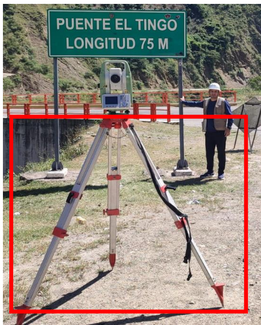
Fotografía 4: Trípode usado durante el levantamiento
