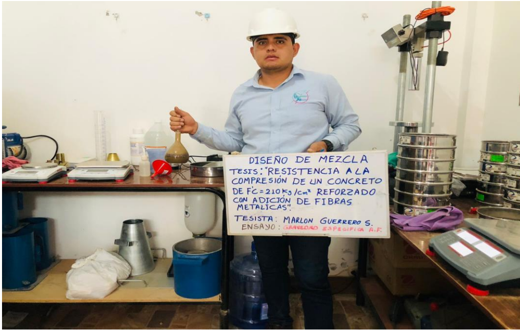
Figura 10. Ensayo de determinación del peso específico del agregado fino
