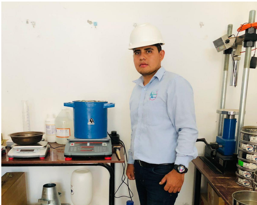
Figura 11. Ensayo de peso unitario suelto seco del agregado grueso
