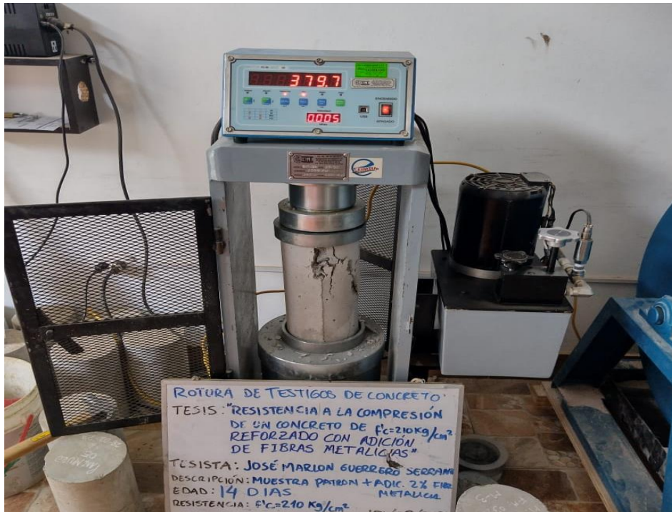
Figura 16. Resultado del ensayo de resistencia a compresión de una probeta de 14 días de curado con adición de fibra metálica al 4%.
