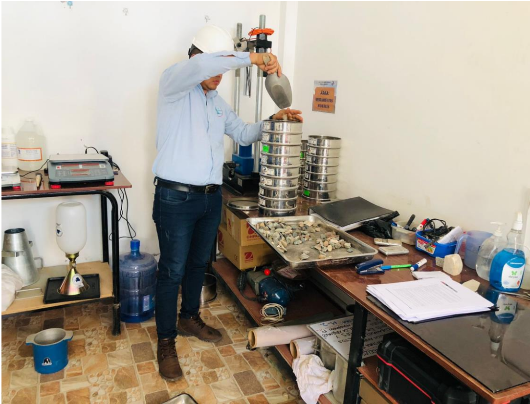
Figura 8. Ensayo de granulometría del agregado grueso.
