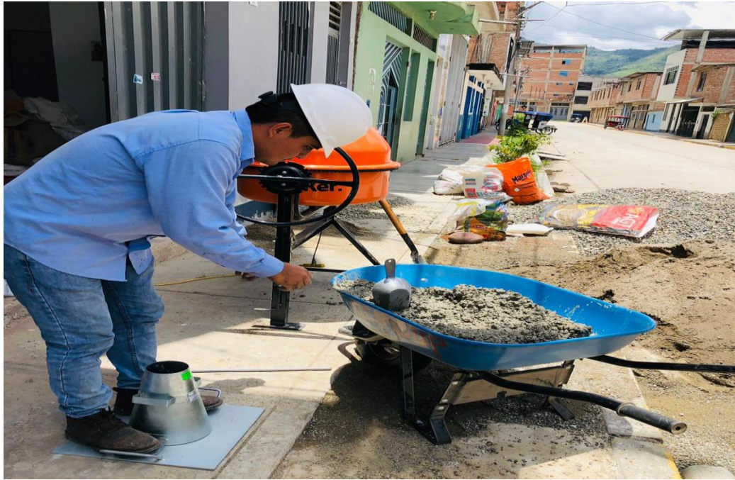
Figura 12. Ensayo para calcular el asentamiento de la mezcla de prueba.
