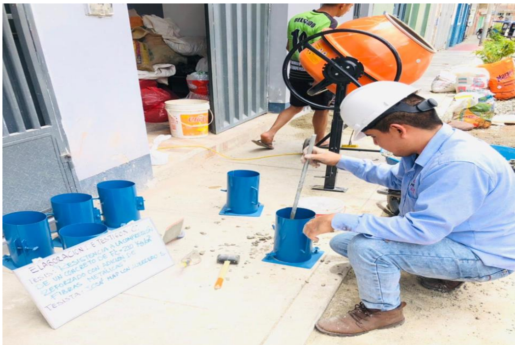
Figura 13. Ensayo de especímenes de concreto para el cálculo de la resistencia a compresión
