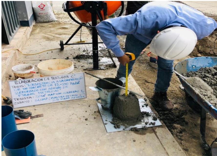
Figura 14. Ensayo para calcular el asentamiento de la mezcla con adición de fibra al 2%
