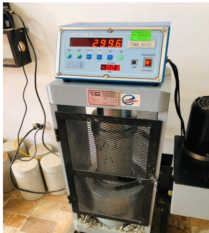
Figura 15. Resultado del ensayo de resistencia a compresión de una probeta de 7 días de curado con adición de fibra metálica al 2%.
