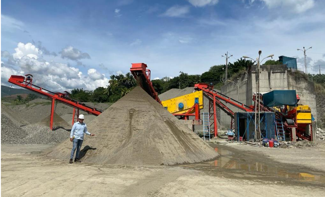
Figura 4. Trituración y método de separación de los agregados en cantera.
