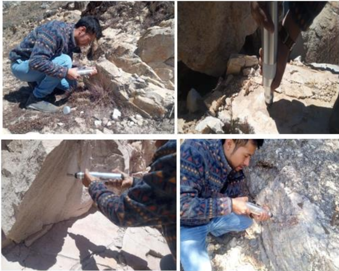
Foto 1: Medición de la Resistencia a la Compresión Uniaxial de la roca con martillo Schmidt tipo L, en diferentes posiciones.
