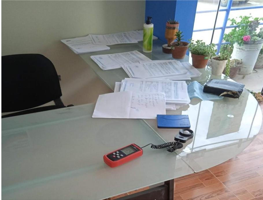
*Figura 23- Medición de la iluminación*
