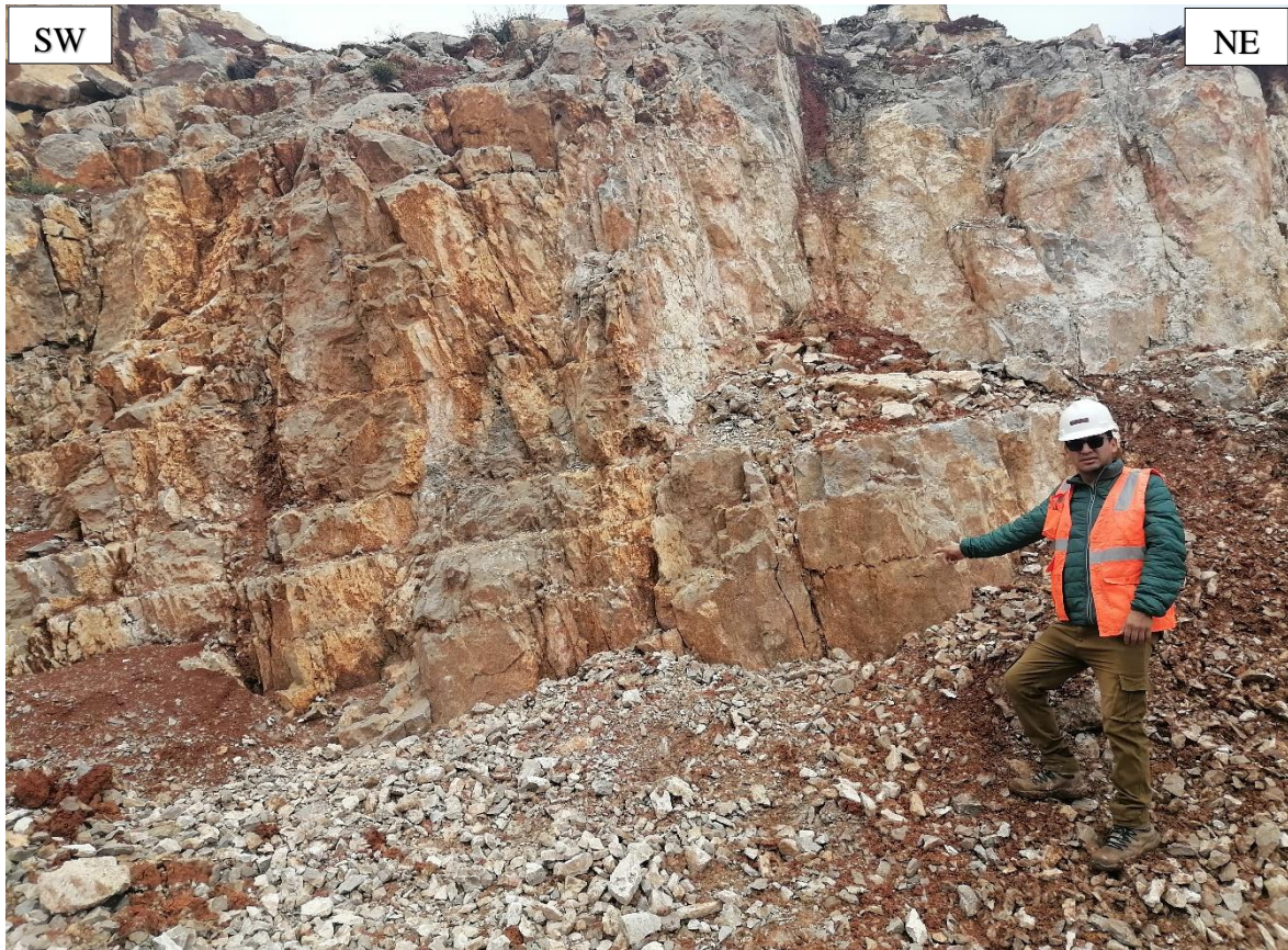
Figura 3.11. Afloramiento calcáreo estratificado subhorizontal de calidad regular, siendo un sector de meteorización: Leve a moderada y fracturamiento medio.
