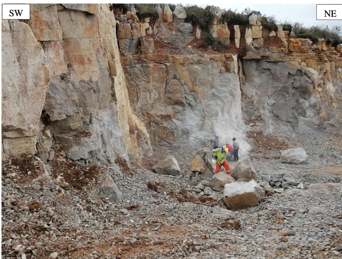
Figura 3.37. Método explotación a tajo abierto utilizado por la Minera Nueva Unión E.I.R.L., siendo actualmente un solo banco de explotación de altura de 15 m.
