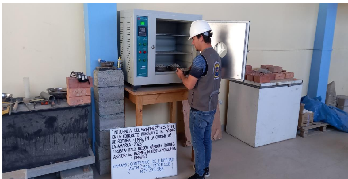
Figura 20: Ensayo de contenido de humedad, colocación de la muestra a la estufa.
