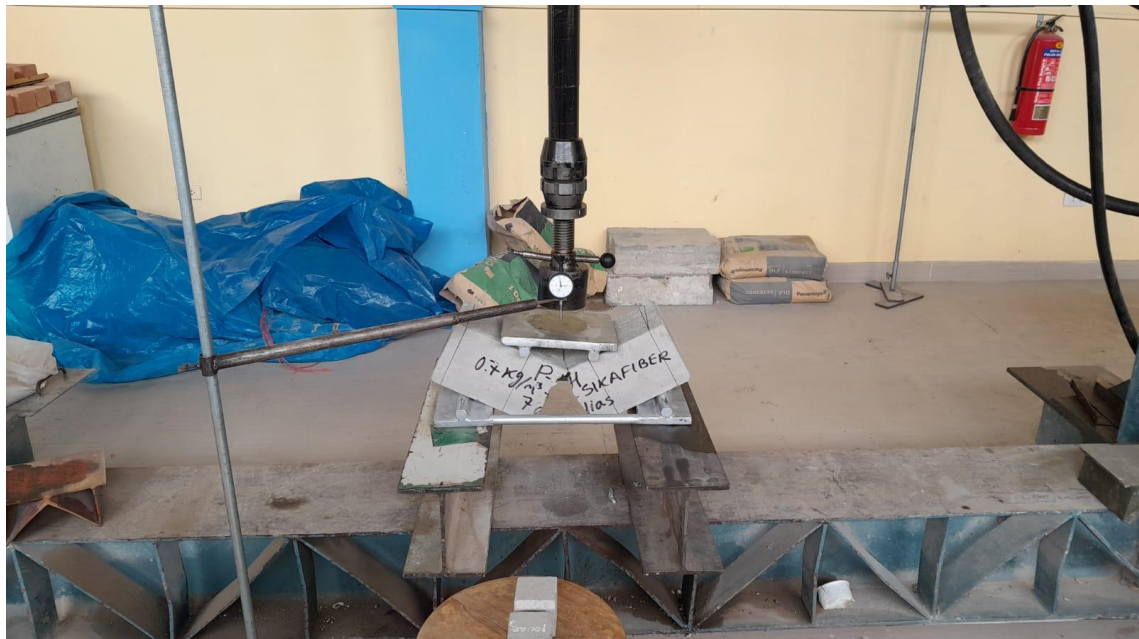
Figura 34: Rotura de probetas con tipo de falla central
