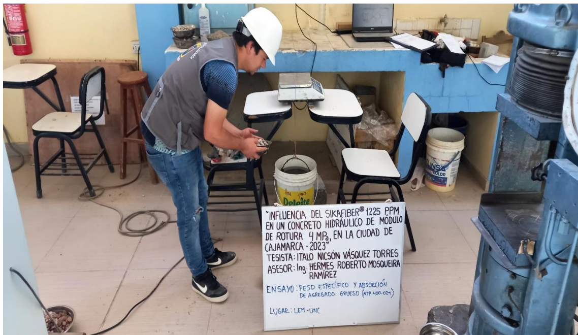
Figura 22: Ensayo de pesos específicos y absorción de los agregados.
