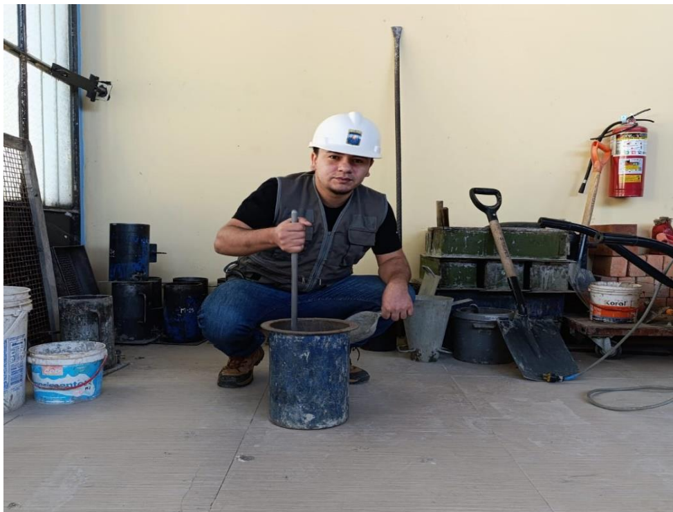
Figura 24: Ensayo de peso unitario de agregado grueso.
