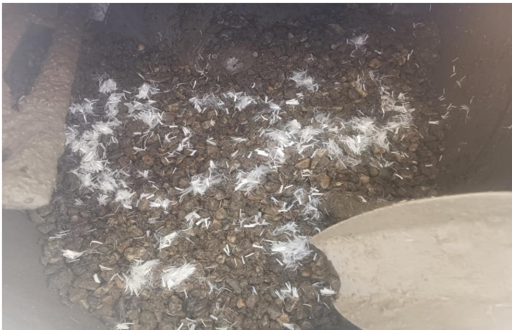
Figura 26: Mezcla del agregado con la fibra SikaFiber®1225 PPM
