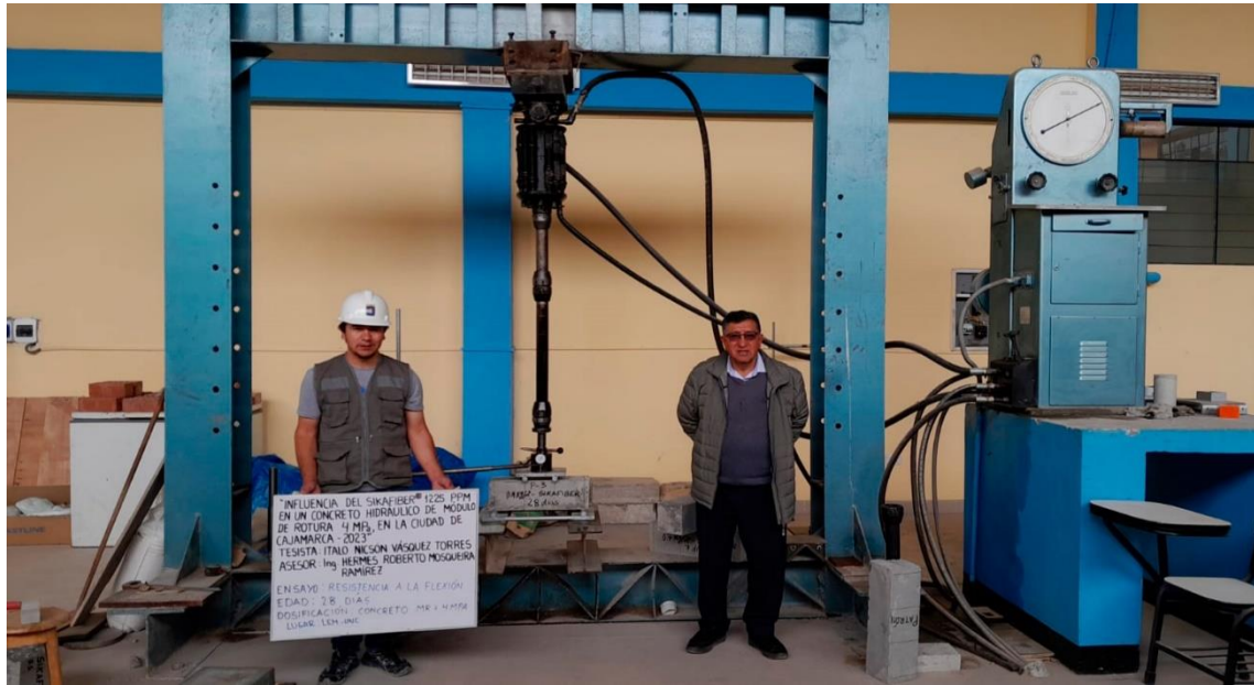
Figura 35: Rotura de probetas a los 28 días
