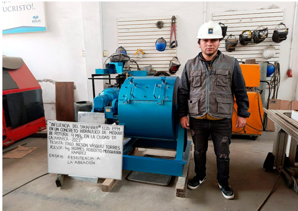
Figura 25: Ensayo de resistencia a la abrasión
