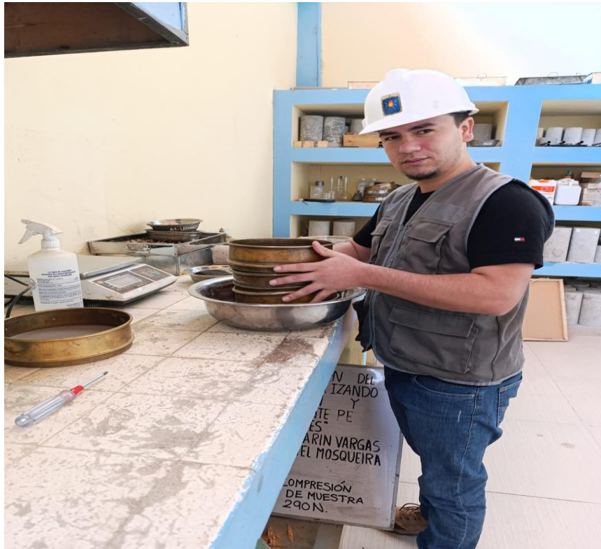
Figura 22: Ensayo de pesos específicos y absorción de los agregados.
