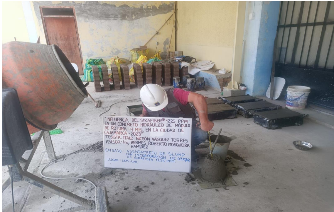
Figura 29: Ensayo de asentamiento del concreto.
