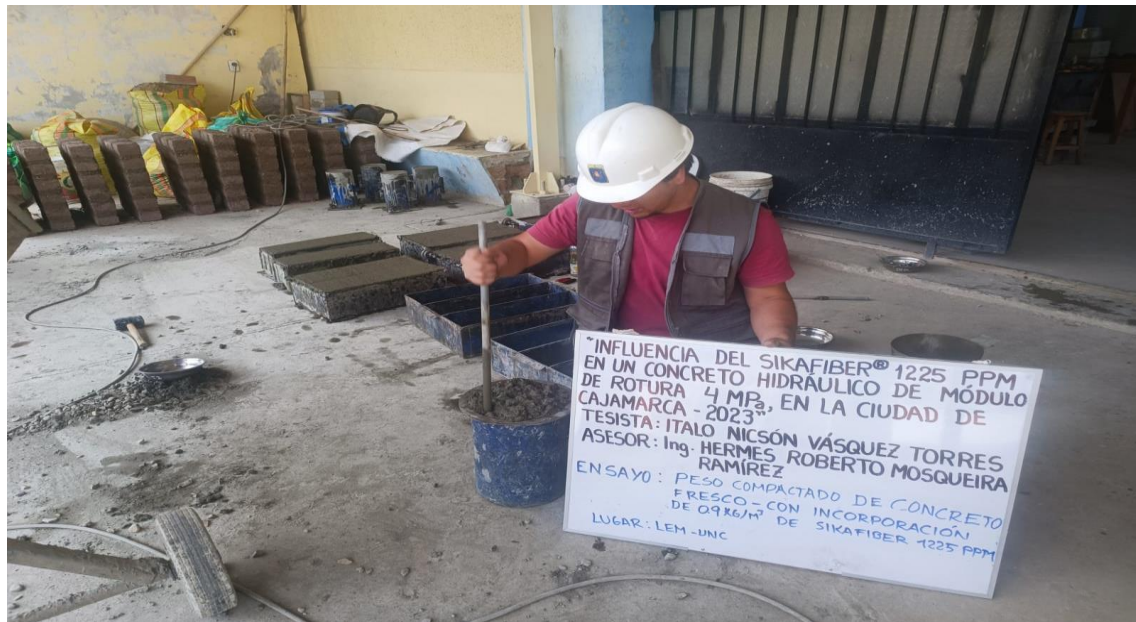
Figura 28: Ensayo de peso unitario fresco del concreto
