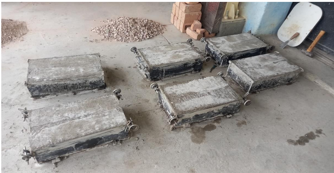
Figura 30: Desencofrado de probetas prismáticas
