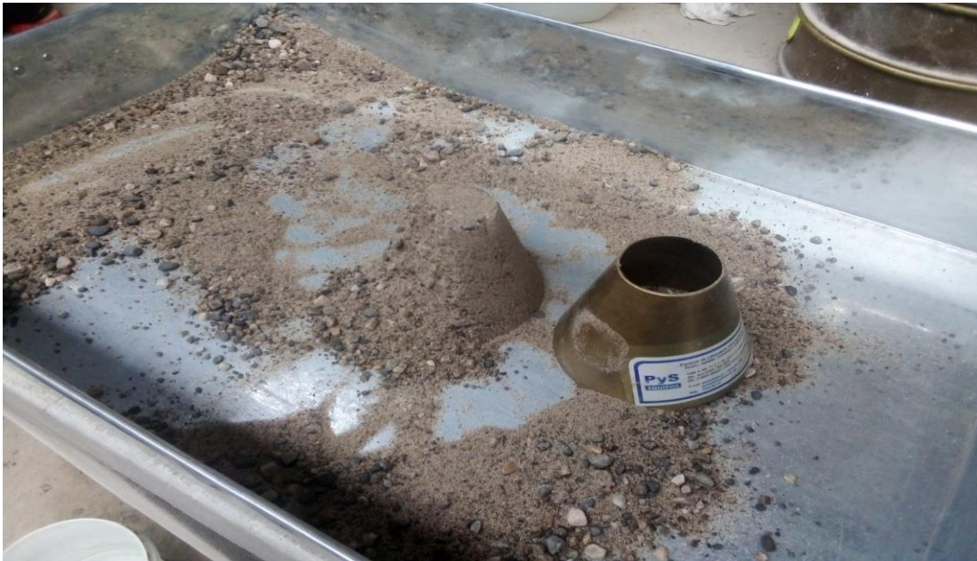
Figura 23: Ensayo de peso específico de agregado fino
