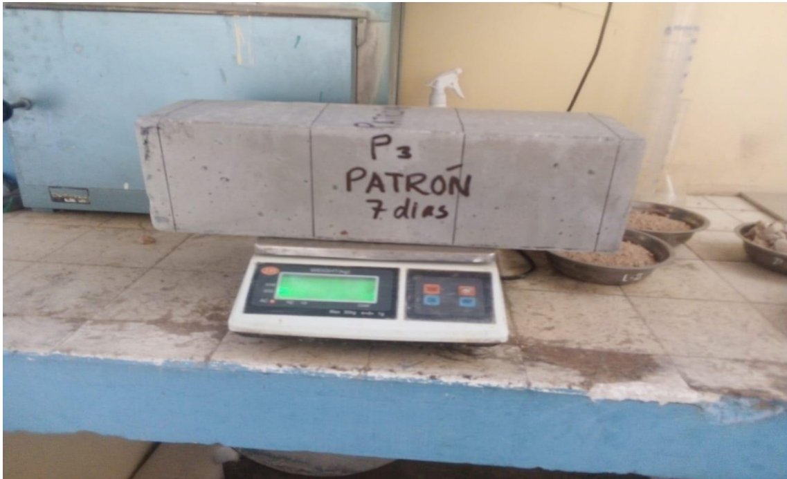
Figura 31: Registro de dimensiones y pesos del concreto endurecido
