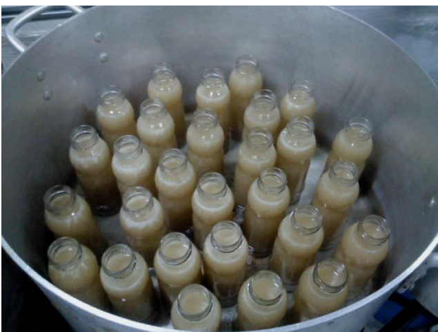
Foto 9: Envasado y evacuado del néctar de chalarina- Proceso de elaboración del néctar de chalarina.
