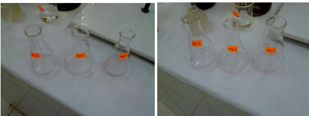
Foto 18: Evaluación de Muestra Ambiente 1, en titulación de muestra y blancos - Evaluación de muestras en laboratorio para la determinación del ácido ascórbico.
