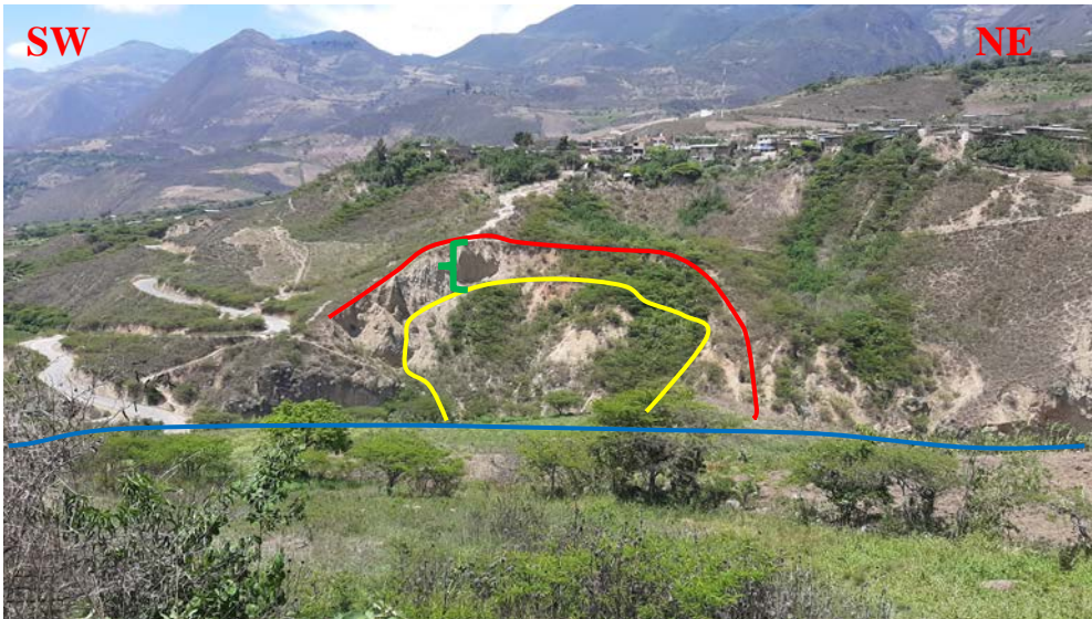
Anexo N° 5. Deslizamiento Rotacional, identificad en la Estación N° 06, el cual se a producido por la corriente del Río Magdalena (Azul), en él se evidencia claramente el escarpe de deslizamiento (Verde).
