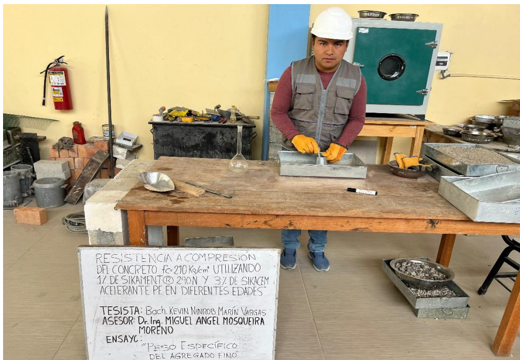
Ensayo de peso específico de agregado fino
